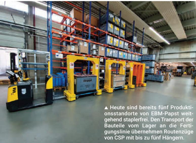
▲ Heute sind bereits fünf Produktionsstandorte von EBM-Papst weitgehend staplerfrei. Den Transport der Bauteile vom Lager an die Fertigungslinie übernehmen Routenzüge von CSP mit bis zu fünf Hängern.
