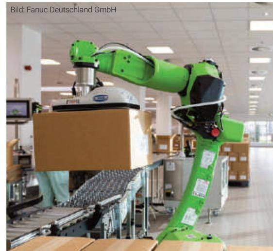
▲ Vier Lagen werden auf einer Palette gestapelt. Mit einer Reichweite von 1.441mm für den Roboter kein Problem.
