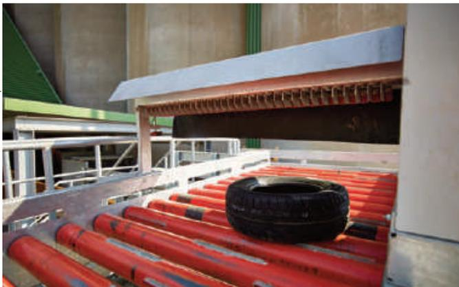
▲ Ausgestattet ist die Anlage mit umfangreichen Kontrolleinrichtungen. Dazu gehören auch Scanner, die prüfen, ob Reifen übereinanderliegen oder sich noch die Felge darin befindet.
