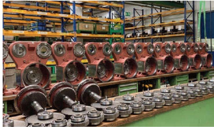
▲ Fertigteile zur Produktion von Getrieben für Straßenfräsen.
