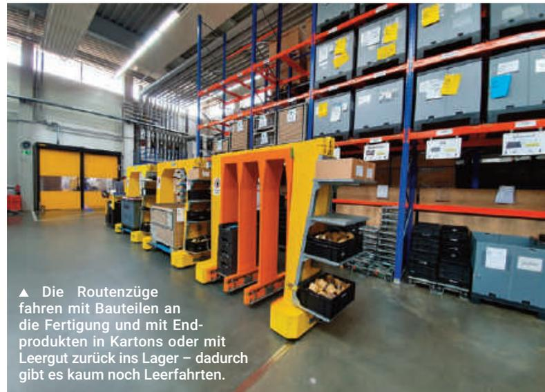
▲ Die Routenzüge fahren mit Bauteilen an die Fertigung und mit Endprodukten in Kartons oder mit Leergut zurück ins Lager – dadurch gibt es kaum noch Leerfahrten.
