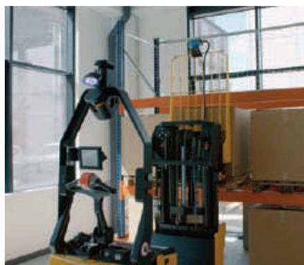
▲ Der fahrerlose Gabelhochhubwagen MC1015 kann mit Paletten interagieren und in der Höhe darauf zugreifen, z.B. an Förderbändern oder an Regalen mit zweiter oder dritter Ebene.
