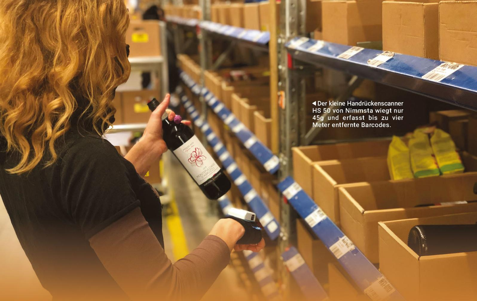
◀ Der kleine Handrückenscanner HS 50 von Nimmsta wiegt nur 45g und erfasst bis zu vier Meter entfernte Barcodes.
