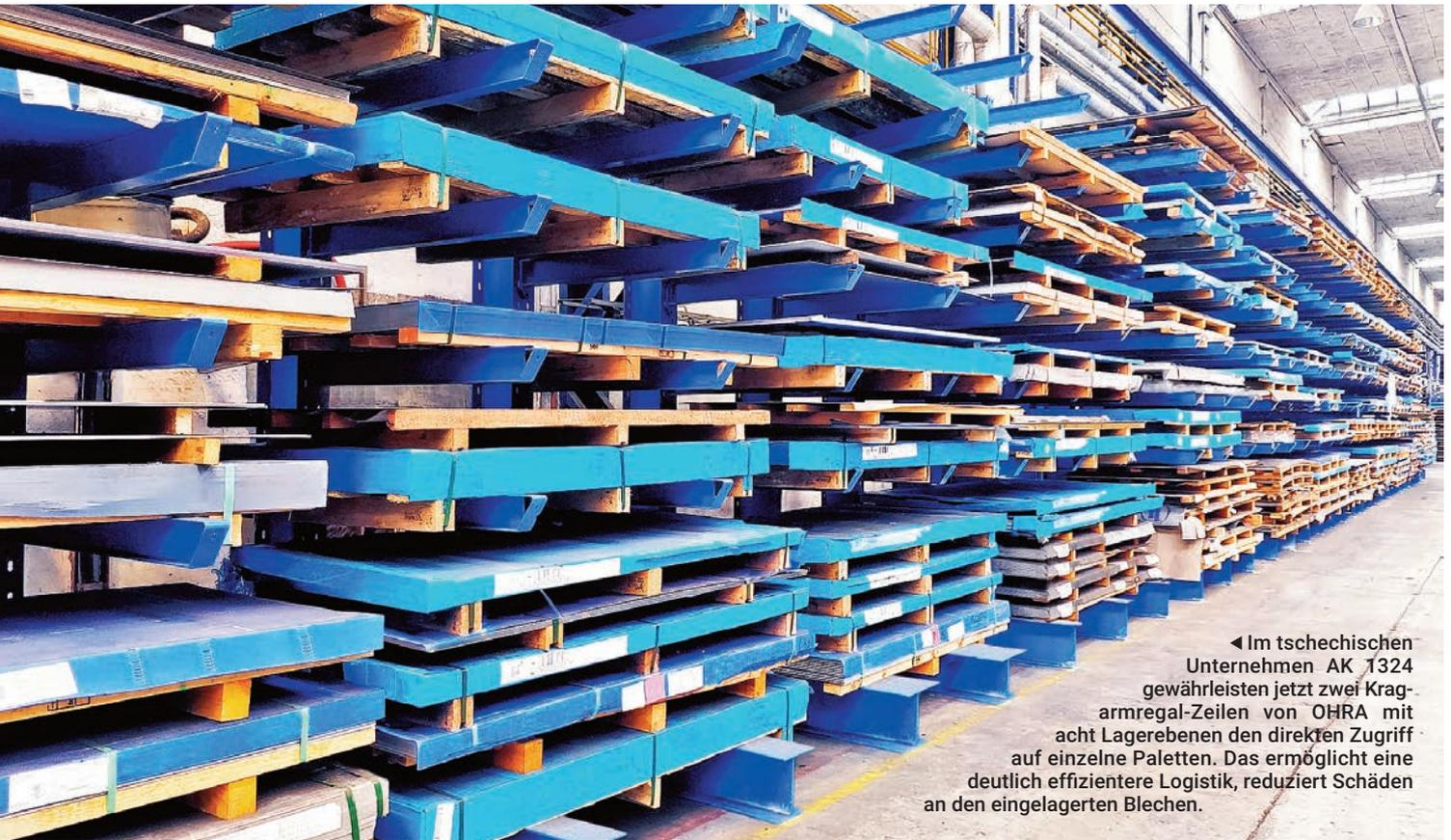
◀ Im tschechischen Unternehmen AK 1324 gewährleisten jetzt zwei Kragarmregal-Zeilen von OHRA mit acht Lagerebenen den direkten Zugriff auf einzelne Paletten. Das ermöglicht eine deutlich effizientere Logistik, reduziert Schäden an den eingelagerten Blechen.
