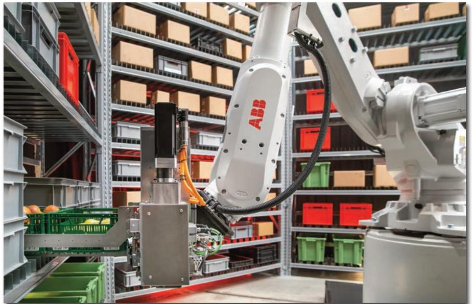
▲ Der FlexBuffer ist eine modulare und anpassbare Zelle für die Lagerung, Pufferung und Sequenzierung verschiedenster Artikel und ermöglicht eine effiziente Handhabung von kleineren Losgrößen, gemischten Paletten und individuellen Kundenbestellungen.
