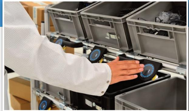
▲ Sensorhersteller Captron hat mit oneGRID ein integriertes Pick-by-Light-System entwickelt, um die Effizienz in der Intra-logistik zu steigern.
