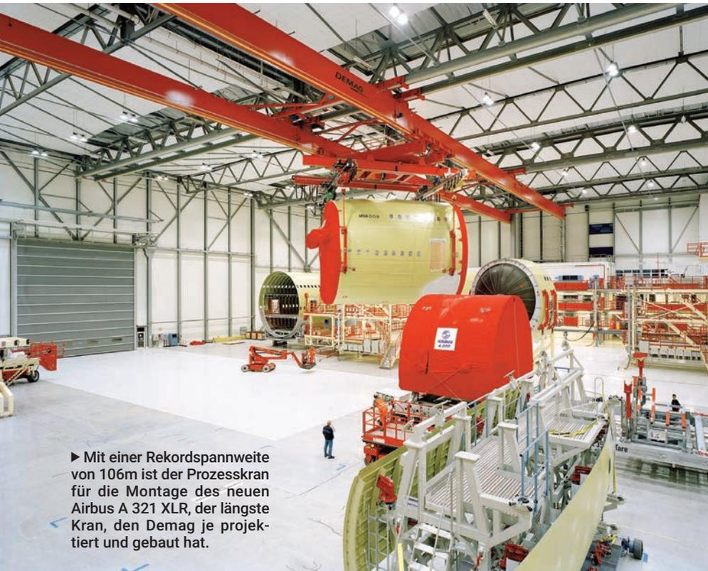
► Mit einer Rekordspannweite von 106m ist der Prozesskran für die Montage des neuen Airbus A 321 XLR, der längste Kran, den Demag je projektiert und gebaut hat.
