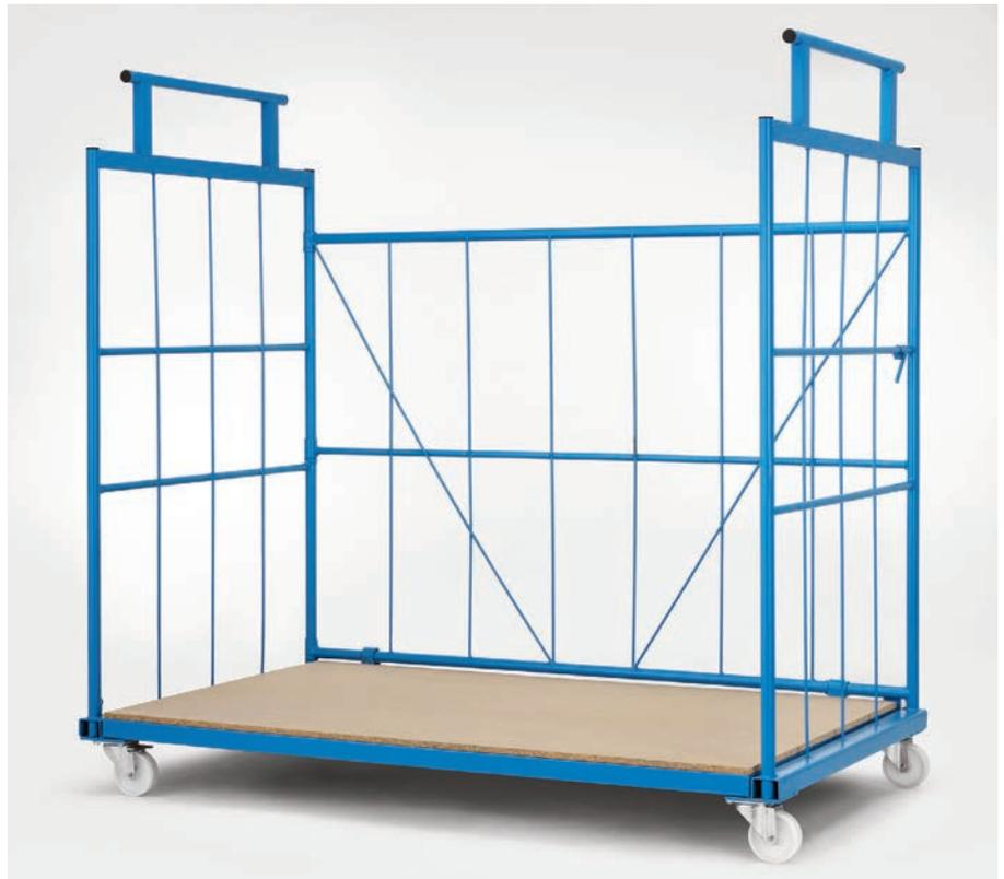
matistische Verriegelung und Einhand-Entriegelung der Bodenplatte, vier Lenkrollen aus Kunststoff mit 125mm Durchmesser, die eine Traglast von 800kg erlauben. Ein Rad lässt sich mittels eines Richtungs-
