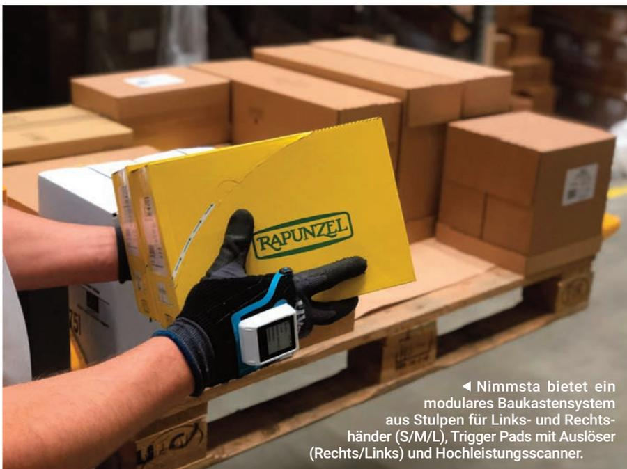
◀ Nimmsta bietet ein modulares Baukastensystem aus Stulpen für Links- und Rechtshänder (S/M/L), Trigger Pads mit Auslöser (Rechts/Links) und Hochleistungsscanner.
