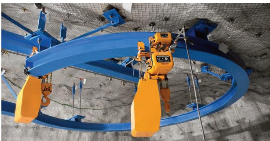
▲ Die einzigartige Kito Lastkette (stromlos vernickelt) wird unter Tage sicher im Kettenbehälter aus Stahl platziert.
