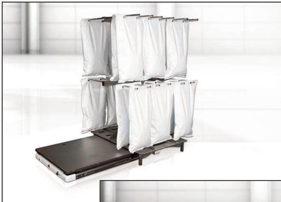
▲ Mit dem ek-Hybrid-Navigationssystem navigiert der Fast Move HUB 30 über die Konturen seiner Umgebung. Da, wo dies nicht möglich ist, erreicht er mit Personenschutzscannern und Reflektoren seine Ziele mit höchster Präzision.
