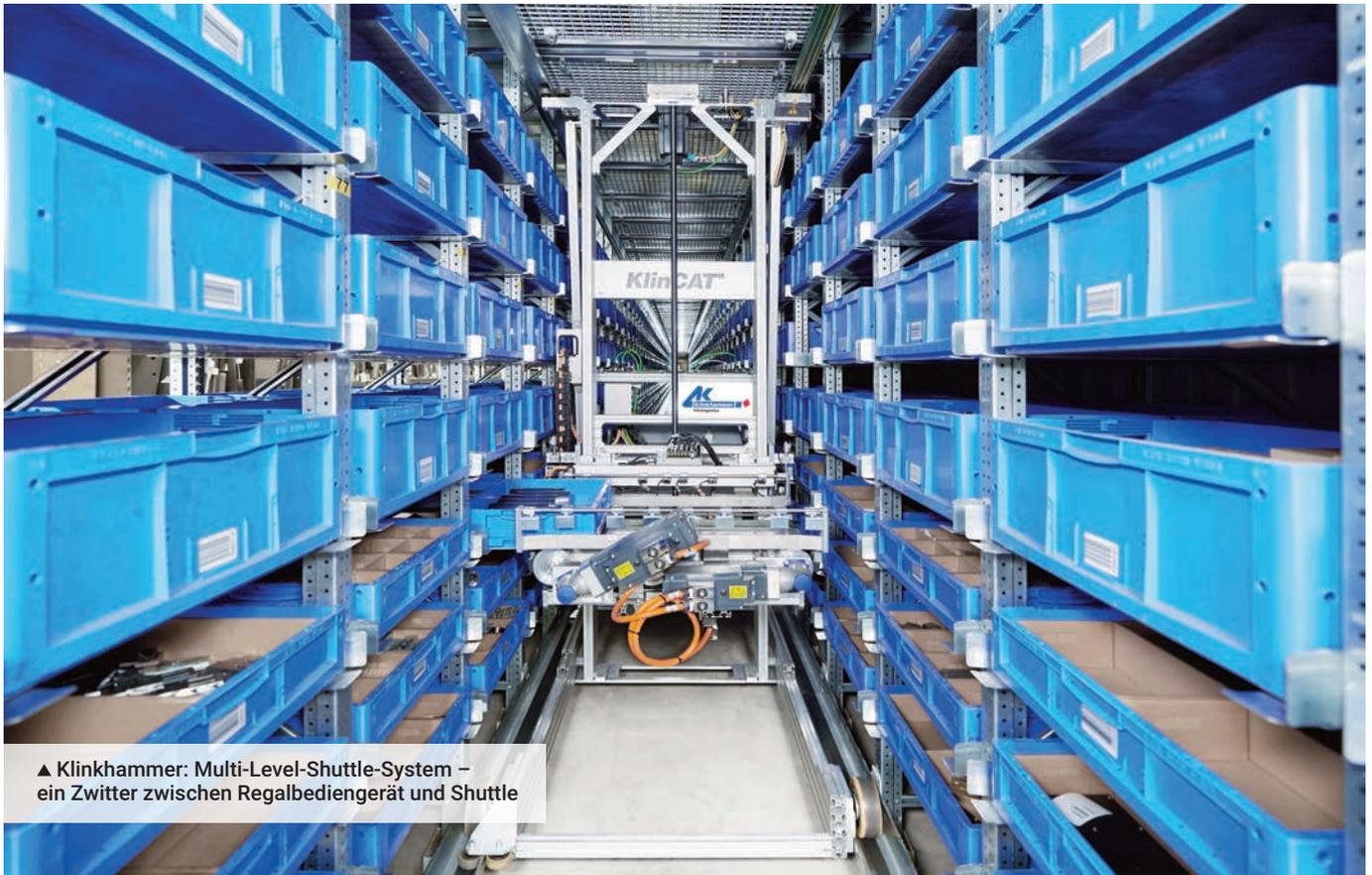
▲ Klinkhammer: Multi-Level-Shuttle-System – ein Zwitter zwischen Regalbediengerät und Shuttle
