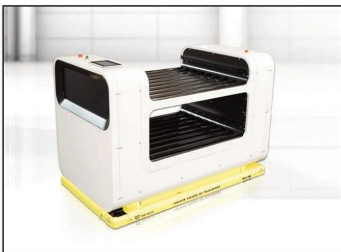
▲ Einer der ek-robotics-Kunden aus der Kunststoffherstellung setzt auf Unterstützung des Fast Moves: Acht Förderer werden individuell angesteuert und sind in der Lage, einzelne KLTs präzise und in der richtigen Reihenfolge an ihr Ziel zu bringen.
