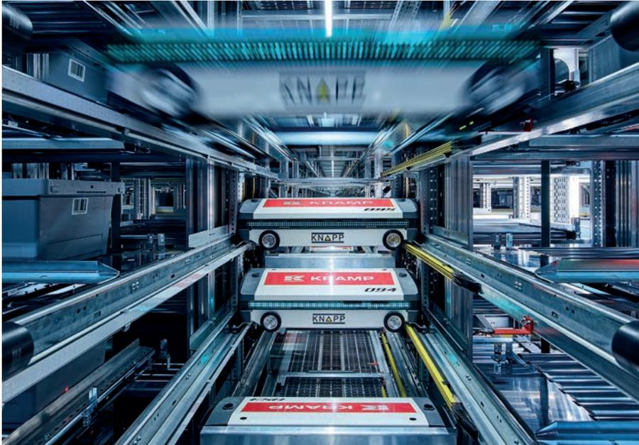
◀ Intelligent gelagert: Langsam-, Mittel- und Schnelldreher sowie Übervorrat sind im OSR Shuttle Evo eingelagert. Die schnellen Shuttles können die Gassen wechseln und versorgen jeden Arbeitsplatz just-in-time mit Ware.
