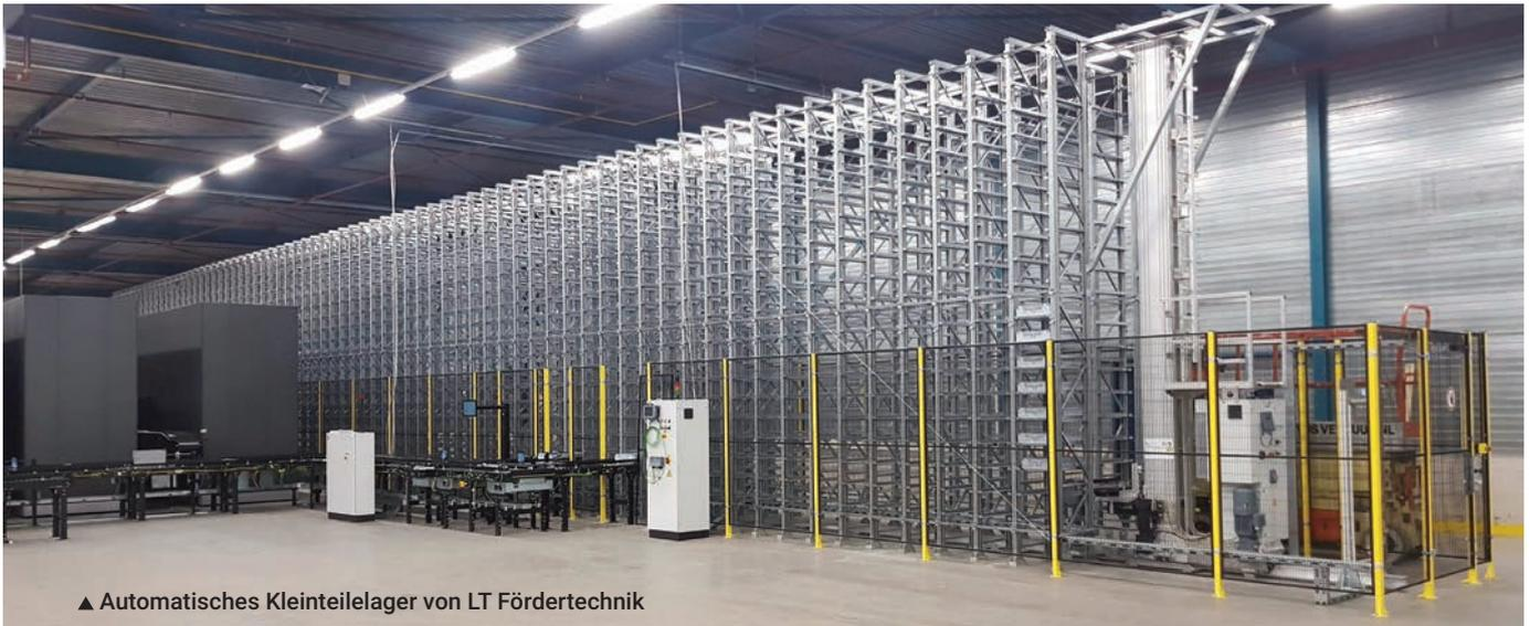
▲ Automatisches Kleinteilelager von LT Fördertechnik
