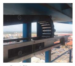
terkonsolen konnten die ursprünglichen Bohrungsabstände für die Montage des neuen Energieführungssystem genutzt werden. Mitnehmerarme mit schwimmenden Mitnehmern (Floating Moving Device) kompensieren im Betrieb unerwünschte Bewegungen der Energieführung und garantieren damit eine optimale Übergabe der Leitung. www.kabelschlepp.de
