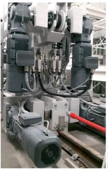
▲ Bei diesen RBGs sind alle wichtigen Komponenten wie Antrieb, Frequenzumrichter und Energiezufuhr in doppelter Ausführung vorhanden. Die Redundanz garantiert eine sehr hohe Verfügbarkeit der Anlage und verringert die Gefahr eines Produktionsstillstandes.
