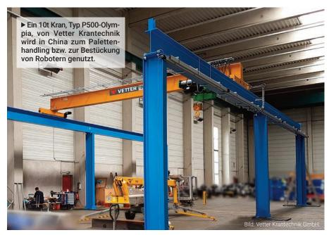
Kürzlich lieferte das Siegerländer Unternehmen Vetter Krantechnik einen technisch sehr anspruchsvollen Portalkran nach China. Der 10t Kran vom Typ P500-Olympia wird dort zum Palettenhandling bzw. zur Bestückung von Robotern genutzt. Dabei dürfen die Bereiche, in dem diese Roboter stehen, teilweise gar nicht und teils nur unter bestimmten Vo-
