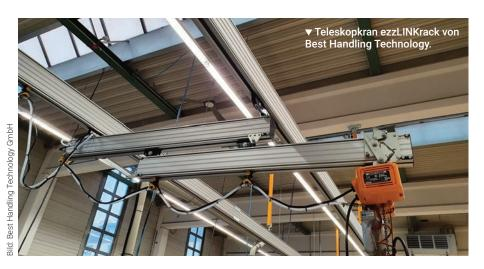
Teleskopkrananlagen und -Schwenkkrane ermöglichen den Zugang zu Arbeitsbereichen, die mit konventionellen Kränen nicht erreicht werden können. Diese Krantechnik lohnt sich, denn gegenüber der Verwendung von Standardkranen werden Arbeitsfluss und Produktivität deutlich verbessert.
