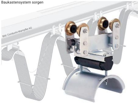
▲ Die kompakten I-Träger Leitungswagen für Rund- oder Flachleitungen des Programms 0320 aus feuerverzinktem Stahl sind ausgelegt für mittlere Geschwindigkeiten und Leitungsgewichte.
