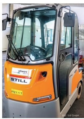
▲ Die Analysen für das Still-Routenzugsystem resultierten in einem LTX 70-Schlepper, kombiniert mit zwei wendigen C-Rahmen-Anhängern. Für den wetterfesten Transport sind die Anhänger mit einem Verdeck und das Zugfahrzeug mit einer Vollkabine ausgerüstet.
