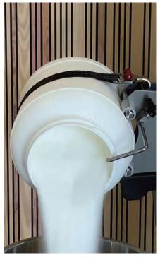
▲ Der Gurtträger mit manueller Kippeinheit ermöglicht das ergonomische Heben, Tragen und Kippen von Eimern und kleinen Fässern.
