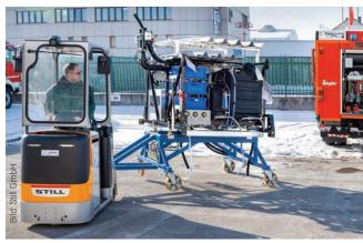
▲ Mit der hydraulischen Aufnahmevorrichtung des Still-Kanvan-Zugfahrzeugs lässt sich die erste Achse freiheben. So wird aus einem zweiachsigen Anhänger ein einachsiger mit wesentlich kleinerem Wendekreis.
