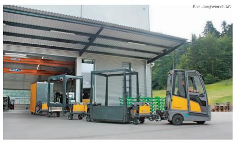
▲ Industry Train Routenzug Baureihe IT800 mit outdoorfähigen Fahrwerksmodulen und unterschiedlichen Warenträger-Systemen. Das Zugfahrzeug ist ein Jungheinrich Elektro-Schlepper EZS 570.
