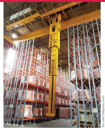
Vollert Anlagenbau: Automatikkran bei MKM
