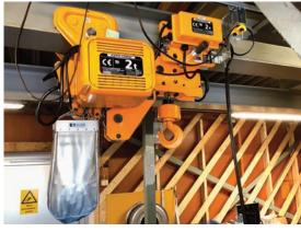
▲ (oben) Das komprimierte Design des Kito SHER2M ist durch die spezielle Kettenführung möglich - jeder Zentimeter wird genutzt, um die Last bis unter den Träger zu fahren.
