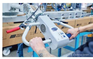
▲ Der Drehgriff des JumboErgo ist einem Motorrad-Gasgriff nachempfunden. Mit dem beweglichen Bedienbügel werden große Stapelhöhen problemlos überwunden.
