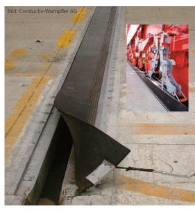
▲ Der Leitungsschacht wird durch das Trench-Guard-System von Conductix-Wampfler vor mechanische Belastungen sowie vor Umweltbedingungen, Rieselgut oder anderen Materialien und Gegenständen, die in den Kanal gelangen könnten, geschützt.
