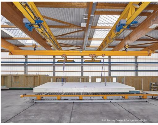
▲ Hohe Sicherheitsstandards für das Handling der Holzprodukte mit einer 10m langen Stahl-Traverse.
