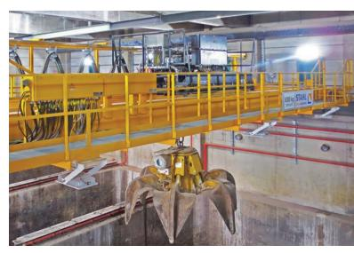
🛦 Der Zweiträgerbrückenkran mit einer Tragfähigkeit von 6,3t und einer Spannweite von 14m ist für den Greiferbetrieb ausgelegt und besitzt Laufstege entlang der Kranbrücke, einschließlich komplett begehbarer Zweischienenlaufkatze.
