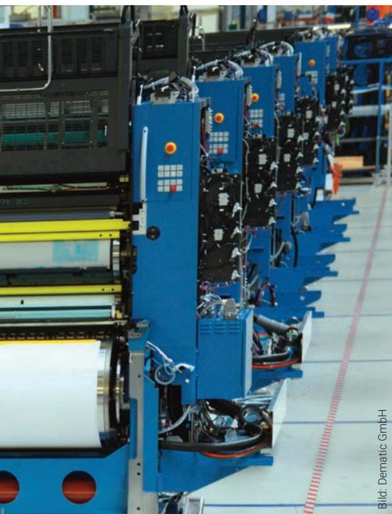
◀ Je nach Arbeitsfortschritt bringt das interne Transportsystem Etow die Druckwerke in der Produktionshalle automatisch an die zwölf in Reihe angeordneten, miteinander verknüpften Arbeitsstationen.
