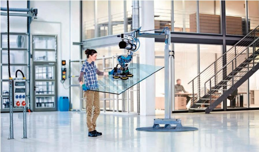
▲ Das ergonomische Positioniersystem BalanceLift ermöglicht es einer einzigen Person, ohne direkten Kontakt zu den Mitarbeitern große und schwere Objekte innerhalb definierter Aktionsfelder zu bewegen.
