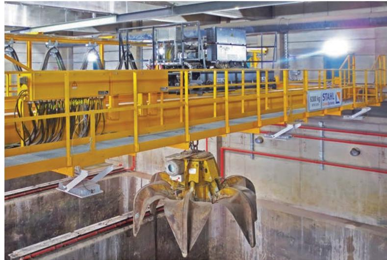
▲ Der Zweiträgerbrückenkrane mit einer Tragfähigkeit von 6,3t und einer Spannweite von 14m ist für den Greiferbetrieb ausgelegt und besitzt Laufstege entlang der Kranbrücke, einschließlich komplett begehbare Zweischieneaufkatze.
