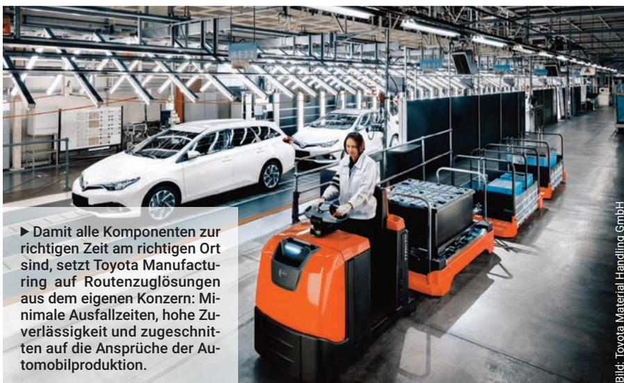
► Damit alle Komponenten zur richtigen Zeit am richtigen Ort sind, setzt Toyota Manufacturing auf Routenzuglösungen aus dem eigenen Konzern: Minimale Ausfallzeiten, hohe Zuverlässigkeit und zugeschnitten auf die Ansprüche der Automobilproduktion.
