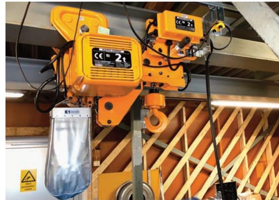
▲ (oben) Das komprimierte Design des Kito SHER2M ist durch die spezielle Kettenführung möglich – jeder Zentimeter wird genutzt, um die Last bis unter den Träger zu fahren.
