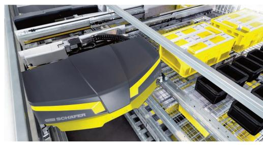
▲ Das skalierbare Einebenen-Shuttle SSI Flexi ist ideal für den Einsatz im hochdynamischen automatischen Kleinteilelager bei einer hohen Varianz an Transporteinheiten bis zu 50kg und dynamisch anpassbaren Stellplatzgrößen.
