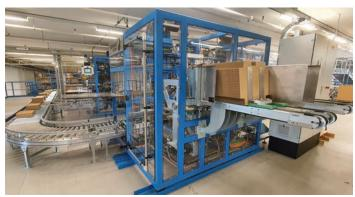
▶ Durch die Volumenreduzierer werden die Umverpackungen automatisch auf Füllhöhe begrenzt. Das sorgt für deutlich material-, personal-, zeit- und kostenoptimierte Prozesse.
