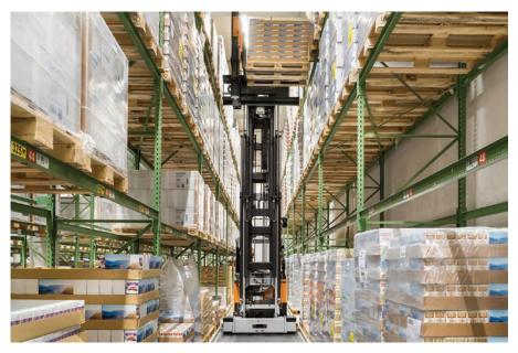
▲ Bei Einlagerungshöhen bis zu 13,8m werden mittels der Aktiven Laststabilisierung und der Gabelzinkenkamera Anfahrschäden am Regal vermieden.
