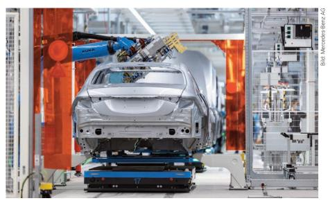
Blick in die Factory 56 von Mercedes in Sindelfingen. Eine PKW-Karosse fährt auf einem Vision E-FTF in eine Roboterzelle ein.
