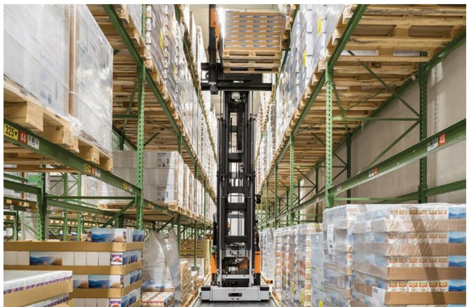
▲ Bei Einlagerungshöhen bis zu 13,8m werden mittels der Aktiven Laststabilisierung und der Gabelzinkenkamera Anfahrtschäden am Regal vermieden.
