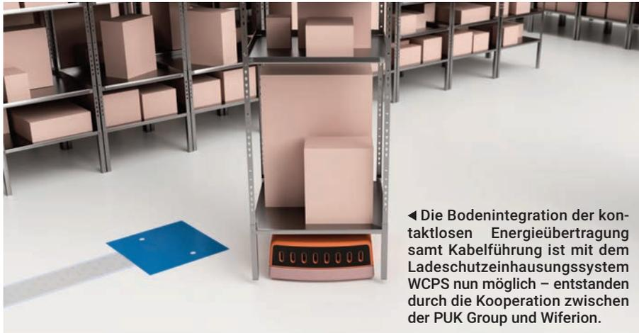
◀ Die Bodenintegration der kontaktlosen Energieübertragung samt Kabelführung ist mit dem Ladeschutz einhausungssystem WCPS nun möglich – entstanden durch die Kooperation zwischen der PUK Group und Wiferion.
