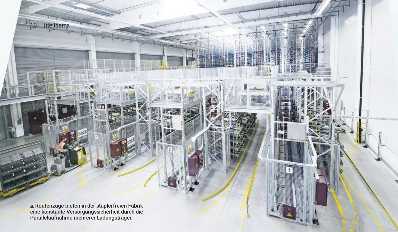
▲ Routenzüge bieten in der staplerfreien Fabrik eine konstante Versorgungssicherheit durch die Parallelaufnahme mehrerer Ladungsträger.
