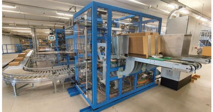
► Durch die Volumenreduzierer werden die Umverpackungen automatisch auf Füllhöhe begrenzt. Das sorgt für deutlich material-, personal-, zeit- und kostenoptimierte Prozesse.
