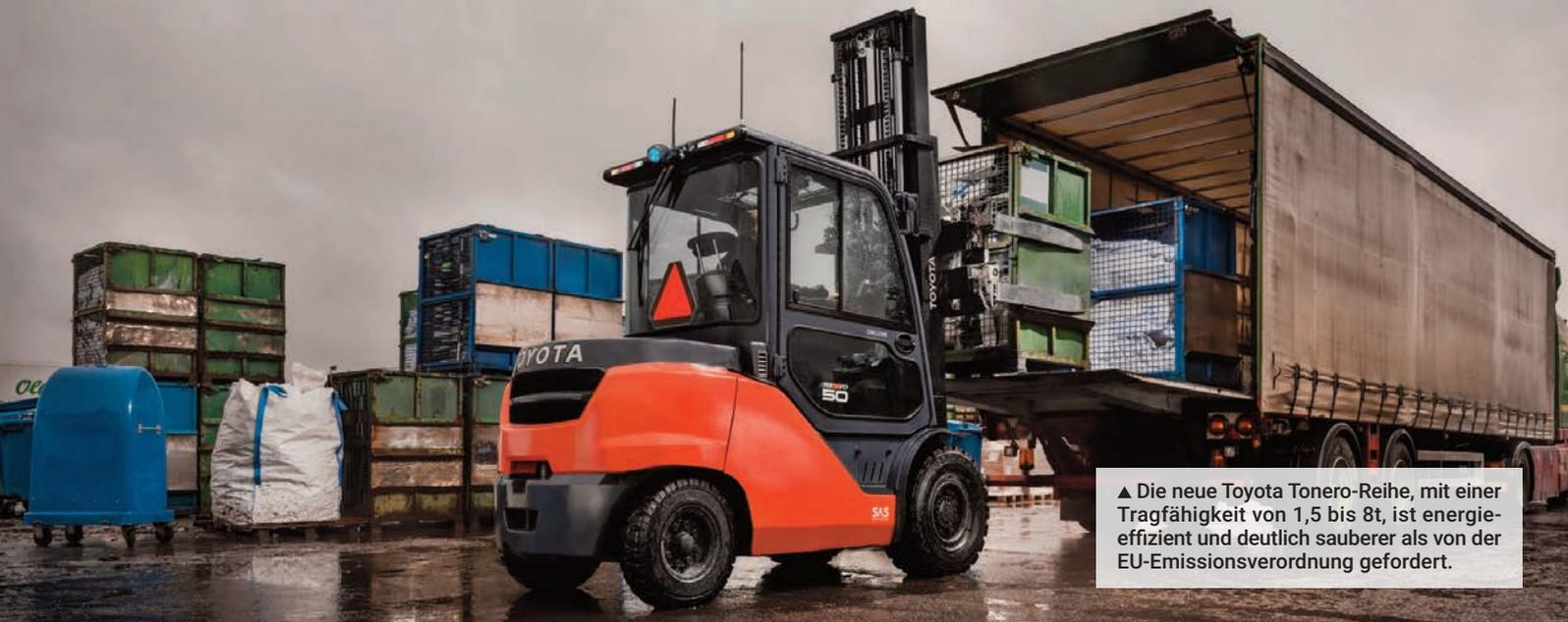
▲ Die neue Toyota Tonerer-Reihe, mit einer Tragfähigkeit von 1,5 bis 8t, ist energieeffizient und deutlich sauberer als von der EU-Emissionsverordnung gefordert.
