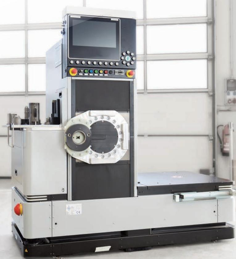
► Für die Montage von Elektroantrieben lieferte dpm FTF, die den selbstständigen Etagenwechsel per Aufzug bewältigen. Auf den Etagen navigieren sie frei nach dem Slam-Prinzip.
