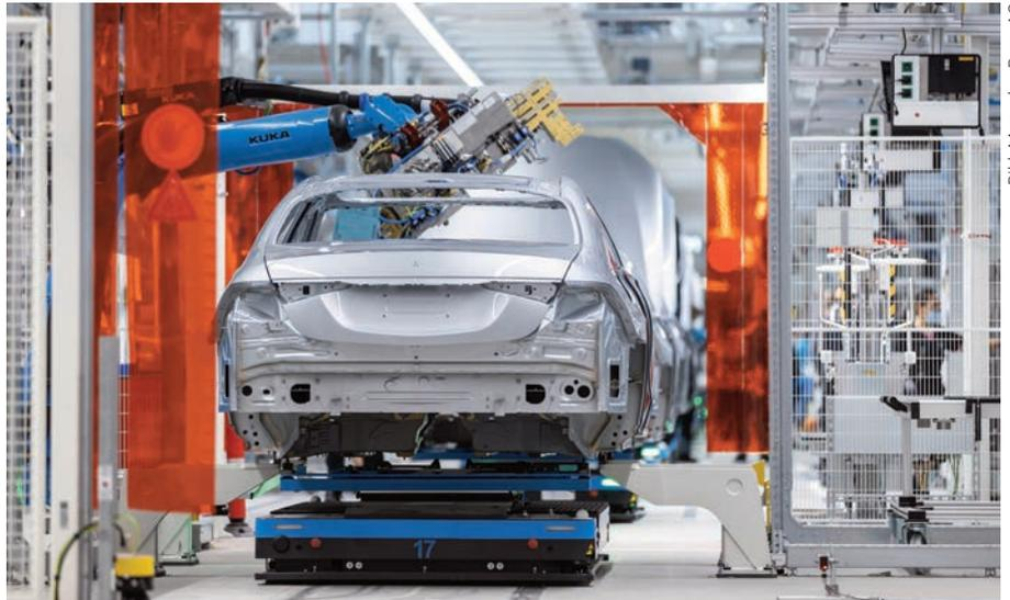
Blick in die Factory 56 von Mercedes in Sindelfingen. Eine PKW-Karosserie fährt auf einem Vision E-FTF in eine Roboterzelle ein.
