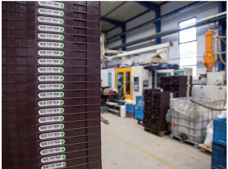
▲ Klappboxen, ausgestattet mit Inmould-Barcode-labels und RFID-Transpondern.
