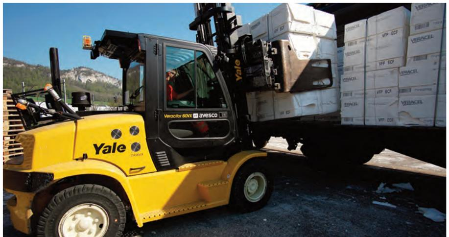
▲ Zu den Optimierungen der Yale Veracitor-VX-Produktreihe gehört z.B. das automatische Ausspülen von Staub aus dem Motorraum, wodurch der Stapler zwischen den Reinigungsintervallen länger in Betrieb bleiben kann.
