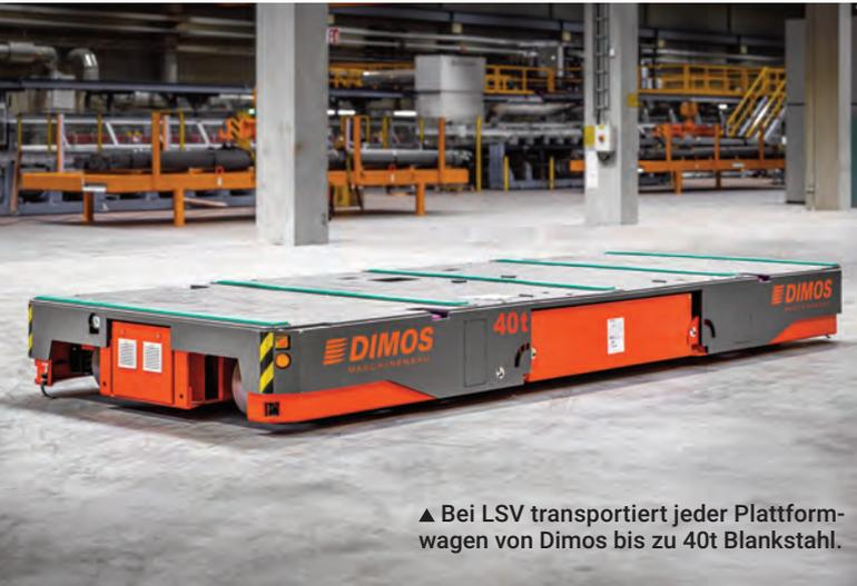
▲ Bei LSV transportiert jeder Plattformwagen von Dimos bis zu 40t Blankstahl.
