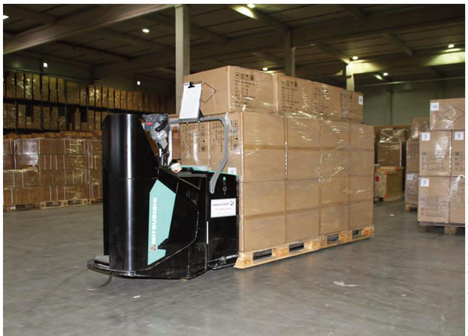
▲ Ein Premia EM PBF25N2 Elektro-Hubwagen mit Fahrerstandplattform und Seitenstützen ist für den Transport von zwei Paletten gleichzeitig mit verlängerten Gabelzinken ausgestattet.
