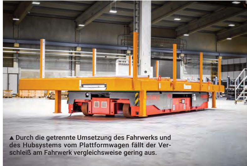
▲ Durch die getrennte Umsetzung des Fahrwerks und des Hubsystems vom Plattformwagen fällt der Verschleiß am Fahrwerk vergleichsweise gering aus.
