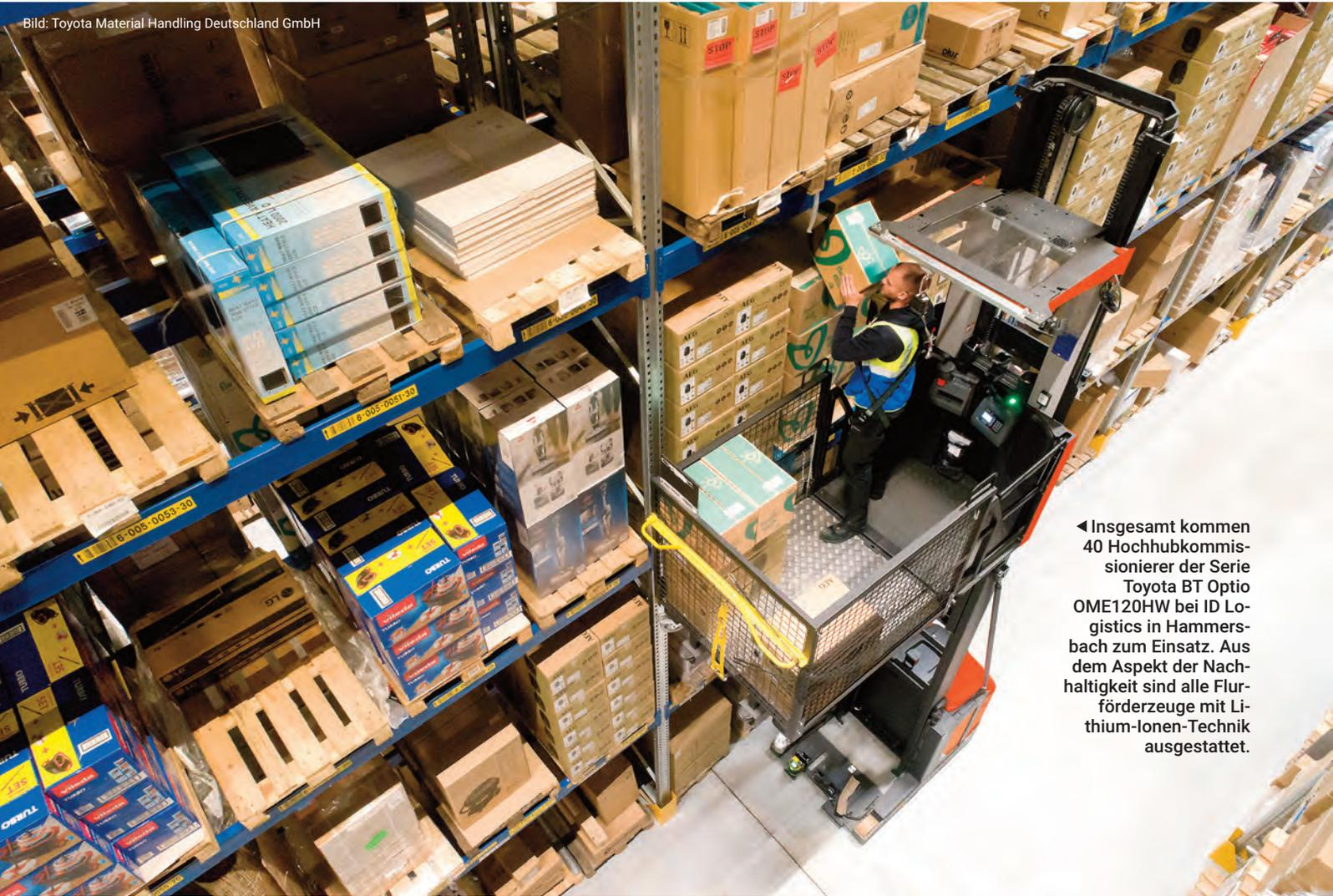
◀ Insgesamt kommen 40 Hochhubkommissionierer der Serie Toyota BT Optio OME120HW bei ID Logistics in Hammersbach zum Einsatz. Aus dem Aspekt der Nachhaltigkeit sind alle Flurförderzeuge mit Lithium-Ionen-Technik ausgestattet.
