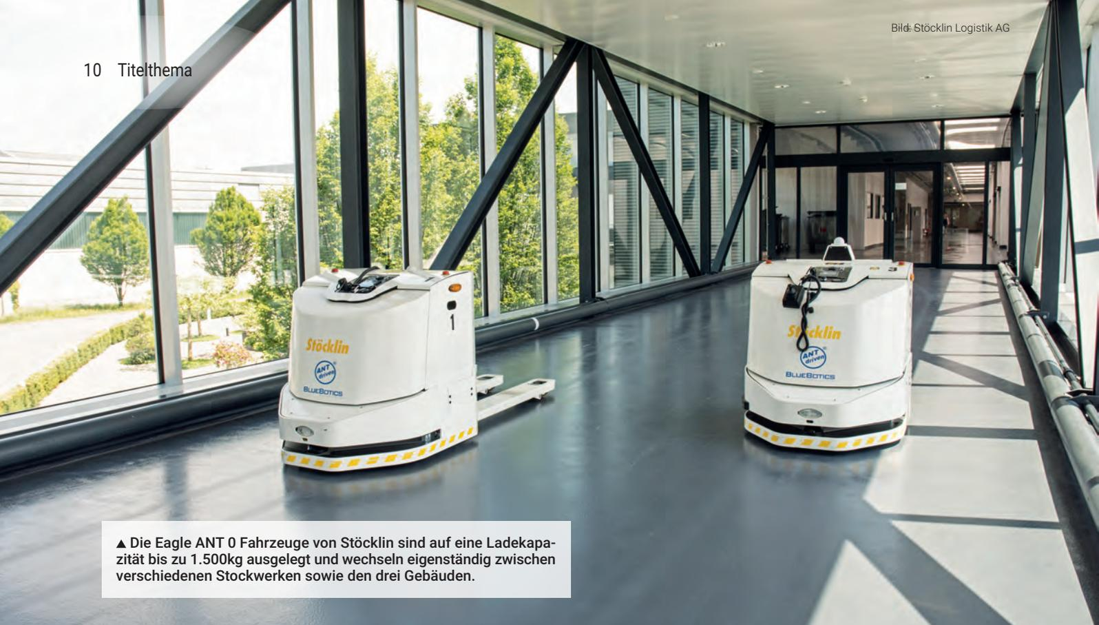
▲ Die Eagle ANT 0 Fahrzeuge von Stöcklin sind auf eine Ladekapazität bis zu 1.500kg ausgelegt und wechseln eigenständig zwischen verschiedenen Stockwerken sowie den drei Gebäuden.
