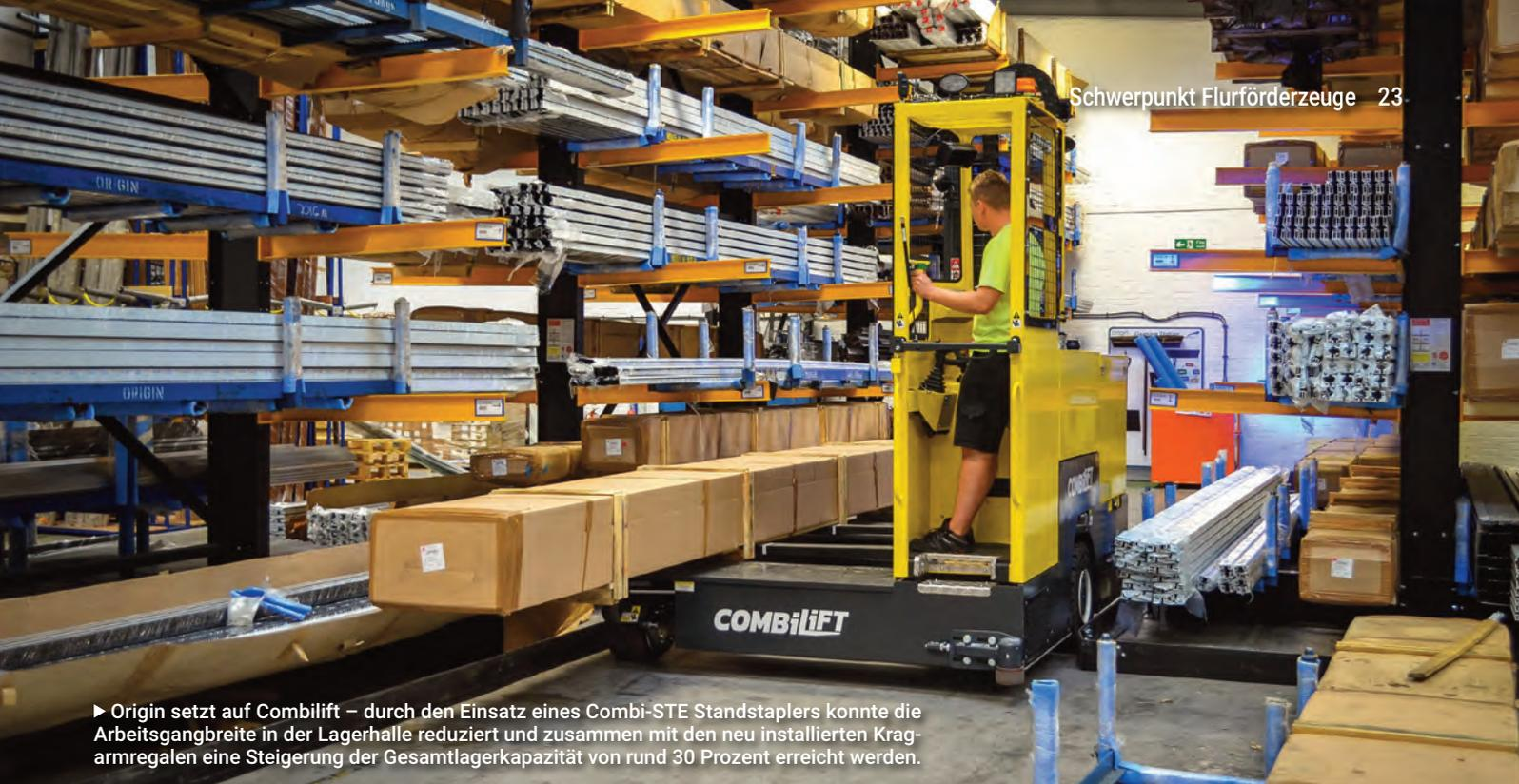
► Origin setzt auf Combilift – durch den Einsatz eines Combi-STE Standstaplers konnte die Arbeitsgangbreite in der Lagerhalle reduziert und zusammen mit den neu installierten Kragarmregalen eine Steigerung der Gesamtlagerkapazität von rund 30 Prozent erreicht werden.
