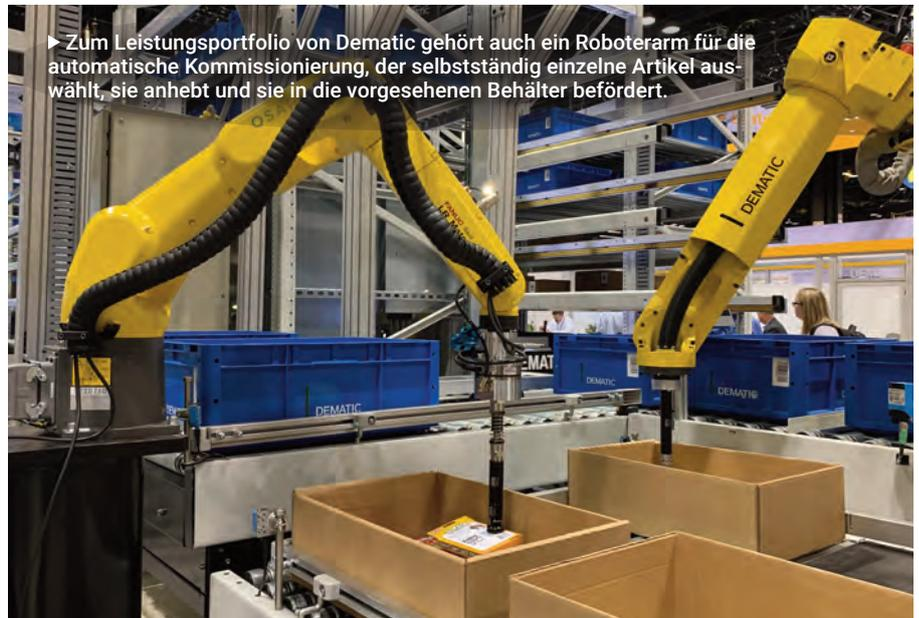
► Zum Leistungsportfolio von Dematic gehört auch ein Roboterarm für die automatische Kommissionierung, der selbstständig einzelne Artikel auswählt, sie anhebt und sie in die vorgesehenen Behälter befördert.
