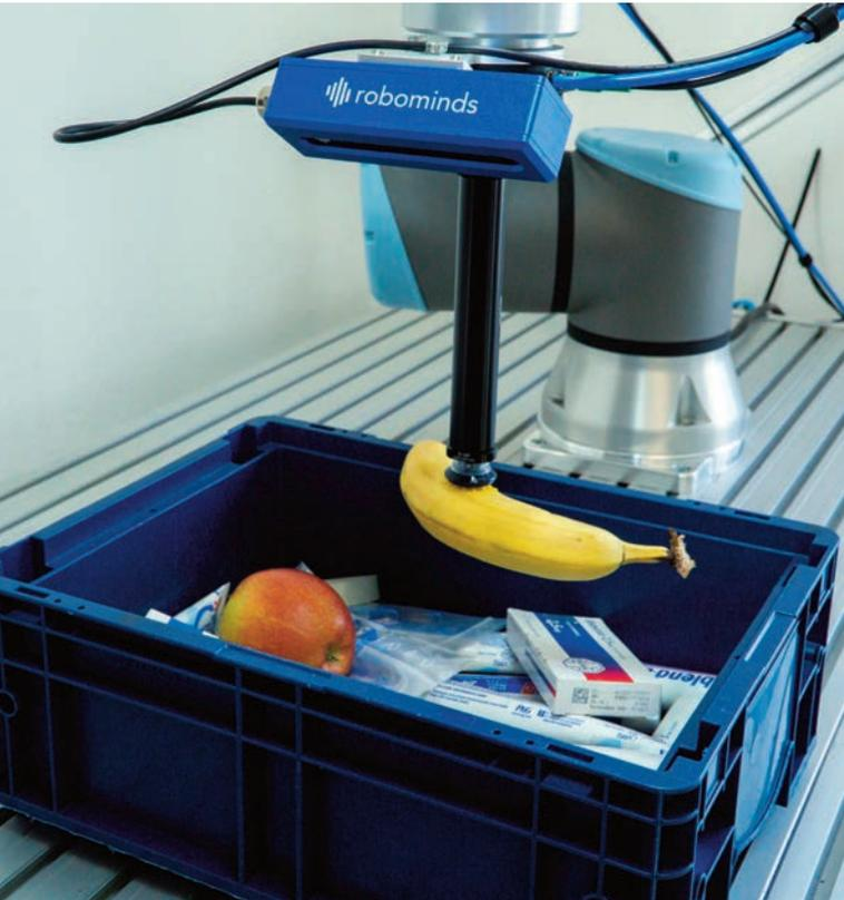
▲ Egal ob Deoroller, Shampoo-Flasche, lose Topfschwämme, Kekspackungen, Pflasterschachteln, Senftuben, in Folien verpackte Einwegrasierer, Gummibärchen, Mund-Nase-Masken oder Eiskratzer – das Greifen dieser Produkte stellt für den MX Sauger von Piab keine Schwierigkeit dar.
