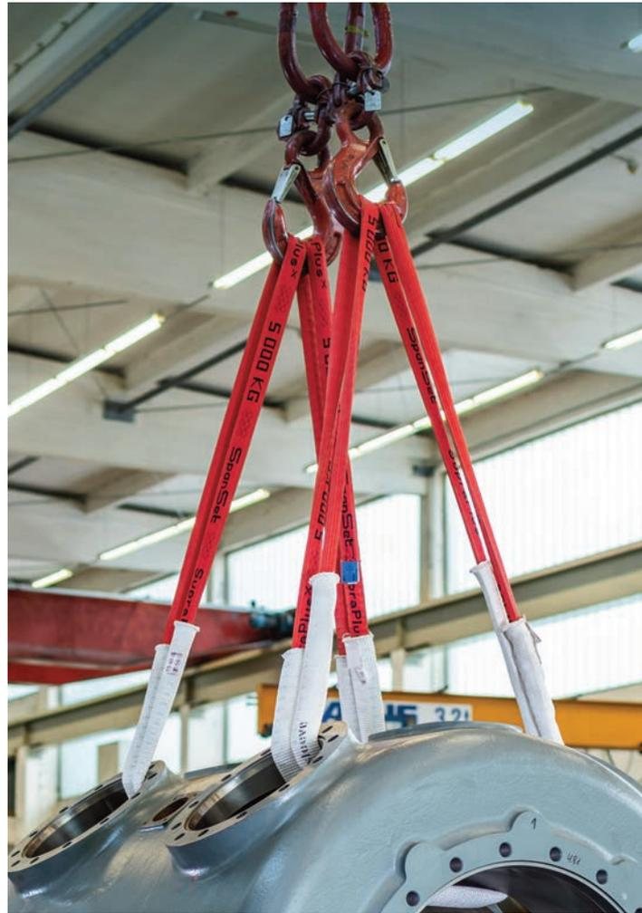
▲ SupraPlus-X mit neuen Pluspunkten: zum Beispiel verstärkte Rippen in der Schlauchhülle und deutlichere Kennzeichnung der Nenntragfähigkeit.
