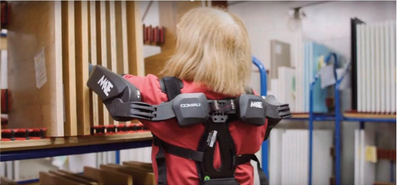
▲ Neben der Küchenfertigung bei Rotpunkt kann das Comau Mate-Exoskelett auch für jede Überkopftätigkeit oder manuelle Arbeit eingesetzt werden. Ob in der Montage oder Materialhandhabung sowie anderen gewerblichen und industriellen Einsätze – Mate arbeitet so, wie es der Mitarbeiter tut.
