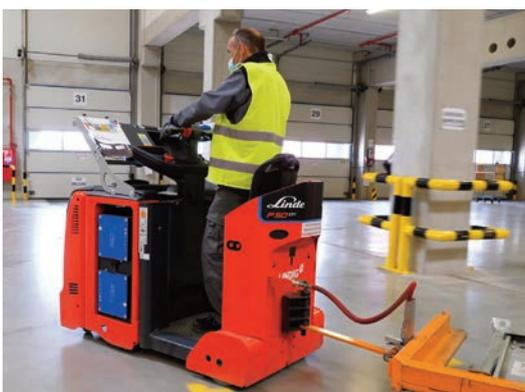
▲ Durch das induktive Laden entfällt der Zeit- und kostenaufwändige Batteriewechsel. SMA profitiert von einer höheren Fahrzeugverfügbarkeit und reduzierten Durchlaufzeiten.
