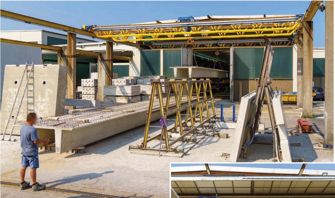
▲ Zwei Krane werden in Smart-Tandem über eine Mini-Joystick-Steuerung bedient.
