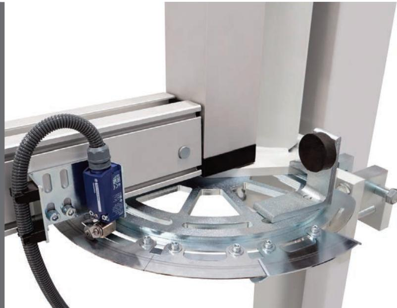
▲ Die Schwenkwinkelbegrenzung mit Prozessüberwachung sorgt für mehr Sicherheit bei der Beladung von Bearbeitungsmaschinen.
