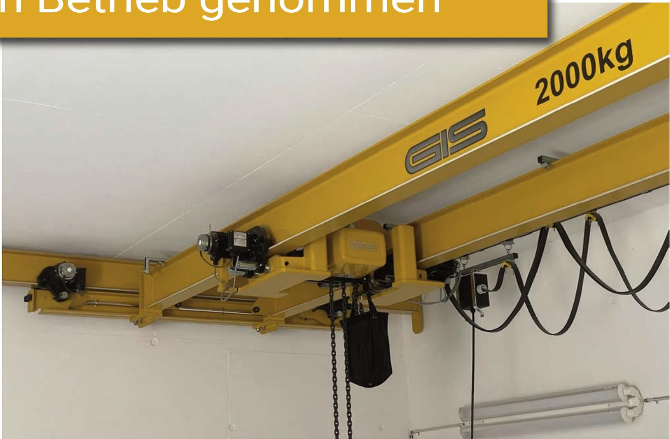
▲ GIS Kettenzug eingebaut zwischen den Stahlträger.
