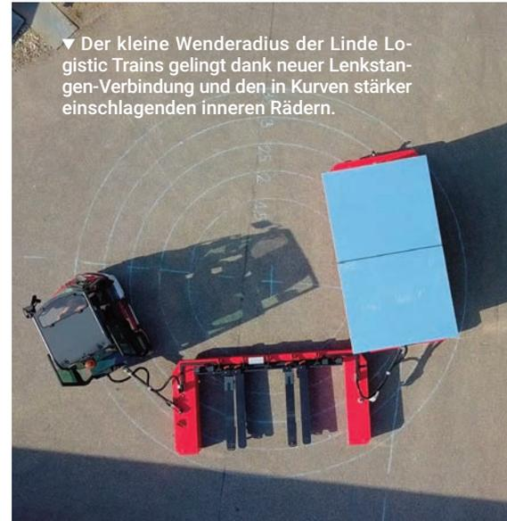
▼ Der kleine Wenderadius der Linde Logistic Trains gelingt dank neuer Lenkstocken-Verbindung und den in Kurven stärker einschlagenden inneren Rädern.
