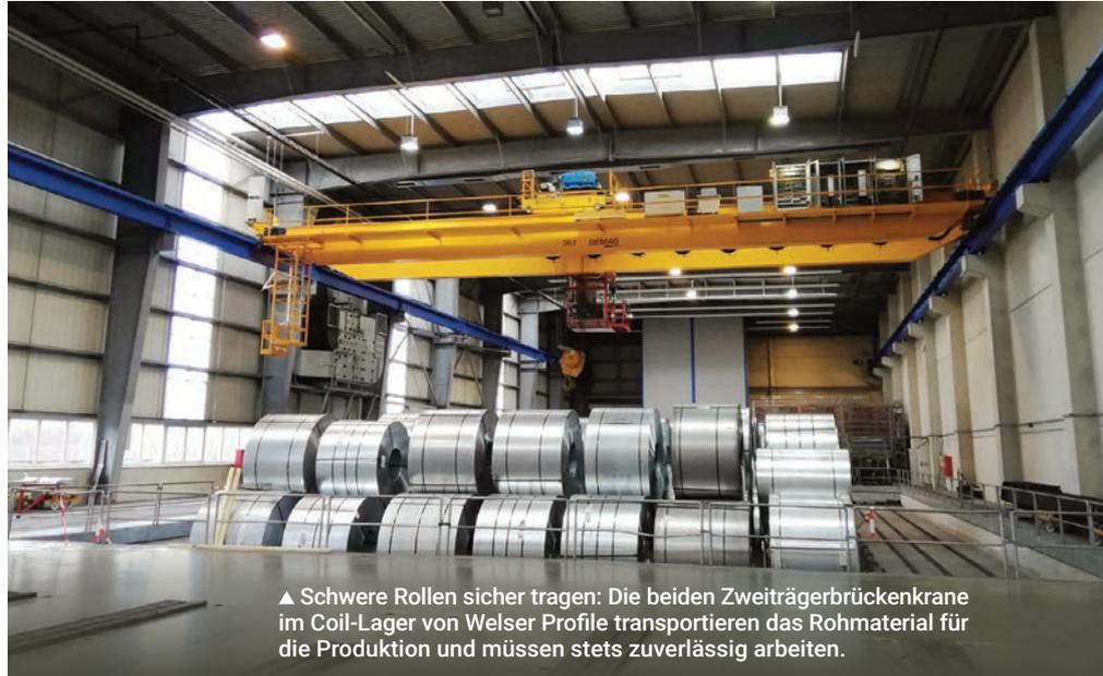
▲ Schwere Rollen sicher tragen: Die beiden Zweiträgerbrückenkrane im Coil-Lager von Welser Profile transportieren das Rohmaterial für die Produktion und müssen stets zuverlässig arbeiten.
