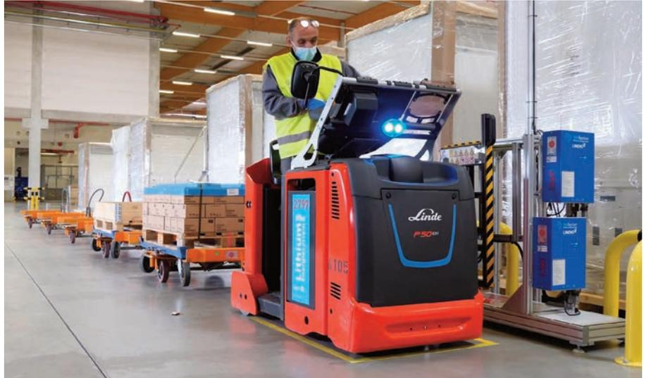
▲ Der Entsorgungsturm ist der Start- und Endpunkt jeder Routenzugrunde und ist daher perfekt für das „In-Process-Charging“ geeignet.
