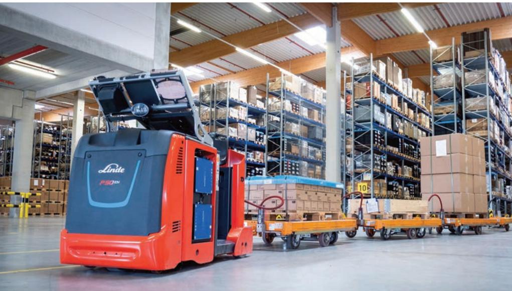
Um den Materialfluss in seinem Logistikzentrum in Fuldabrück effizienter zu gestalten, setzt der Solartechnik-Hersteller SMA auf Routenzugschlepper mit der induktiven Ladetechnik von Wiferion. Dadurch entfallen die aufwändigen Batteriewechsel sowie Fahrten zu den Wechselstätten und die damit verbundenen Stillstandszeiten.
