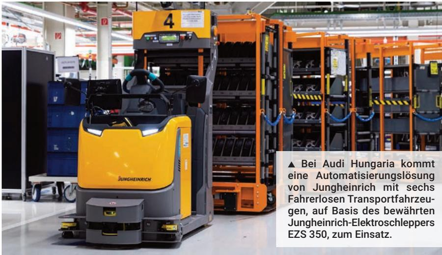
▲ Bei Audi Hungaria kommt eine Automatisierungslösung von Jungheinrich mit sechs Fahrerlosen Transportfahrzeugen, auf Basis des bewährten Jungheinrich-Elektroschleppers EZS 350, zum Einsatz.
