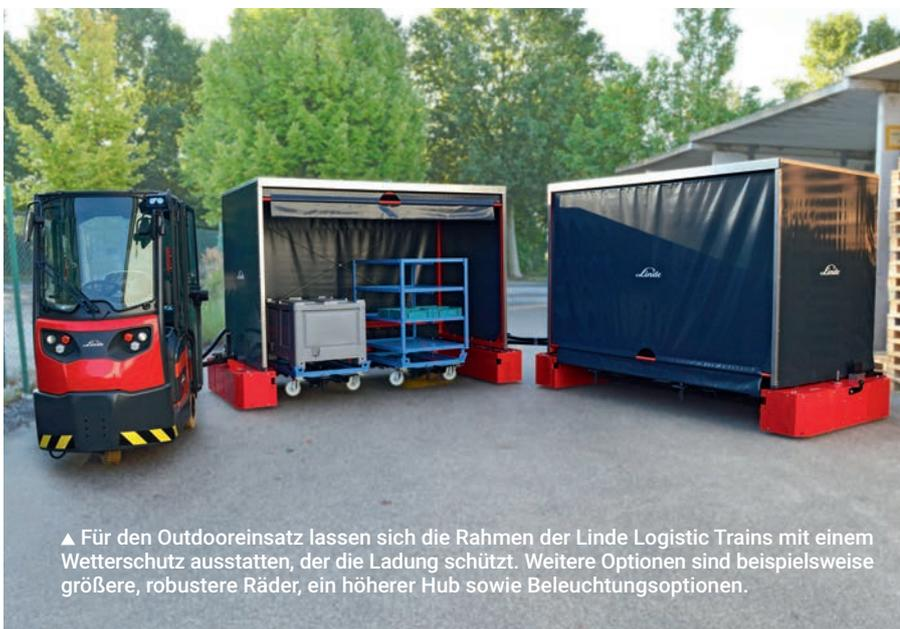
▲ Für den Outdooreinsatz lassen sich die Rahmen der Linde Logistic Trains mit einem Wetterschutz ausstatten, der die Ladung schützt. Weitere Optionen sind beispielsweise größere, robustere Räder, ein höherer Hub sowie Beleuchtungsoptionen.
