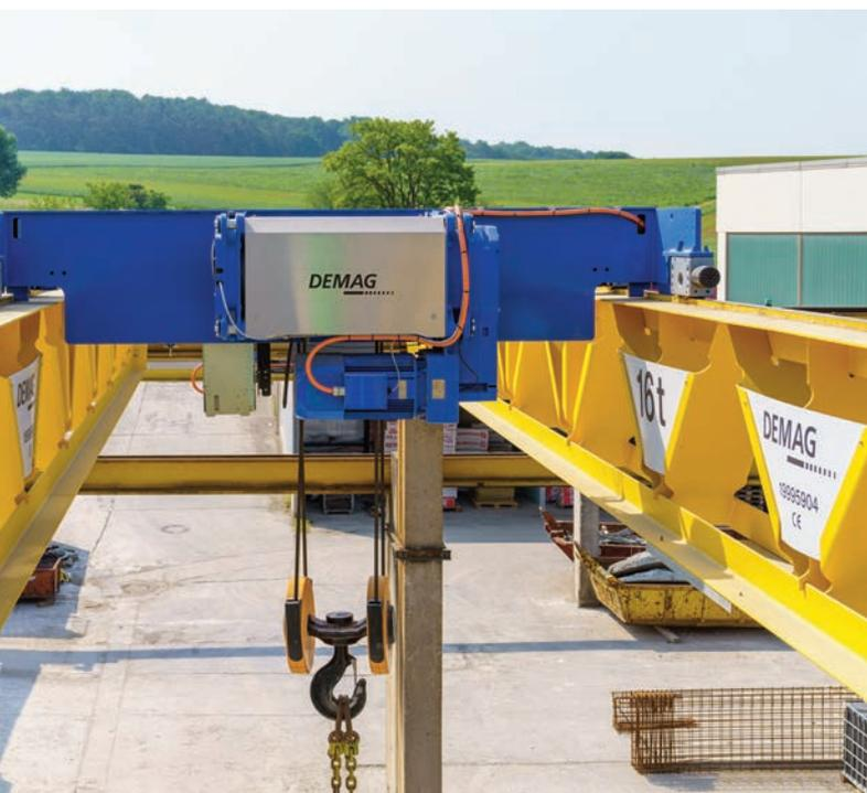
▲ Als Hebezeug kommt der modulare DMR-Seilzug zum Einsatz.
