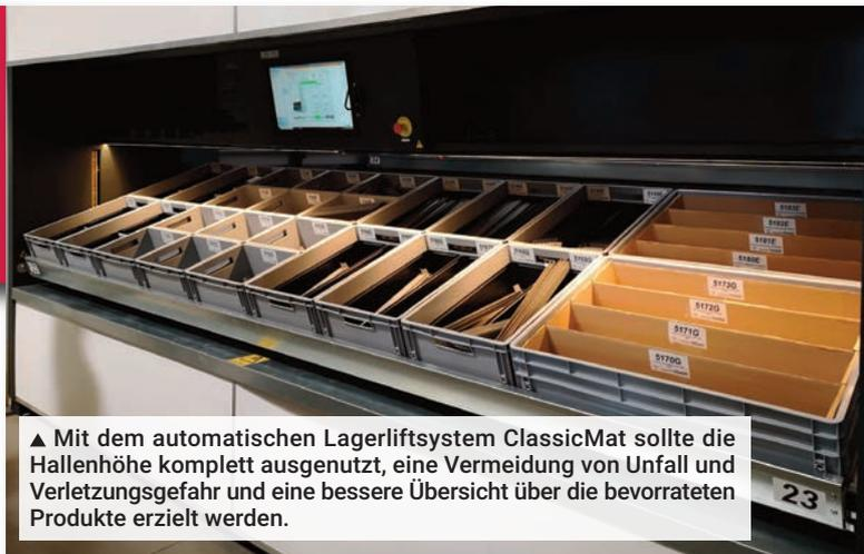
▲ Mit dem automatischen Lagerliftsystem ClassicMat sollte die Hallenhöhe komplett ausgenutzt, eine Vermeidung von Unfall und Verletzungsgefahr und eine bessere Übersicht über die bevorrateten Produkte erzielt werden.
