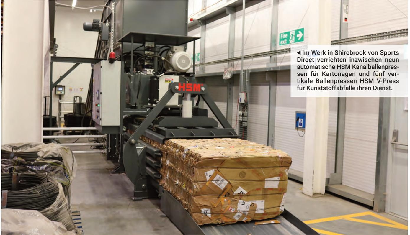
◀ Im Werk in Shirebrook von Sports Direct verrichten inzwischen neun automatische HSM Kanalballenpressen für Kartonagen und fünf vertikale Ballenpressen HSM V-Press für Kunststoffabfälle ihren Dienst.
