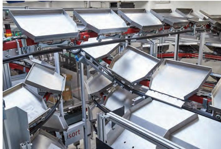
▲ Konisch zulaufende Seitenführungen und permanente Linksneigung der Denisort-Schalen ermöglichen besonders enge Kufenradien beim Augenoptikerhersteller Zeiss in Aalen.
