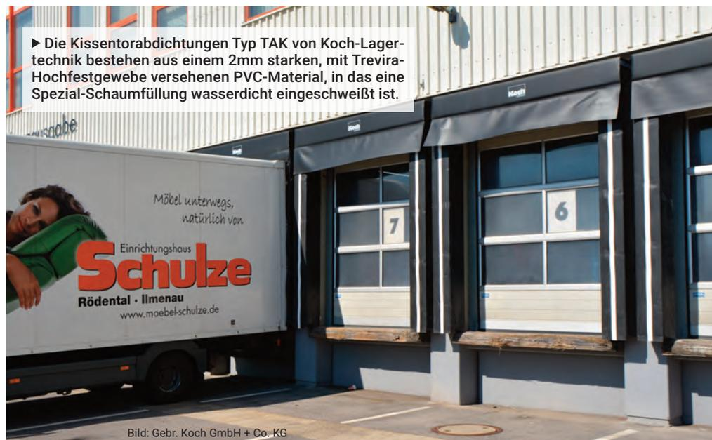
tung führt zu dem Vorschlag, die Seitenteile der neuen Kissenabdichtungen enger zusammenzurücken und damit die Durchlässe schmaler zu machen. Dies kann Firma Koch mit speziellen Befestigungskonsolen erreichen, so dass am Gebäude selbst keine Änderungen mehr notwendig sind. Für die horizontalen Kissen sind die bereits vorhandenen Befestigungselemente weiterhin verwendbar. Der Vorschlag findet Zustimmung und führt zum Erteilen des Auftrags.
