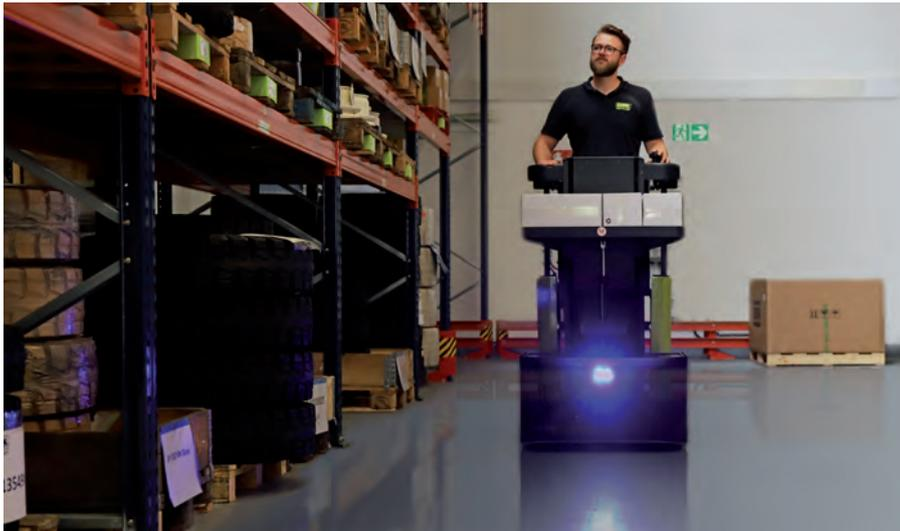
▲ Für ein Arbeiten in schlecht ausgeleuchteten Arbeitsbereichen bzw. als Warnung für den Gegenverkehr verfügt das Fahrzeug über eine integrierte LED-Leuchte im vorderen Fahrzeugrahmen.
