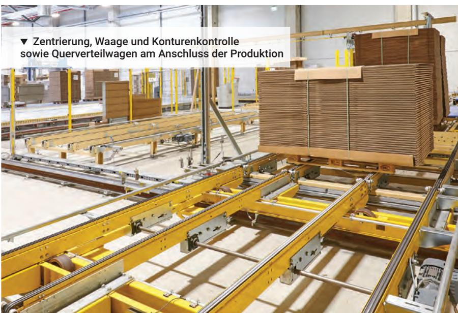
▼ Zentrierung, Waage und Konturenkontrolle sowie Querverteilwagen am Anschluss der Produktion
