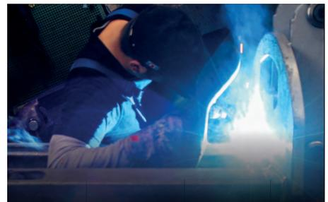
**Richt- und Schweißarbeiten von Hubgerüsten, Anbaugeräten Gabelträgern und Hydraulikzylindern.**
