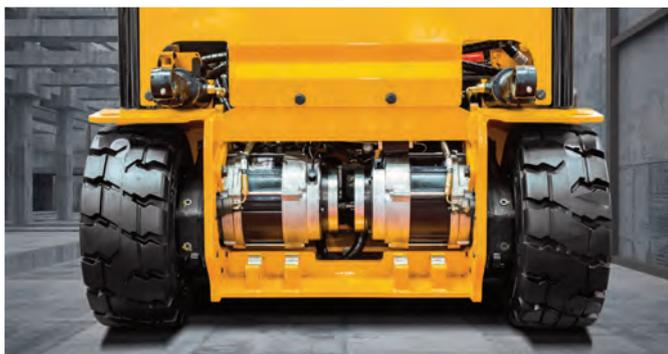
▲ Je zwei Schabmüller-Motoren treiben die neuen Stapler an. Neue ZF-Radsatzgetriebe und Zapi-Steuerungen verdeutlichen den sehr hohen technischen Stand der südkoreanischen Frontstapler.
