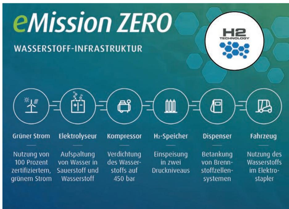
Vom grünen Strom bis zur Nutzung im Stapler: Mithilfe der in Betrieb genommenen Wasserstoffinfrastruktur wird der gesamte Prozess von der H<sub>2</sub>-Produktion über die Komprimierung und Speicherung bis hin zum Dispenser abgebildet.
