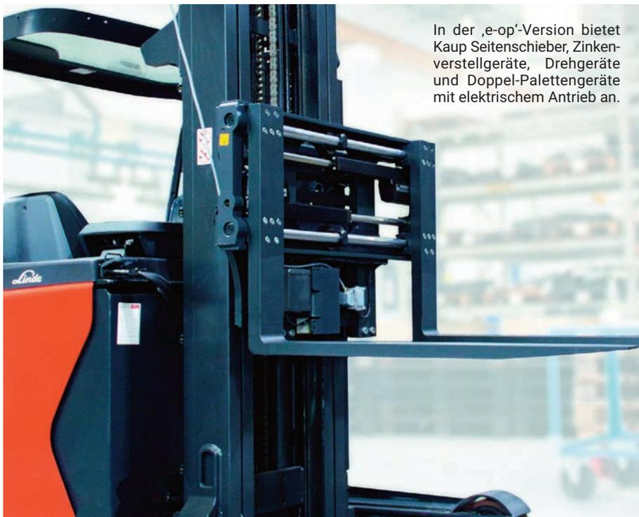
In der ‚e-op‘-Version bietet Kaup Seitenschieber, Zinkenverstellgeräte, Drehgeräte und Doppel-Palettengeräte mit elektrischem Antrieb an.
