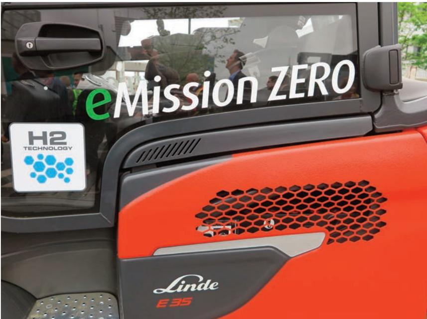
Seit 2010 sind die Brennstoffzellenstapler in die Serienproduktion integriert und Stand heute können 80 Prozent der Baureihen, darunter Gegengewichtstapler, Schlepper und Hochhubwagen, als „kundenspezifische Lösung“ mit H2-Antrieb bestellt werden.
