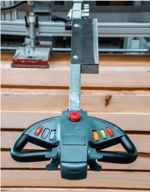
Der übersichtlich gestaltete Bediengriff erlaubt eine intuitive Bedienung des Vakuumhebergerätes. Mensch und Maschine arbeiten so Hand in Hand.
