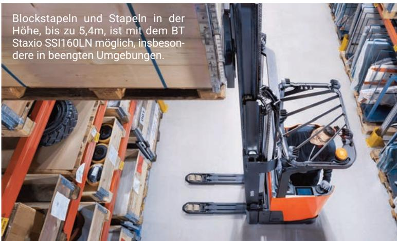
Blockstapeln und Stapeln in der Höhe, bis zu 5,4m, ist mit dem BT Staxio SSI160LN möglich, insbesondere in beengten Umgebungen.
