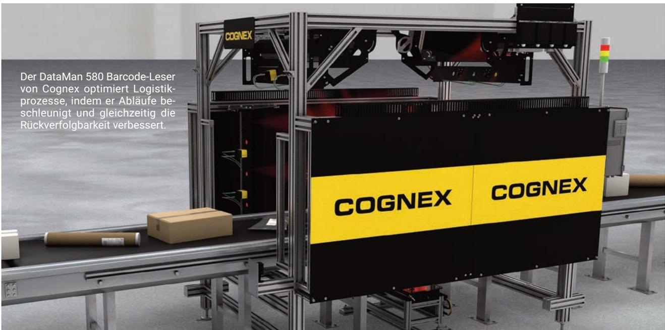
Der DataMan 580 Barcode-Leser von Cognex optimiert Logistikprozesse, indem er Abläufe beschleunigt und gleichzeitig die Rückverfolgbarkeit verbessert.
