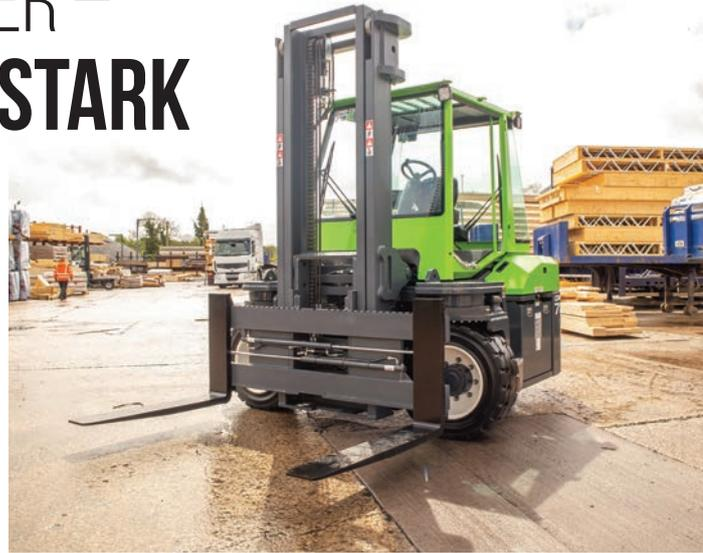
Der neue Combi-CB70E ist der kürzeste Gegengewichtsstapler mit 7t Tragfähigkeit auf dem Markt – seine multidirektionale Fähigkeit ermöglicht den vielseitigen, platzsparenden Transport von langen und sperrigen Lasten.
