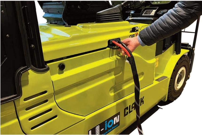
Das Ladegerät mit 80V benötigt lediglich einen Starkstromanschluss (CEE 16 A-Stecker) und lädt die Batterie in gut 3,5 Stunden vollständig wieder auf.
