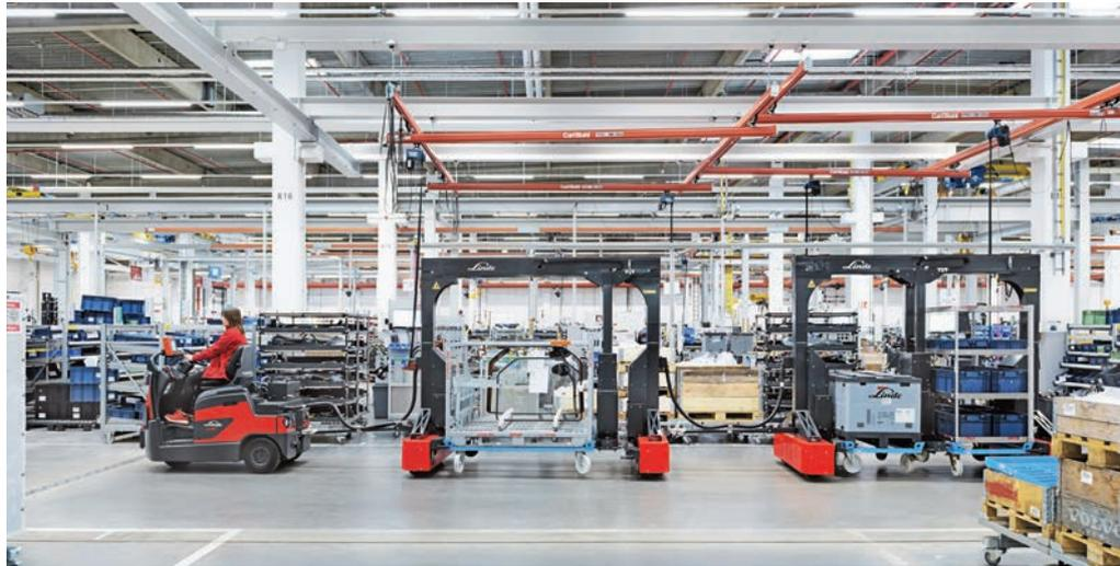
Flexibler Logistikzug für Transporte zwischen Hallen mit Schlepper P80 und Modellen LT16-BM.
