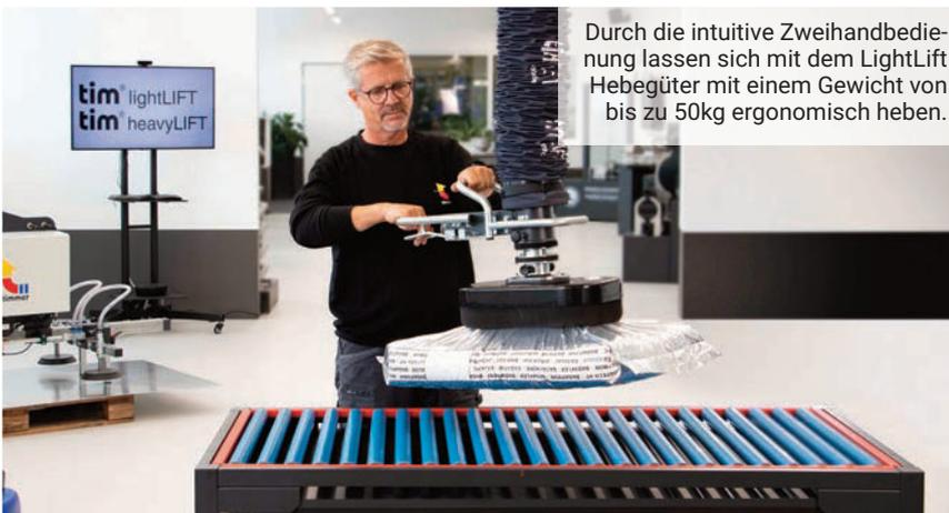
Durch die intuitive Zweihandbedienung lassen sich mit dem LightLift Hebegüter mit einem Gewicht von bis zu 50kg ergonomisch heben.
