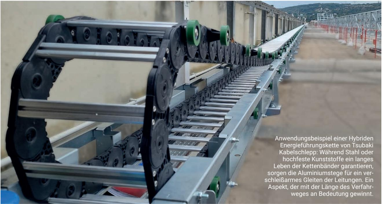
Anwendungsbeispiel einer Hybriden Energieführungskette von Tsubaki Kabelschlepp: Während Stahl oder hochfeste Kunststoffe ein langes Leben der Kettenbänder garantieren, sorgen die Aluminiumstege für ein verschleißarmes Gleiten der Leitungen. Ein Aspekt, der mit der Länge des Verfahrensweges an Bedeutung gewinnt.
