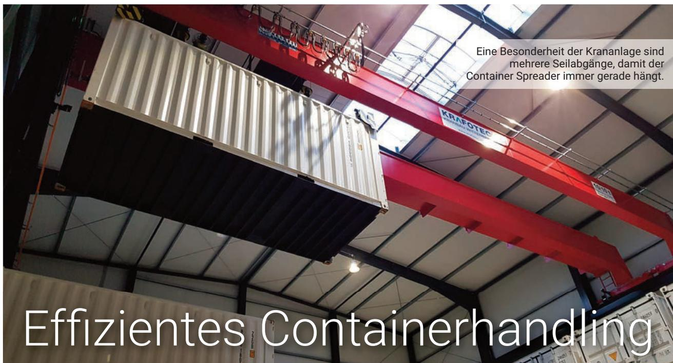
Eine Besonderheit der Krananlage sind mehrere Seilabgänge, damit der Container Spreader immer gerade hängt.
