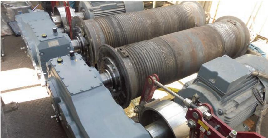
Die beiden neuen Hubwerksgetriebe vom Typ X4FCC140/HC haben jeweils ein dauerhaftes Nenndrehmoment von 22.000Nm. Im Bild: das Hubwerk mit den beiden neuen Getrieben.
