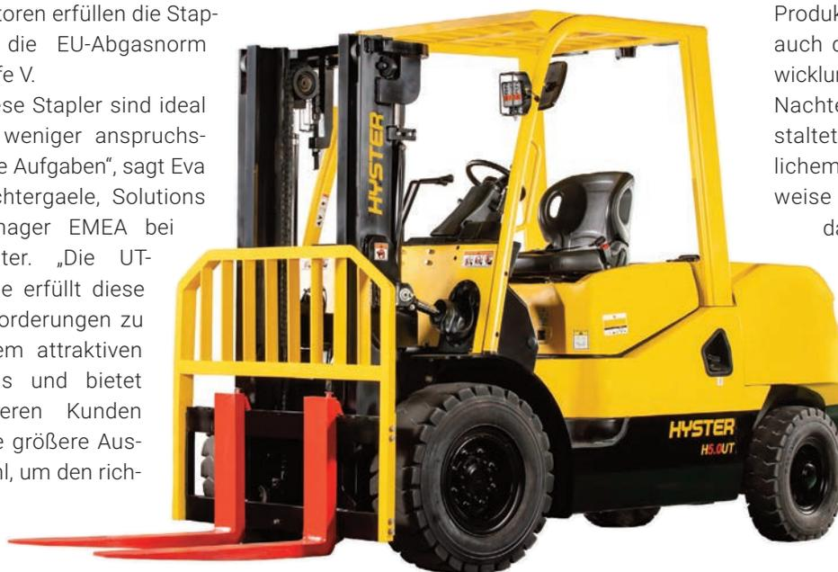
Hysters neue verbrennungsmotorischen Stapler H4.0-5.0UT und H 5.0-7.0UT6, mit Tragfähigkeiten von 4 bis 7t, ergänzen die bestehende UT-Serie.
