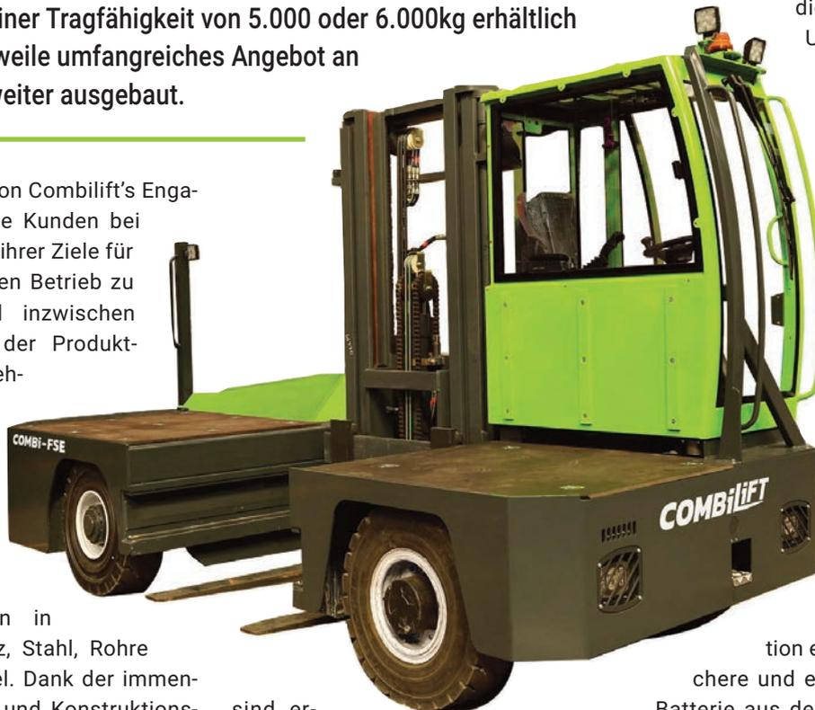
sind, ermöglichen es, die beiden unabhängigen 15kW-Antriebsmotoren an der Hinterachse einzeln zu steuern, wobei die Geschwindigkeit jedes Rades durch den Lenkwinkel der Vorderräder geregelt wird – um dem Fahrer eine bessere Lenkkontrolle zu ermöglichen, den Wenderadius des Staplers zu verbessern und den Reifenverschleiß zu verringern. In Kombination mit der regenerativen Bremse (die die kinetische Energie des Staplers beim
