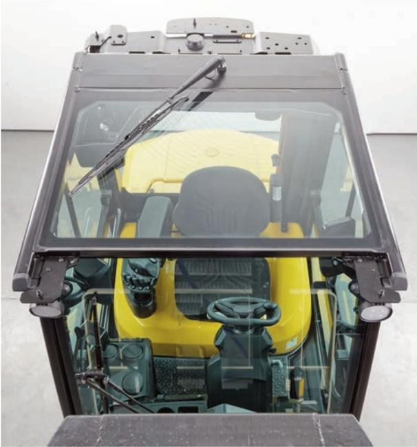
▲ Das optionale transparente Glasdach ermöglicht eine ungehinderte Sicht nach oben, sodass der Fahrer Lasten in der Höhe präzise aufnehmen und platzieren kann.
