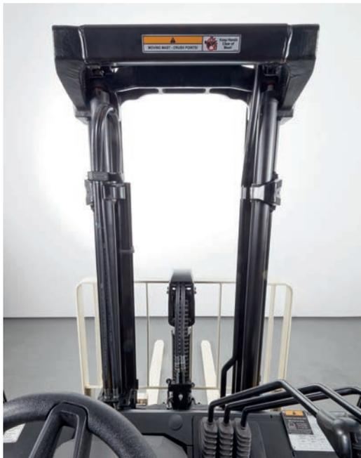
▲ Die Stapler verfügen über ein breites Hubgerüstfenster, das bei der Fahrt oder dem Transport von Lasten eine optimale Sicht nach vorn bietet.
