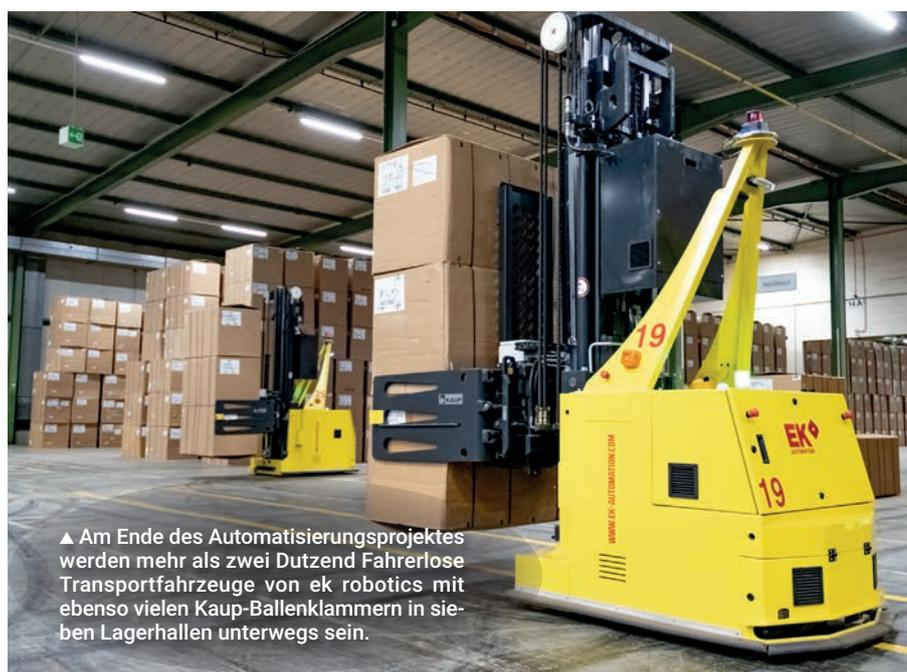
▲ Am Ende des Automatisierungsprojektes werden mehr als zwei Dutzend Fahrerlose Transportfahrzeuge von ek robotics mit ebenso vielen Kaup-Ballenklammern in sieben Lagerhallen unterwegs sein.
