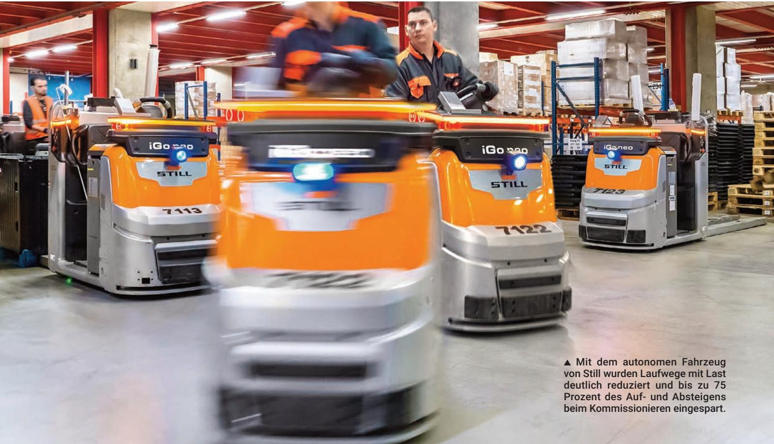
▲ Mit dem autonomen Fahrzeug von Still wurden Laufwege mit Last deutlich reduziert und bis zu 75 Prozent des Auf- und Absteigens beim Kommissionieren eingespart.
