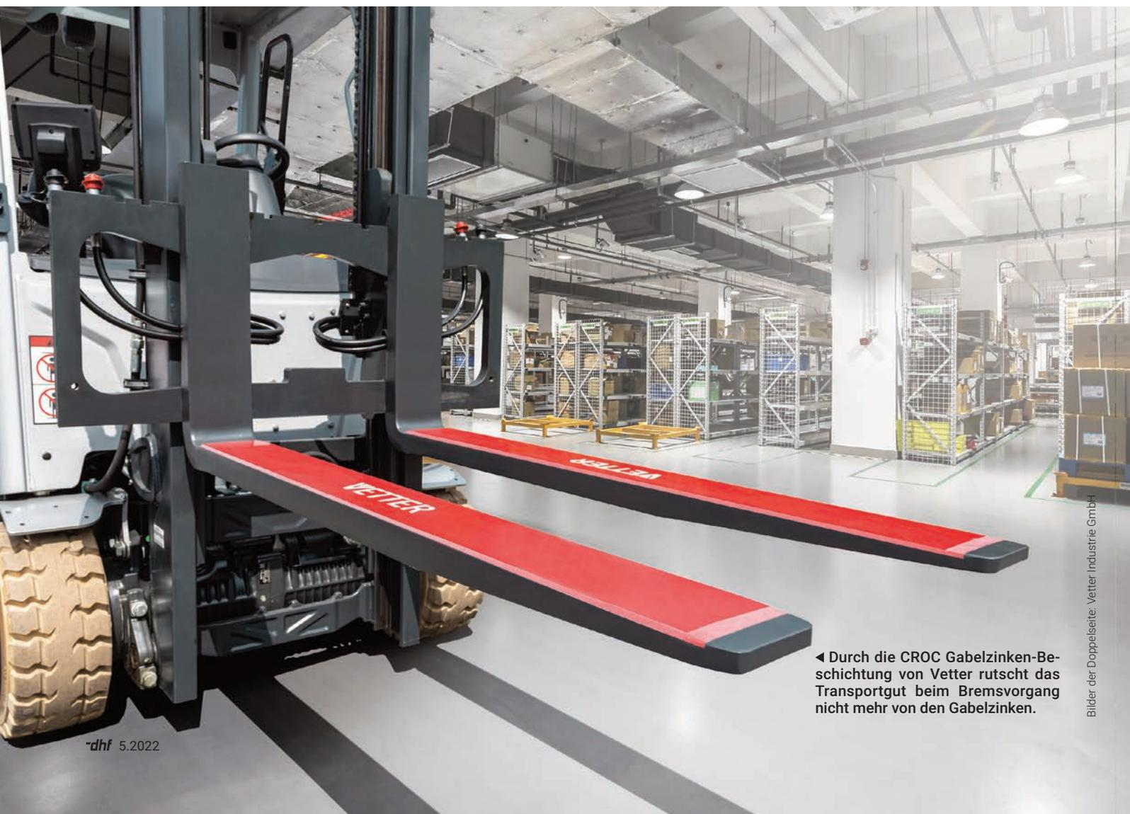
◀ Durch die CROC Gabelzinken-Beschichtung von Vetter rutscht das Transportgut beim Bremsvorgang nicht mehr von den Gabelzinken.
