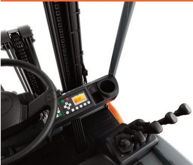
▲ Der neue Toyota-Elektrostapler ist mit verschiedenen Bedienelementen verfügbar: Minihebel, Multifunktionshebel sowie die Standardhebel. Zudem bietet das neu gestaltete Armaturenbrett eine sehr gute Sicht auf die Ladung.
