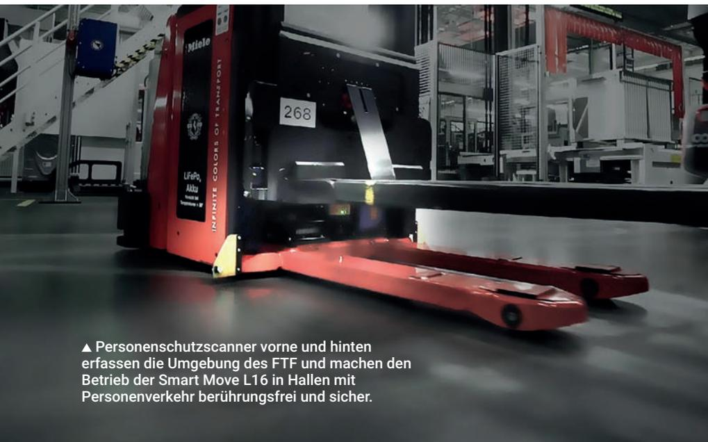
▲ Personenschutzscanner vorne und hinten erfassen die Umgebung des FTF und machen den Betrieb der Smart Move L16 in Hallen mit Personenverkehr berührungsfrei und sicher.
