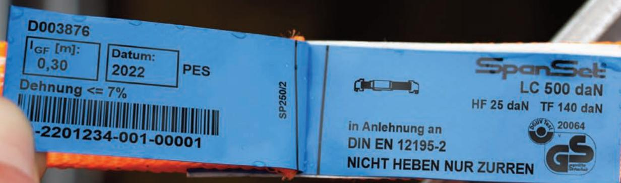
▲ Zertifizierung eines leichten Zurrsystems durch die DGUV „in Anlehnung“ an EN 12195-2.
