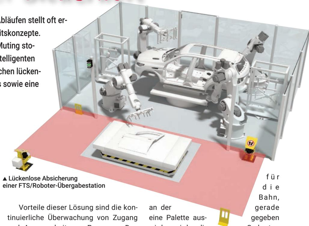
▲ Lückenlose Absicherung einer FTS/Roboter-Übergabestation
