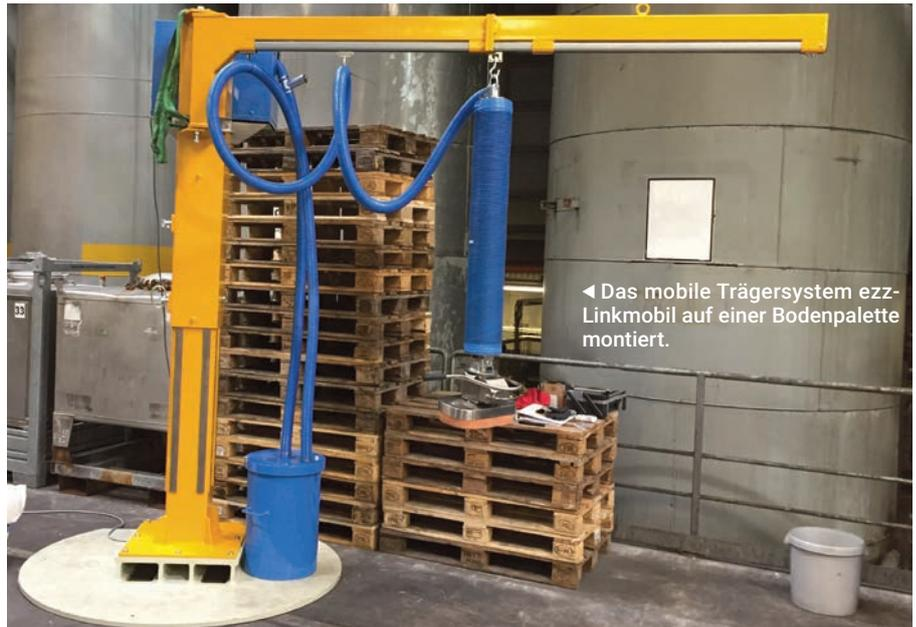
◀ Das mobile Trägersystem ezz-Linkmobil auf einer Bodenpalette montiert.
