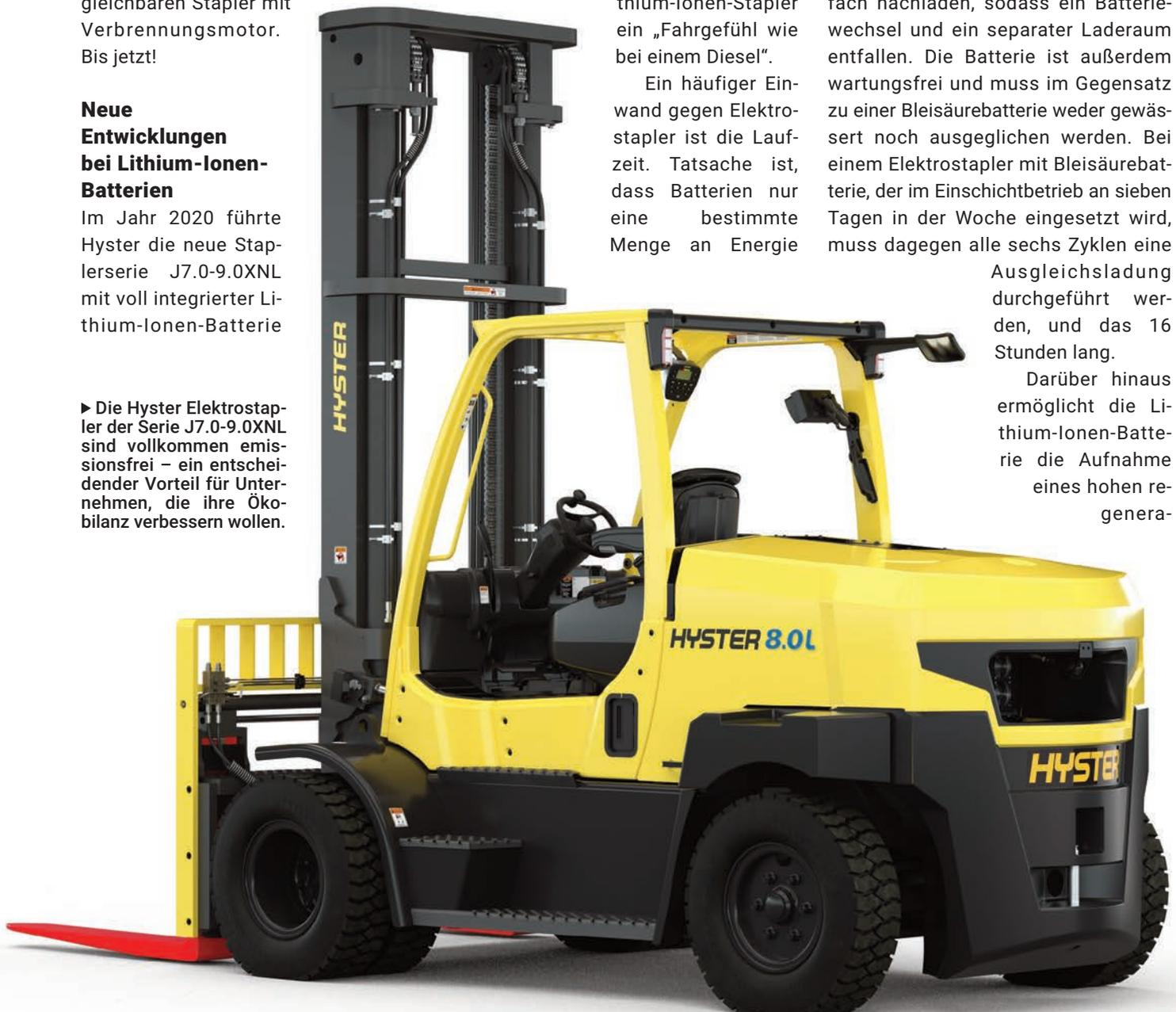
tiven Bremsstroms, was die Laufzeit verlängert und die Effizienz steigert. Diese Betriebsart gibt es nur bei Elektrostaplern. Sie bietet den zusätzlichen Vorteil, dass die Bremsen weniger verschleifen, was wiederum zur Senkung der Wartungskosten beiträgt.
