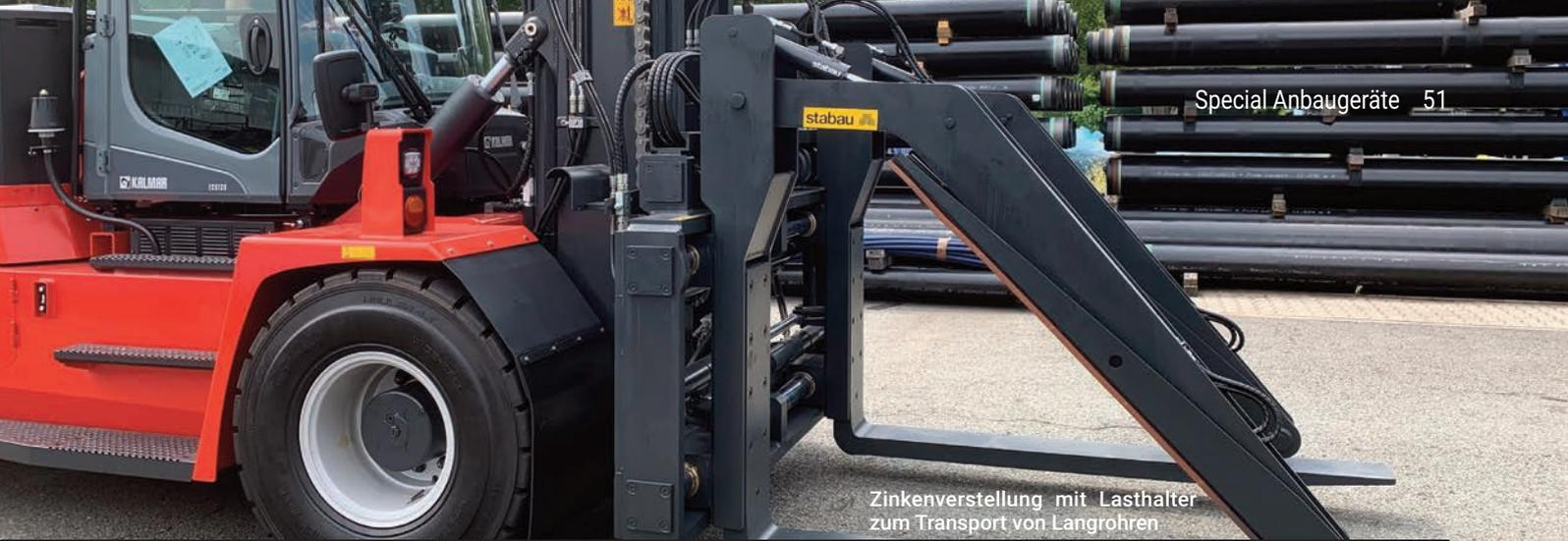
Zinkenverstellung mit Lasthalter zum Transport von Langrohren
