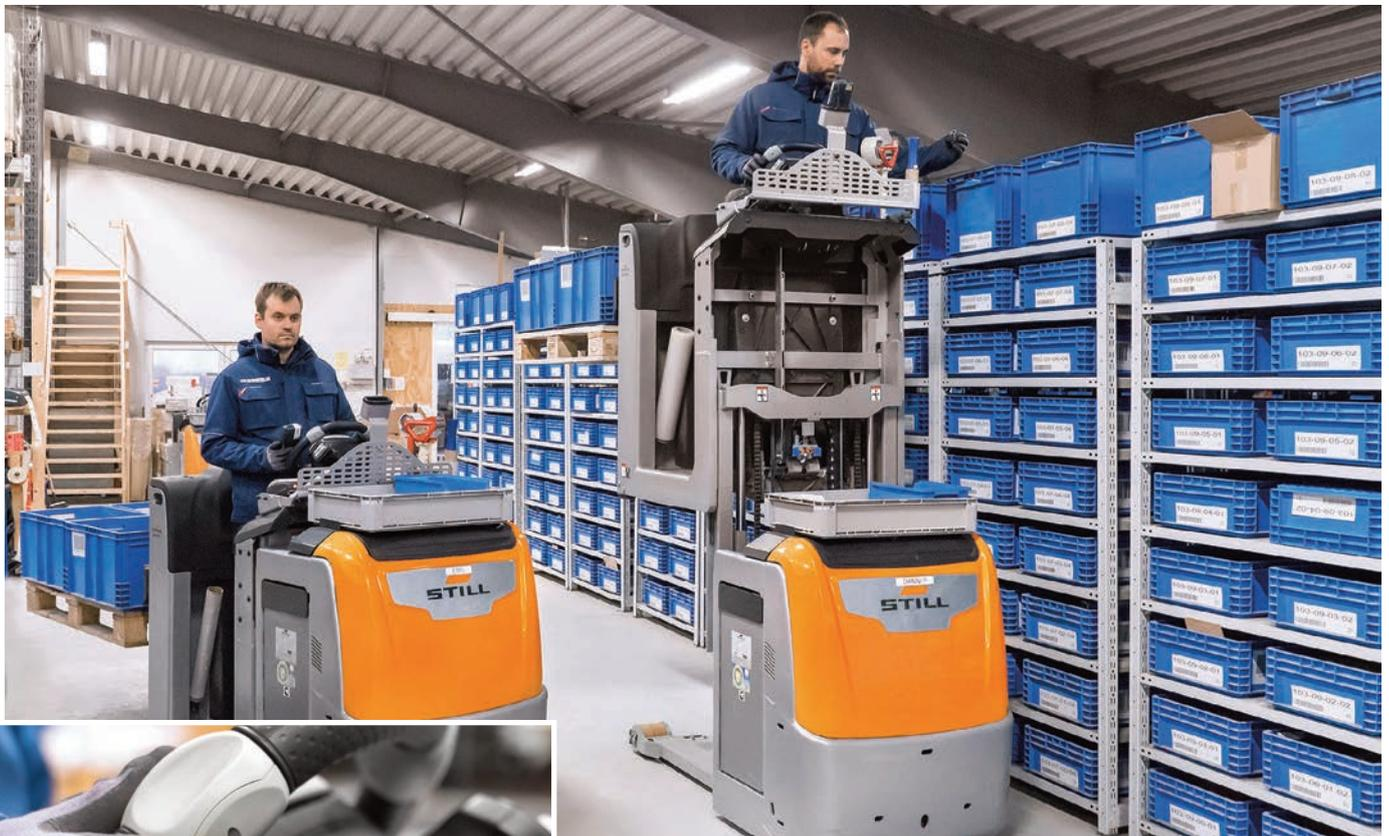
▲ Im Zusammenspiel mit dem EK-X im Hochregal und dem OPX für die Bodenebene setzt der OXV neue Maßstäbe beim Kommissionieren mit Greifhöhen von bis zu 2.800mm.
