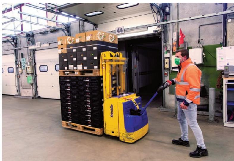
▲ Der EDI mit Mitteldeichsel eignet sich bestens bei engen Platzverhältnissen und für das Be- und Entladen von LKWs.
