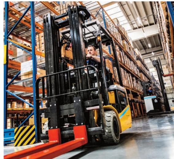
▲ Für die Installation eines typischen Kontrollwiegeverfahrens werden Gabelstapler und Elektrohubwagen mit Ravas-Waagen ausgestattet, die in die Gabelzinken integriert ist. Die Gewichtsanzeige auf dem Stapler ist mit einem WiFi-Modul ausgestattet, um mit dem TMS des Kunden zu kommunizieren.
