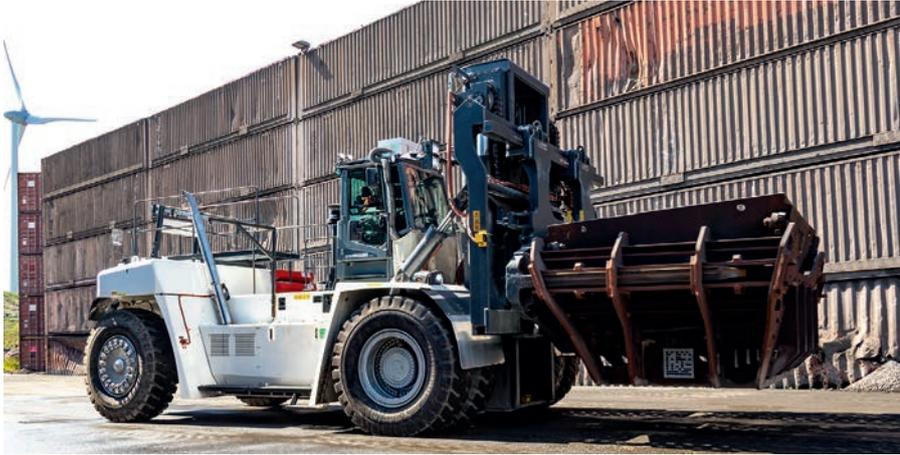
▲ Ein Kalmar-Stapler transportiert den mit Schlacke gefüllten Skip zur Ablagestelle. Angetrieben von der Hydraulik des großen Staplers wird das 60T391-Anbaugerät von Kaup dort gedreht und bei etwa 90° entleert sich die tonnenschwere heiße Schlacke auf den Boden.
