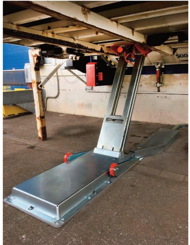
▲ Mit der automatischen Kipp- und Abstützevorrichtung Stopbodies von Expresso lassen sich freistehende Wechselcontainer sicher und unverrückbar vor der Laderampe positionieren.
