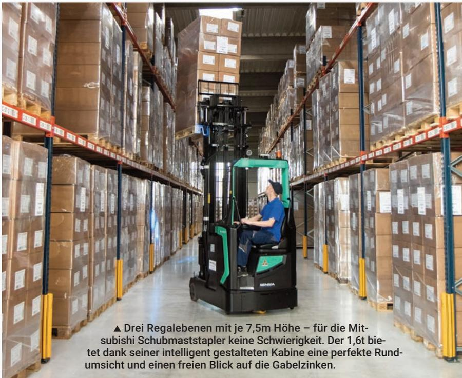
▲ Drei Regalebene mit je 7,5m Höhe – für die Mitsubishi Schubmaststapler keine Schwierigkeit. Der 1,6t bietet dank seiner intelligent gestalteten Kabine eine perfekte Rundumsicht und einen freien Blick auf die Gabelzinken.
