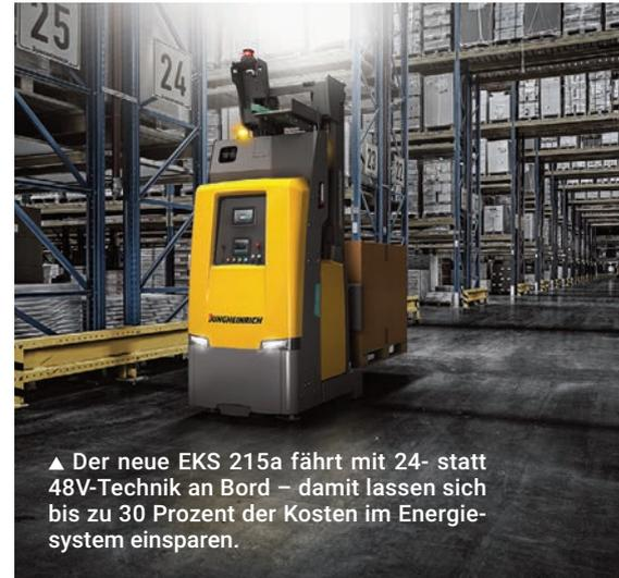
▲ Der neue EKS 215a fährt mit 24- statt 48V-Technik an Bord – damit lassen sich bis zu 30 Prozent der Kosten im Energiesystem einsparen.
