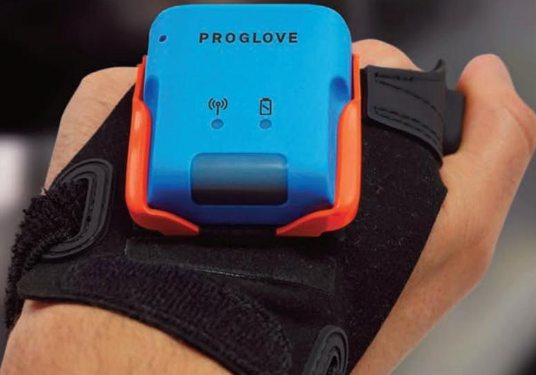
◀ LEO, der neue Scanner von ProGlove, bringt gerade einmal 35g auf die Waage.
