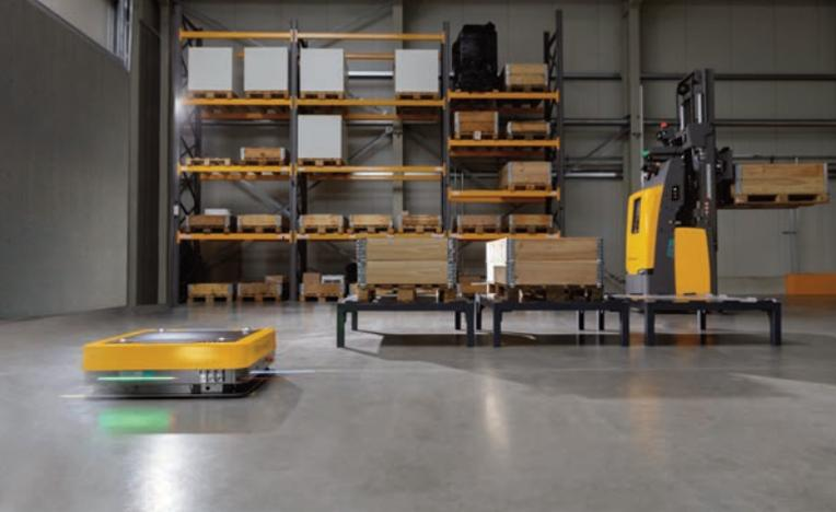
▲ Jungheinrich zeigt sein breites Portfolio an automatischen Lagersystemen und Mobile Robots. Darunter auch die jüngste Erweiterung im Bereich der Fahrerlosen Transportsysteme (FTS), der Autonomous Mobile Robot (AMR): Arculee.
