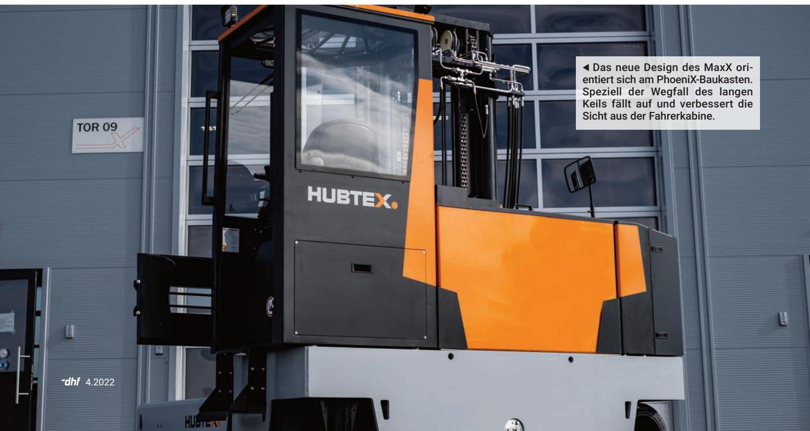
◀ Das neue Design des MaxX orientiert sich am Phoenix-Baukasten. Speziell der Wegfall des langen Keils fällt auf und verbessert die Sicht aus der Fahrerkabine.
