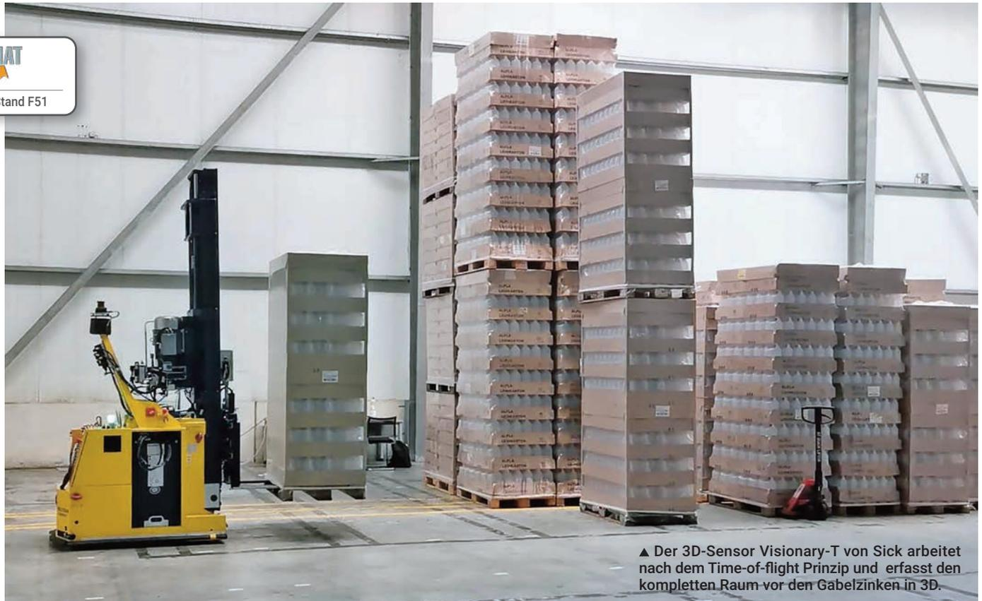
▲ Der 3D-Sensor Visionary-T von Sick arbeitet nach dem Time-of-flight Prinzip und erfasst den kompletten Raum vor den Gabelzinken in 3D.
