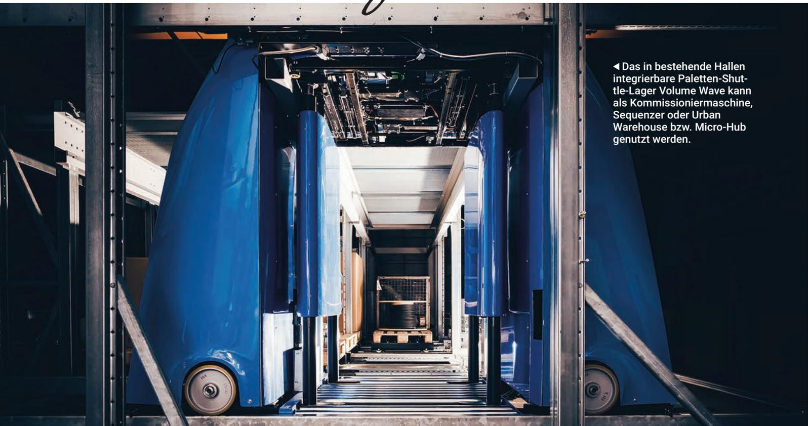
◀ Das in bestehende Hallen integrierbare Paletten-Shuttle-Lager Volume Wave kann als Kommissioniermaschine, Sequenzer oder Urban Warehouse bzw. Micro-Hub genutzt werden.
