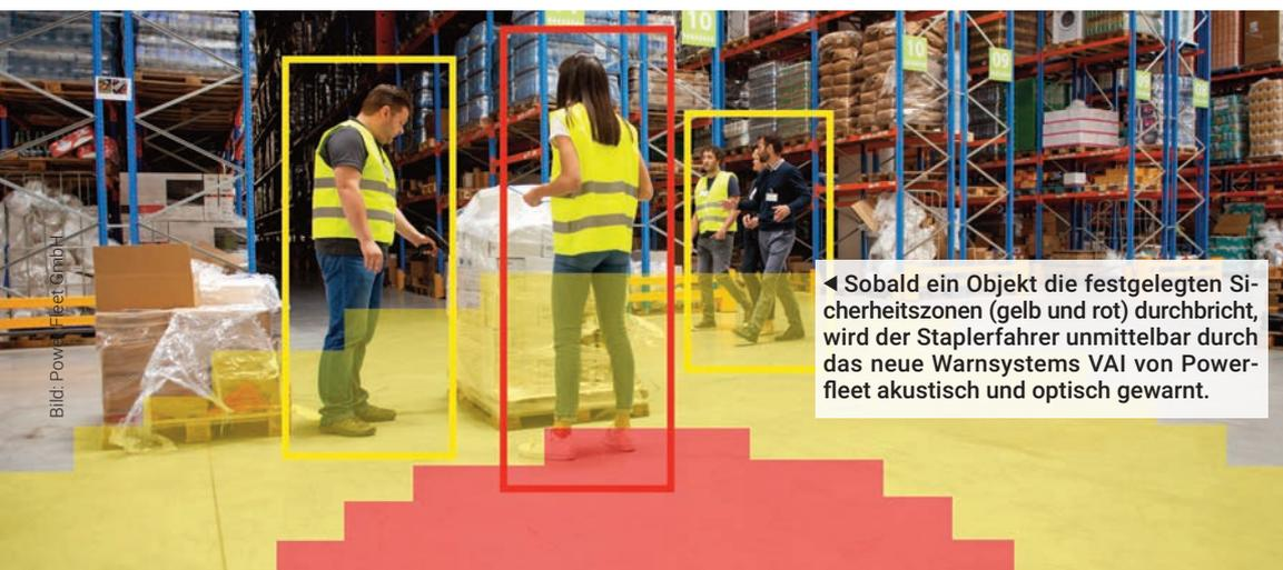
◀ Sobald ein Objekt die festgelegten Sicherheitszonen (gelb und rot) durchbricht, wird der Staplerfahrer unmittelbar durch das neue Warnsystems VAI von Powerfleet akustisch und optisch gewarnt.
