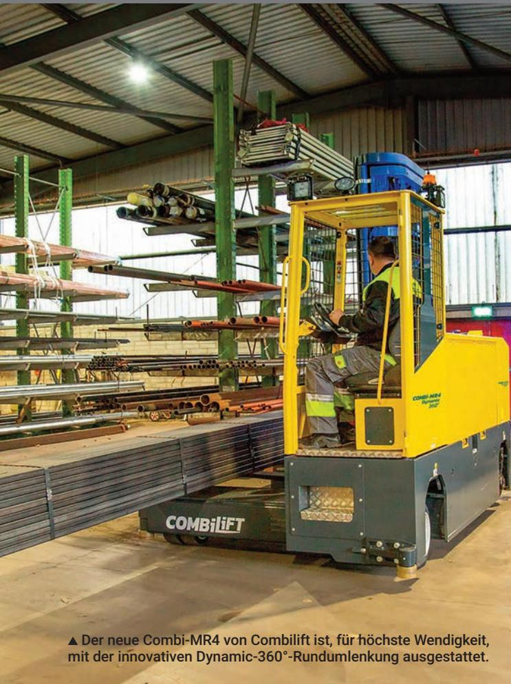
▲ Der neue Combi-MR4 von Combilift ist, für höchste Wendigkeit, mit der innovativen Dynamic-360°-Rundumlenkung ausgestattet.
