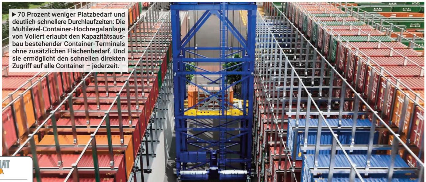
► 70 Prozent weniger Platzbedarf und deutlich schnellere Durchlaufzeiten: Die Multilevel-Container-Hochregalanlage von Vollert erlaubt den Kapazitätsausbau bestehender Container-Terminals ohne zusätzlichen Flächenbedarf. Und sie ermöglicht den schnellen direkten Zugriff auf alle Container – jederzeit.
