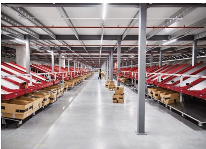
▲ Flexibles Layout: Die Anlage besteht aus zwei parallelen Sortiersektionen mit insgesamt 342 Schalen und 205 Rutschen.
