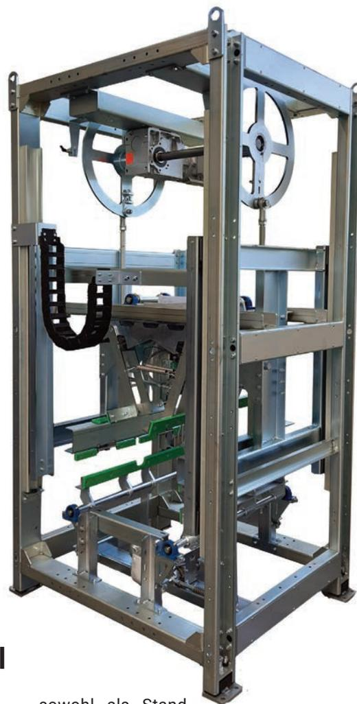
sowohl als Stand Alone-Lösung als auch zur Integration in bestehende Materialfluss-Anlagen konzipiert werden. Die Behälteraufrichter werden individuell an die eingesetzten Kisten und die Anforderungen der Kunden angepasst. So ermöglicht die flexible Konstruktion der Anlagen beispielsweise das parallele Aufrichten von zwei Boxen in einem Arbeitsgang. Auch anders konstruierte Behälter – wie sie beispielsweise in den USA oder Kanada eingesetzt werden – kann die Anlage problemlos fahren.
