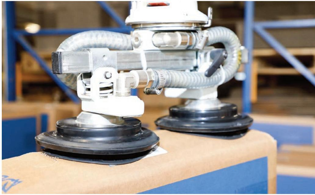
▲ Der Doppelsauggreifer ist mit zwei Balgsaugern ausgerüstet. Diese gleichen auch kleine Unebenheiten in der Oberfläche aus und ermöglichen beschädigungsfreies Greifen.
