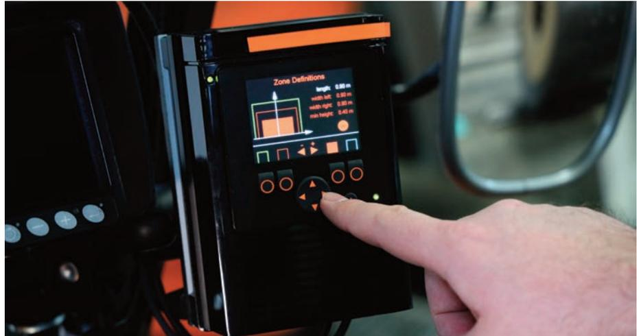
▲ In einer erweiterten Parametrierung lassen sich verschiedene Warnzonen festlegen, die bestimmte Ausgangssignale schalten.
