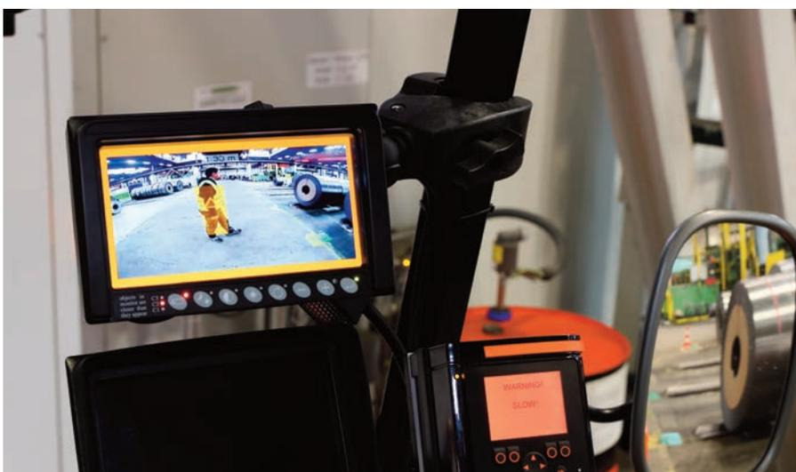
▲ Auf dem Monitor sieht der Fahrer den Rückbereich des Staplers. Farblich abgestufte Rahmen markieren das Objekt im Fahrweg und lösen weitere Warnsignale bis hin zum Not-Stopp aus.
