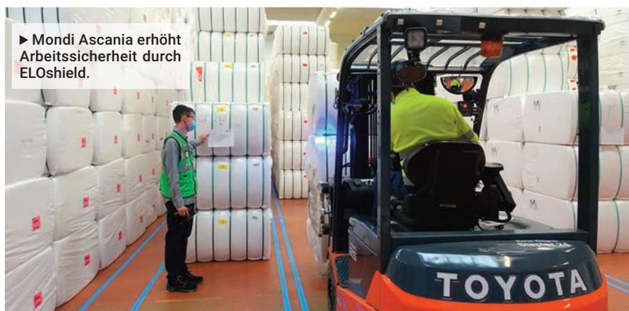
stapler in Aschersleben damit auszustatten. ELOshield erkennt automatisch, wenn eine Person oder ein Stapler in den Gefahrenbereich eines Gabelstaplers gerät. Bei Mondi besteht ELOshield aus jeweils zwei Bestandteilen, die über Funksignale miteinander verbunden sind. Das Staplermodul wird gut sichtbar in der Fahrerkabine des Flurförderzeugs installiert und das Personenmodul, etwa so groß wie ein Smartphone, das Mitarbeiter mit einem Armgurt direkt an ihrem Körper befestigen können.
