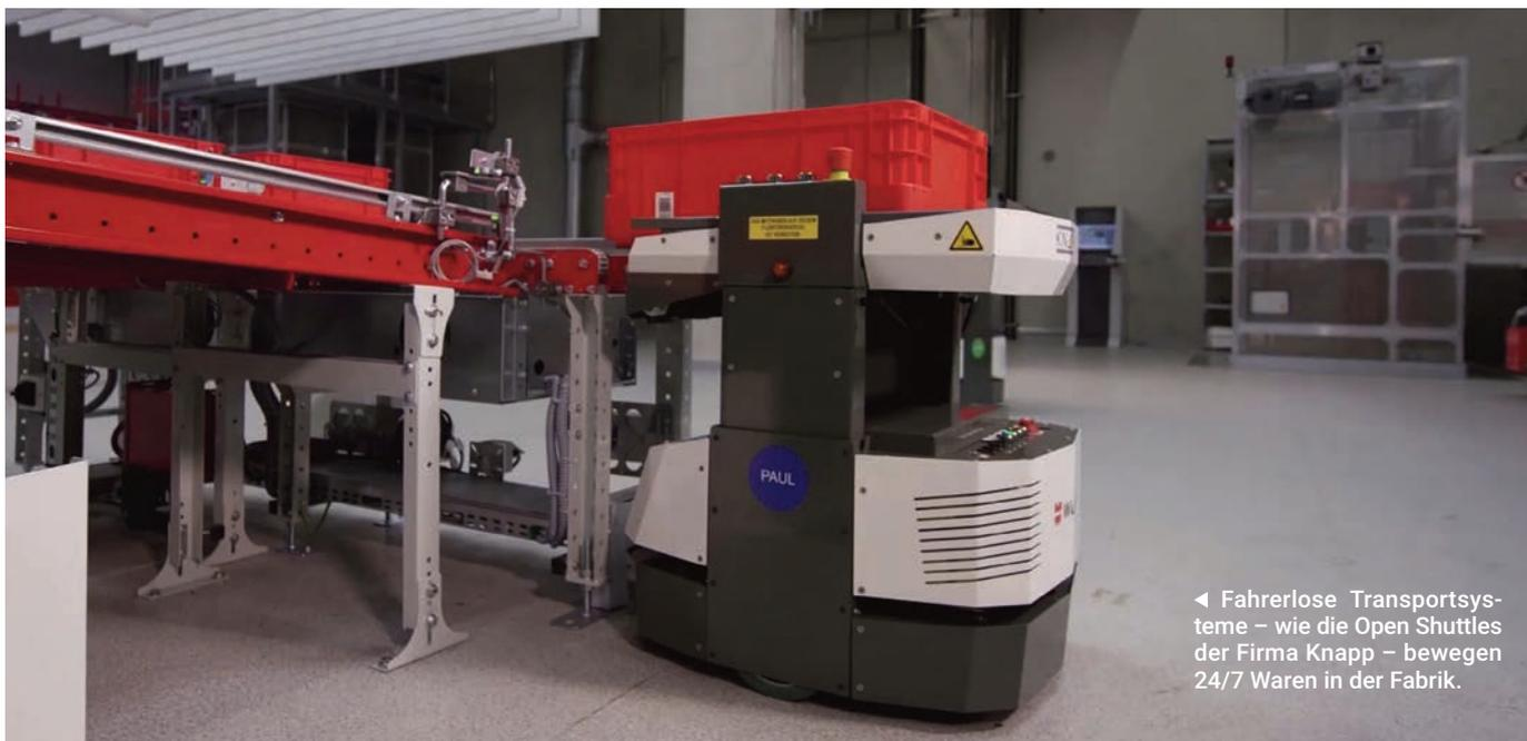
◀ Fahrerlose Transportsysteme – wie die Open Shuttles der Firma Knapp – bewegen 24/7 Waren in der Fabrik.
