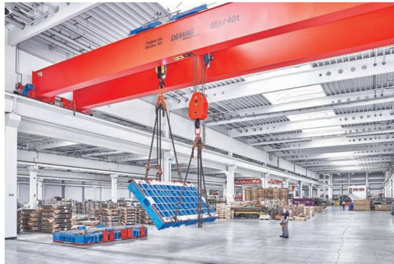
▲ Im Zuge der Erweiterung des Universalkranprogramms hat Demag die Option 'Lastwenden' so weit standardisiert, dass sie bei Universalkranen mit zwei Hubwerken eine wesentlich geringere individuelle Engineering-Leistung erfordert.
