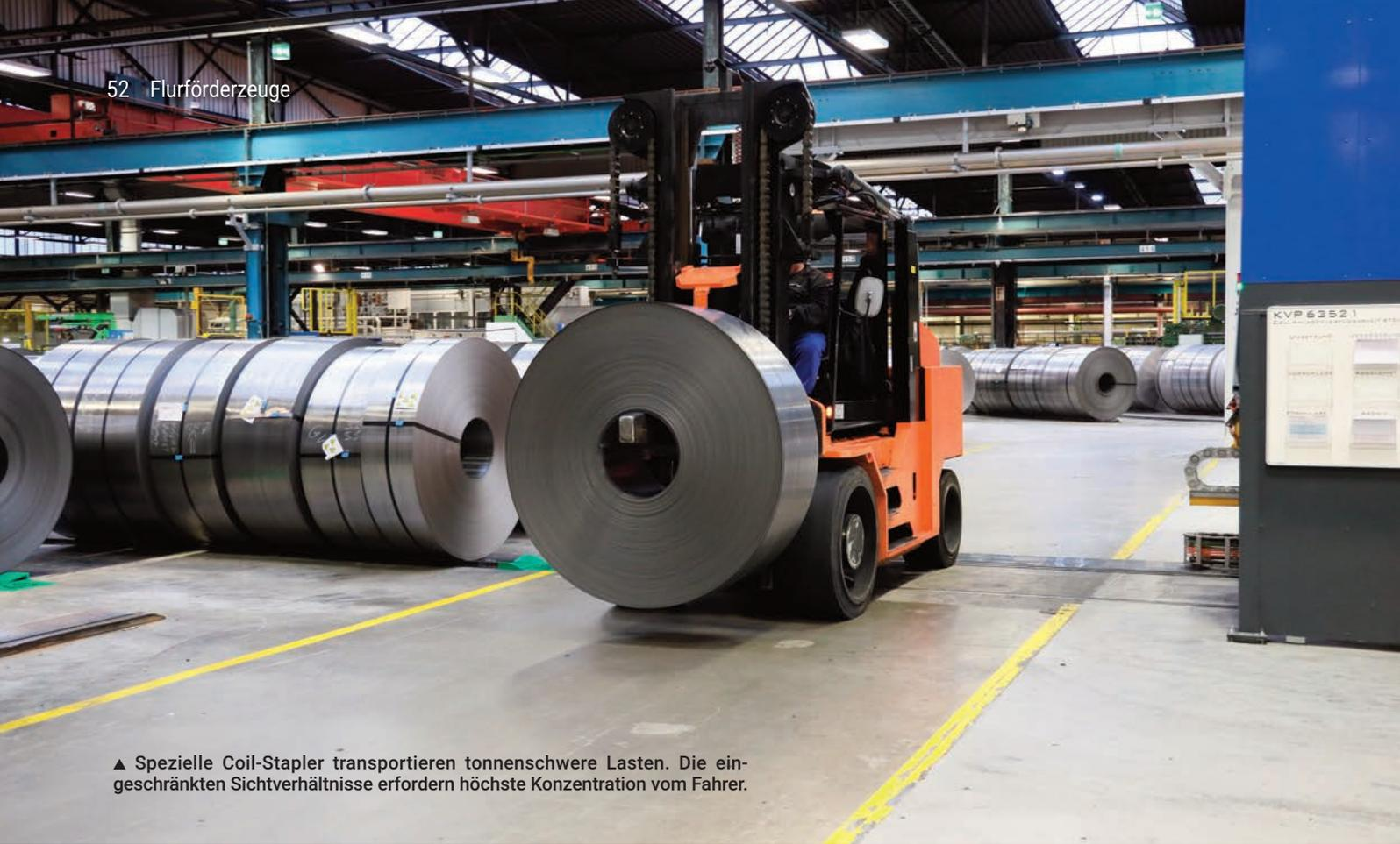
▲ Spezielle Coil-Stapler transportieren tonnenschwere Lasten. Die eingeschränkten Sichtverhältnisse erfordern höchste Konzentration vom Fahrer.
