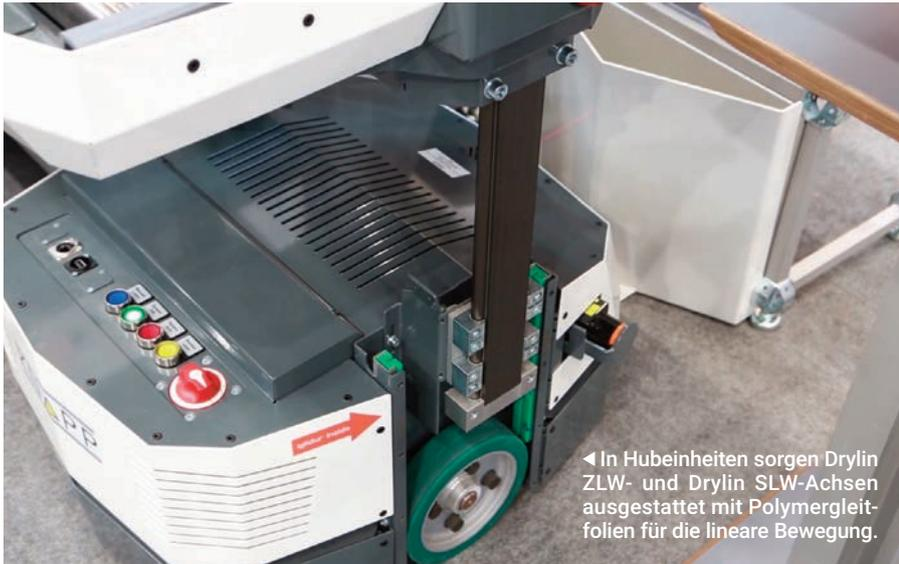
◀ In Hubeinheiten sorgen Drylin ZLW- und Drylin SLW-Achsen ausgestattet mit Polymergleitfolien für die lineare Bewegung.
