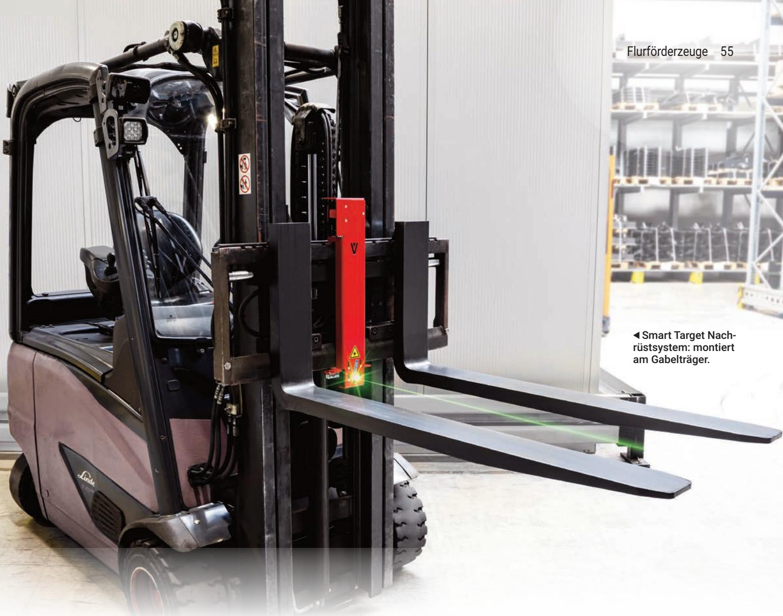
◀ Smart Target Nachrüstsystem: montiert am Gabelträger.
