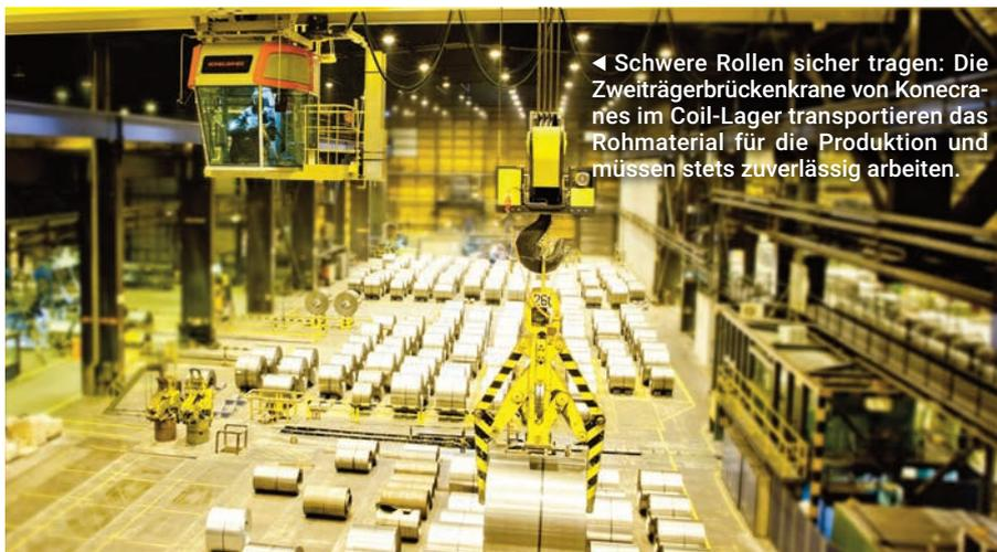
◀ Schwere Rollen sicher tragen: Die Zweiträgerbrückenkrane von Konecranes im Coil-Lager transportieren das Rohmaterial für die Produktion und müssen stets zuverlässig arbeiten.
