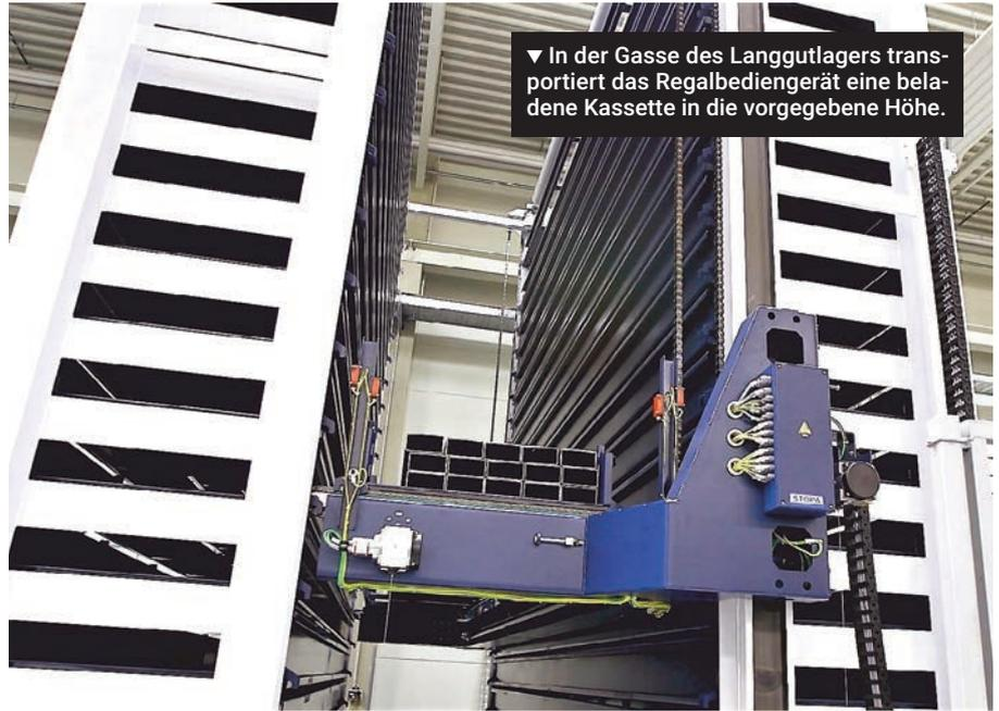
▼ In der Gasse des Langgutlagers transportiert das Regalbediengerät eine beladene Kasse in die vorgegebene Höhe.
