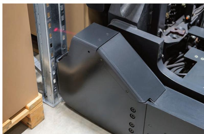
▲ Der Regal-Anfahrtschutz-Sensor für Schubmaststapler von Linde Material Handling detektiert Gegenstände, die sich fokussiert im Lichtstrahl vor ihnen befinden. Wird ein Hindernis erkannt, bremst das Assistenzsystem den Stapler dynamisch ab, ein Schaden wird somit verhindert.
