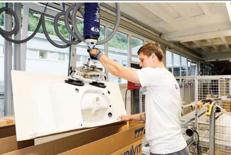
Duravit legt nicht nur viel Wert auf optische Perfektion, sondern auch auf ergonomische Handhabungsprozesse in der Produktion. Um die formschönen, aber bis zu 35kg schweren Waschtische aus Keramik in Kartons zu verpacken, setzt Duravit auf Vakuum-Schlauchheber aus dem Hause Schmalz.
