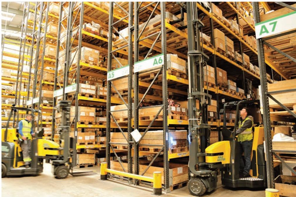
▲ Der neue AME-OP ist in verschiedenen Varianten erhältlich, mit Tragfähigkeiten von 1.500 bis 2.500kg, Hubhöhen von bis zu 12,1m und kann in Gangbreiten von lediglich 1.650mm arbeiten.
