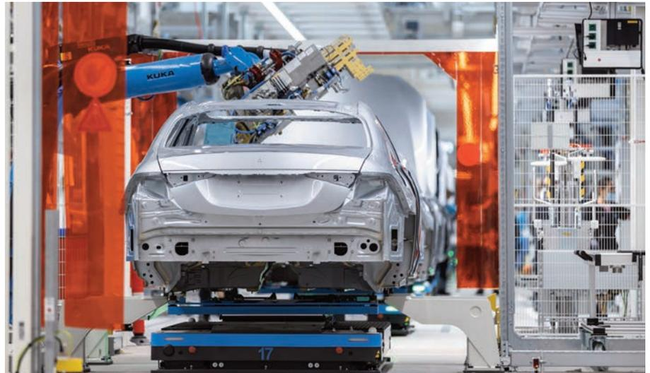
▲ Eine Pkw-Karosserie wird auf einem Vision E-FTF von dpm Daum + Partner Maschinenbau in eine Roboterzelle eingefahren.
