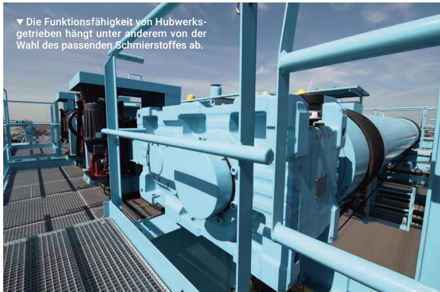
▼ Die Funktionsfähigkeit von Hubwerksgetrieben hängt unter anderem von der Wahl des passenden Schmierstoffes ab.
