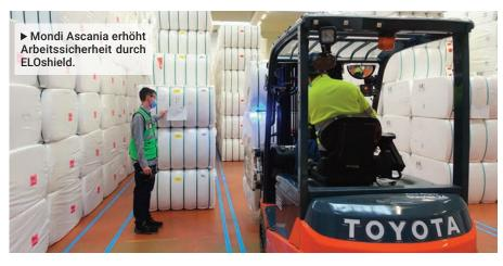
stapler in Aschersleben damit auszustatten. ELOshield erkennt automatisch, wenn eine Person oder ein Stapler in den Gefahrenbereich eines Gabelstaplers gerät. Bei Mondi besteht ELOshield aus jeweils zwei Bestandteilen, die über Funksignale miteinander verbunden sind. Das Staplermodul wird gut sichtbar in der Fahrerkabine
