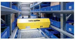
mehrfachtief in Behältern oder Tablaren mit den Grundmaßen 600x400 bzw. 650x450mm und bis zu 70kg Gewicht. Das PSB Microstore ist als Stand-alone-System konzipiert. Über ein Terminal am Kommissionier-Arbeitsplatz werden sowohl die Einund Auslagerung gesteuert als auch die Bestands- bzw. Benutzerverwaltung abgewickelt. Mit einer optionalen Schnittstelle kann das Kompaktlager auch in eine bestehende Systemlandschaft eingebunden werden. www.psb-gmbh.de
