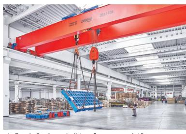
▲ Im Zuge der Erweiterung des Universalkranprogramms hat Demag die Option 'Lastwenden' so weit standardisiert, dass sie bei Universalkranen mit zwei Hubwerken eine wesentlich geringe individuelle Engineering-Leistung erfordert.
