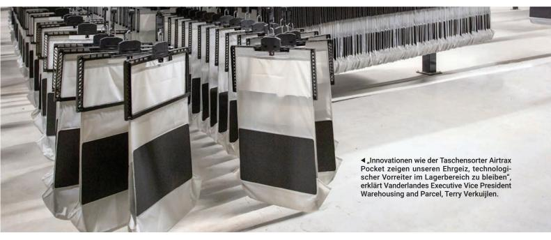
Vanderlande installierte einen hochmodernen Taschensorter Airtrax Pocket bei De Bijenkorf in Tilburg, Niederlande. Die Omni-Channel-Lösung ist jetzt vollständig einsatzbereit und unterstützt vor Ort drei Bereiche: B2C-Aufträge, B2B-Filialbestellungen, die 'Schnelldreher' lagern, sowie E-Commerce-Rückläufer im Lagerbereich.
