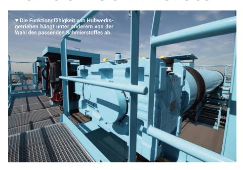
Hubwerksgetriebe sind eine bestimmende Komponente industrieller Krananlagen. Von ihrer Funktionsfähigkeit hängt nicht nur die Verfügbarkeit der Gesamtanlage ab, sondern auch die Sicherheit der Mitarbeiter. Ein Konstruktionselement, das die Gesamtperformance des Getriebes wesentlich beeinflusst, ist der Schmierstoff. Wird ein Öl geringer Qualität verwendet, kann ein 'Wartungsgraben' entstehen, der hohe Kosten verursacht. Folgende Praxistipps sorgen dafür, dass es gar nicht erst soweit kommt.
