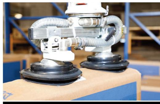
▲ Der Doppelsauggreifer ist mit zwei Balgsaugern ausgerüstet. Diese gleichen auch kleine Unebenheiten in der Oberfläche aus und ermöglichen beschädigungsfreies Greifen.
