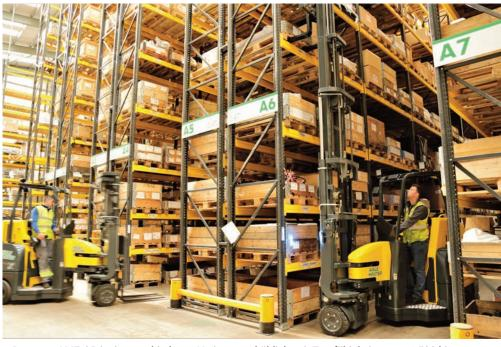
▲ Der neue AME-OP ist in verschiedenen Varianten erhältlich, mit Tragfähigkeiten von 1.500 bis 2.500kg, Hubhöhen von bis zu 12,1m und kann in Gangbreiten von lediglich 1.650mm arbeiten.
