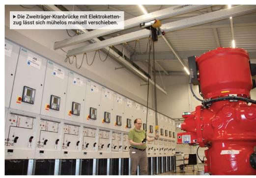
das längs und seitliche Verschieben nicht elektrisch, sondern per Hand. Die GISKB Fahrwerke und Rollapparate mit kugelgelagerten Kunststofflaufrollen sorgen hierbei für einen idealen Leichtlauf der 8,70m langen Kranbrücke.
