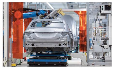
▲ Eine Pkw-Karosse wird auf einem Vision E-FTF von dpm Daum + Partner Maschinenbau in eine Roboterzelle eingefahren.
