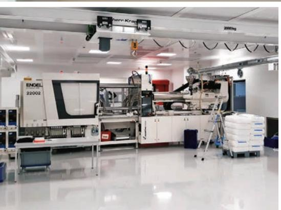
▲ Platzsparenden Konstruktionen lassen sich auch mit Zweiträgerbrückenkränen beispielsweise für Reinräume realisieren. Hier eine Lösung für Weidmann Medical Technology (Schweiz), ausgeführt durch Hausherr Kranservice, einem Systempartner von Stahl Cranesystems.
