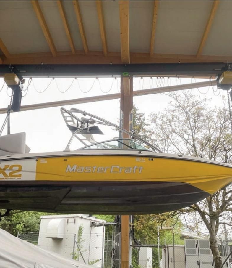
▲ Die Elektrokettenzüge GP2500 sorgen für ein synchrones Heben des Bootes und Motorfahrwerke GMF für das horizontale Verschieben.
