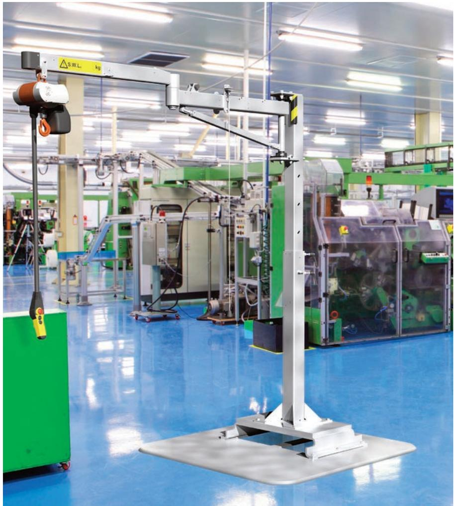
▲ Mobiles Tragwerk MobiArm mit ortsflexibler Bodenplatte.
