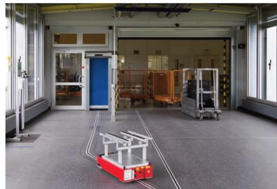
▲ KATE verfolgt die schwarze Linie am Boden, die von einer Ausgabestelle des Hochregallagers bis zur Montagelinie führt.
