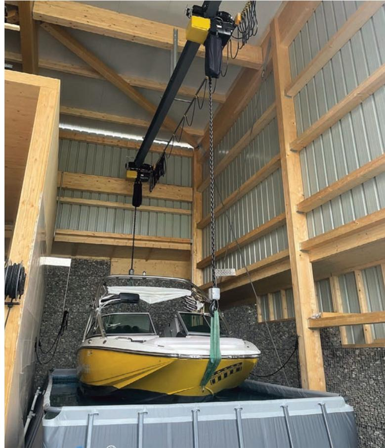
▲ Mittels Funksteuerung lassen sich sämtliche Hub- und Fahrbewegungen kontrollieren und das Boot sorgfältig ins künstliche Becken absetzen.
