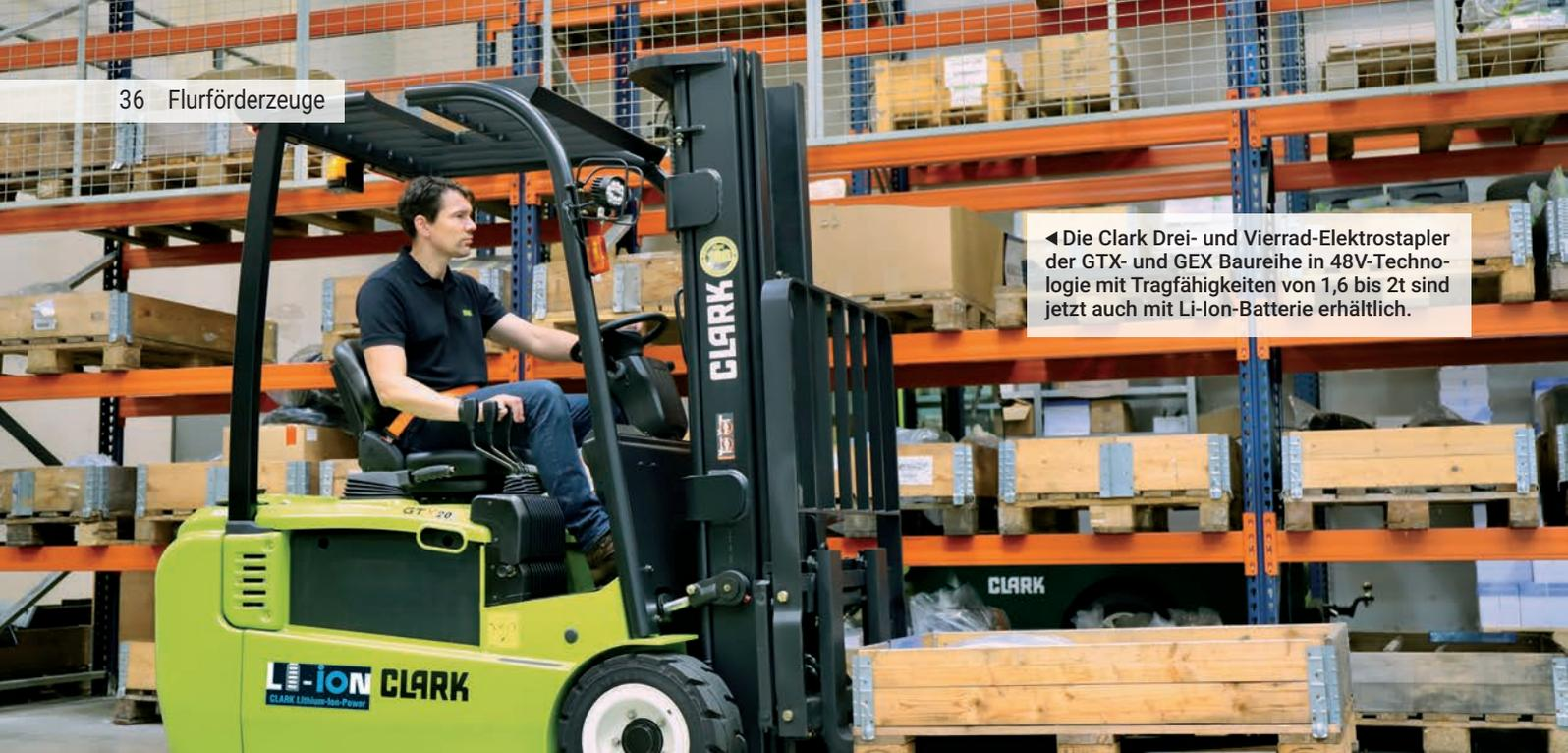
◀ Die Clark Drei- und Vierrad-Elektrostapler der GTX- und GEX Baureihe in 48V-Technologie mit Tragfähigkeiten von 1,6 bis 2t sind jetzt auch mit Li-Ion-Batterie erhältlich.
