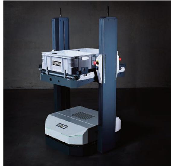
▲ Die Open Shuttles können je nach Ausführung ein oder zwei Behälter, Kartons oder Trays mit Dimensionen bis zu 800x600mm und insgesamt bis zu 100kg transportieren.
