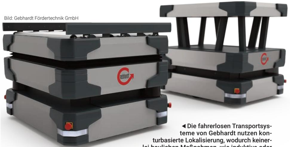
◀ Die fahrerlosen Transportsysteme von Gebhardt nutzen konturbasierte Lokalisierung, wodurch keinerlei bauliche Maßnahmen, wie induktive oder optische Spurführung, innerhalb der Halleninfrastruktur nötig werden.
