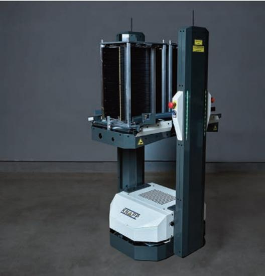
▲ Mit der integrierten Breitenverstellung passt sich das Lastaufnahmemittel des Open Shuttles auf den Ladungsträger an und unterstützt damit beim Transport von Leiterplatten-Magazinen in der Elektronik-Branche.
