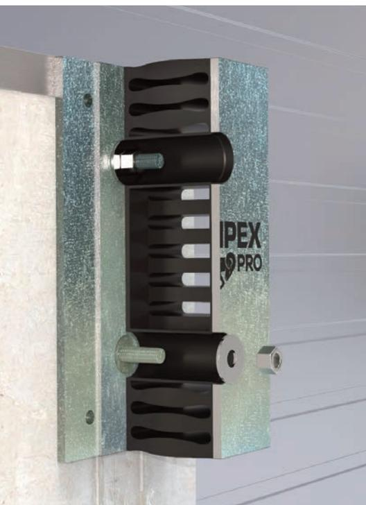
▲ Einfache Montage: Da die Muttern direkt auf die Stahlplatte drücken, ist die Verbindung zuverlässiger als bei den meisten Gummipuffern mit langen Befestigungsbolzen und einer Befestigung mit Unterlegscheiben auf dem Gummimaterial.
