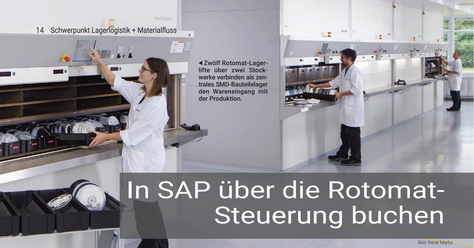
◀ Zwölf Rotomat-Lagerlifte über zwei Stockwerke verbinden als zentrales SMD-Bauteilelager den Wareneingang mit der Produktion.
