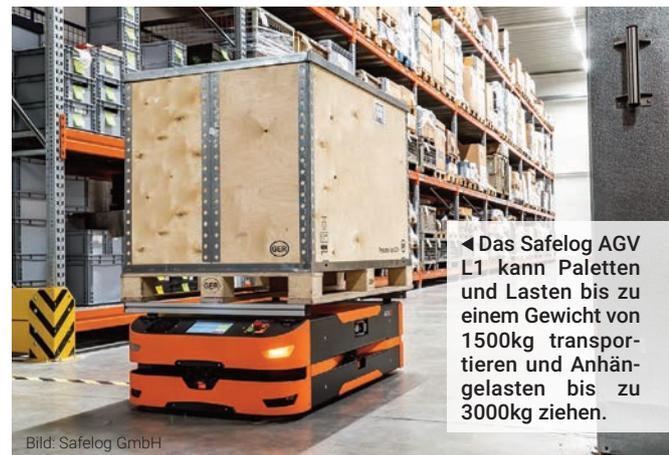
◀ Das Safelog AGV L1 kann Paletten und Lasten bis zu einem Gewicht von 1500kg transportieren und Anhängelasten bis zu 3000kg ziehen.
