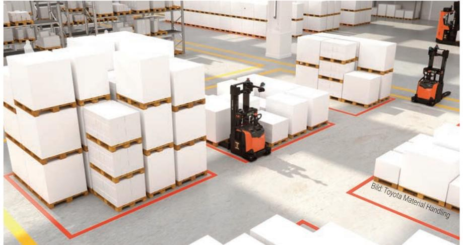
▲ Für eine präzise Navigation im Lager sind die Fahrzeuge mit zwei genauen und anpassungsfähigen Navigationstechnologien erhältlich: der reflektorenbasierten und der natürlichen Navigation. Eine Kombination beider Technologien, als Dual Navigation, ist ebenfalls möglich.
