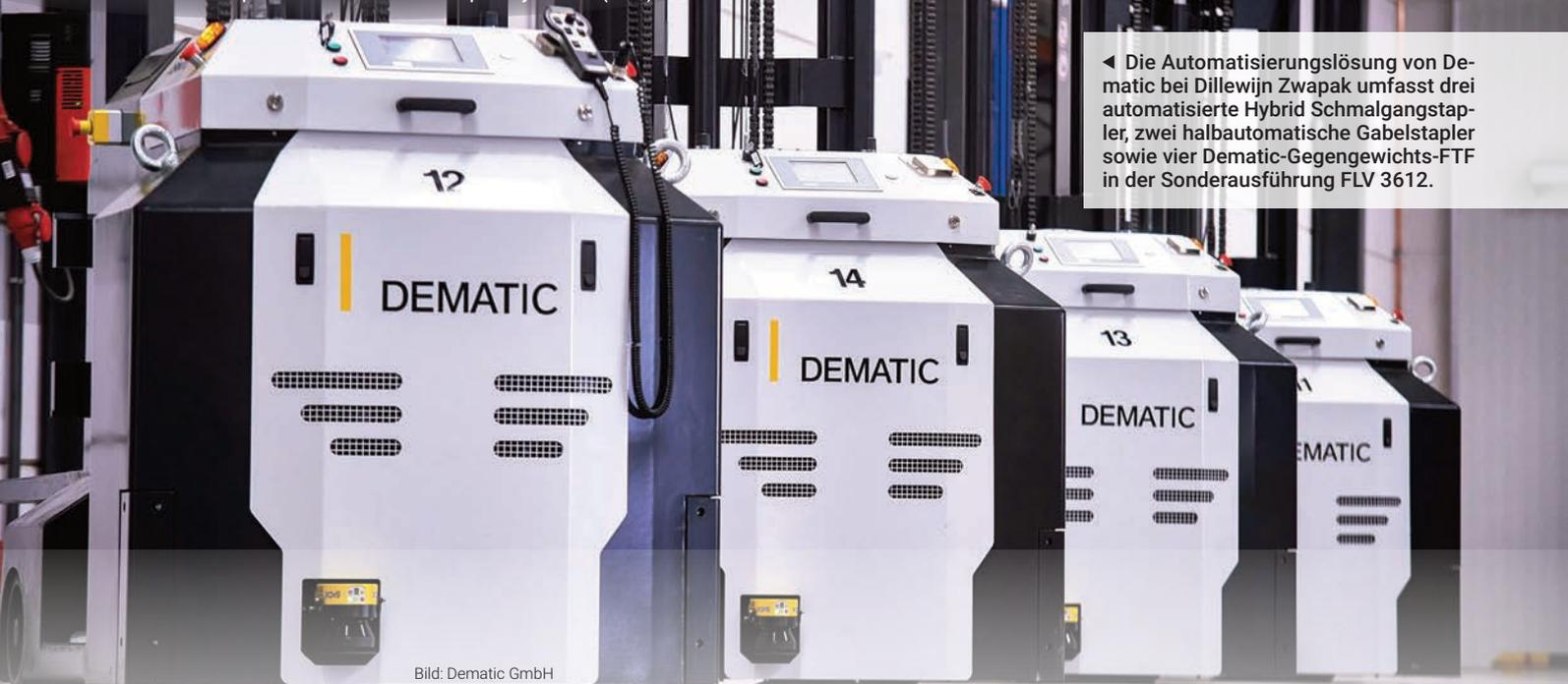
◀ Die Automatisierungslösung von Dematic bei Dillewijn Zwapak umfasst drei automatisierte Hybrid Schmalgangstapler, zwei halbautomatische Gabelstapler sowie vier Dematic-Gegengewichts-FTF in der Sonderausführung FLV 3612.
