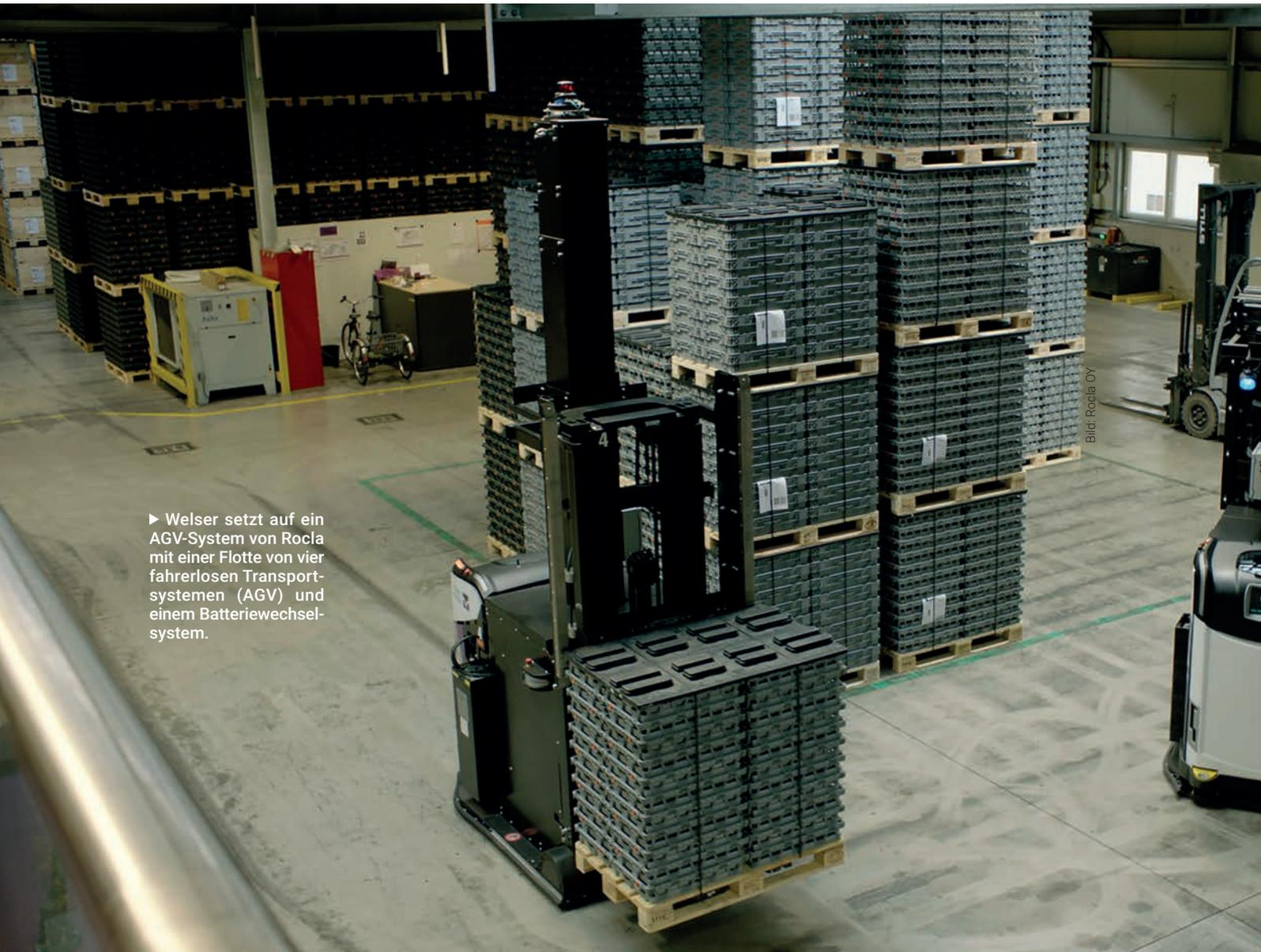
► Welser setzt auf ein AGV-System von Rocla mit einer Flotte von vier fahrerlosen Transportsystemen (AGV) und einem Batteriewechselsystem.
