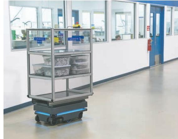
▲ Mittels intelligenter Sensortechnologie und Software navigiert der MiR200 bei Argon völlig autonom und sicher zwischen dem Lager und dem Produktionsbereich. Die Roboter bewegen pro Fahrt eine Ladung von bis zu einer Tonne.
