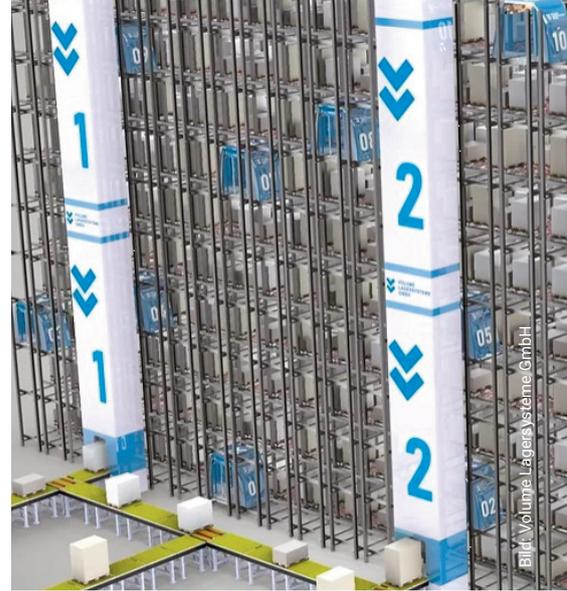
▲ Das frei konfigurierbare und an alle gängigen Lagerverwaltungssysteme koppelbare Shuttle-Lager von Volume Lagersysteme, das auch als Sequenzer genutzt werden kann, lässt sich auch in Bestandsimmobilien integrieren.
