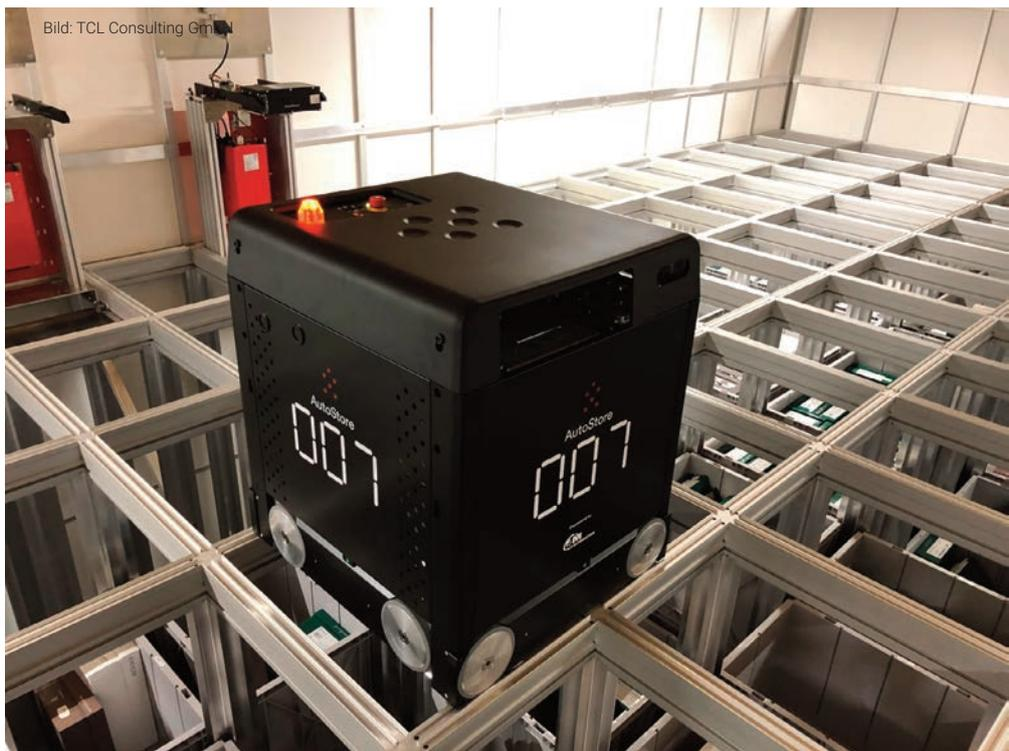
▲ Mit den neuen Robotern der Serie B1 BlackLine können die Einsatzmöglichkeiten des AutoStore-Systems deutlich erweitert werden.
