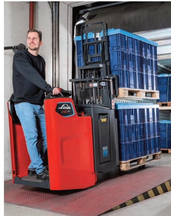
▲ Die neuen Fahrerstandhubwagen von Linde sind schmaler als die transportierten Europaletten. Dadurch helfen sie, Schäden an den Lkw-Transportwänden zu verhindern.
