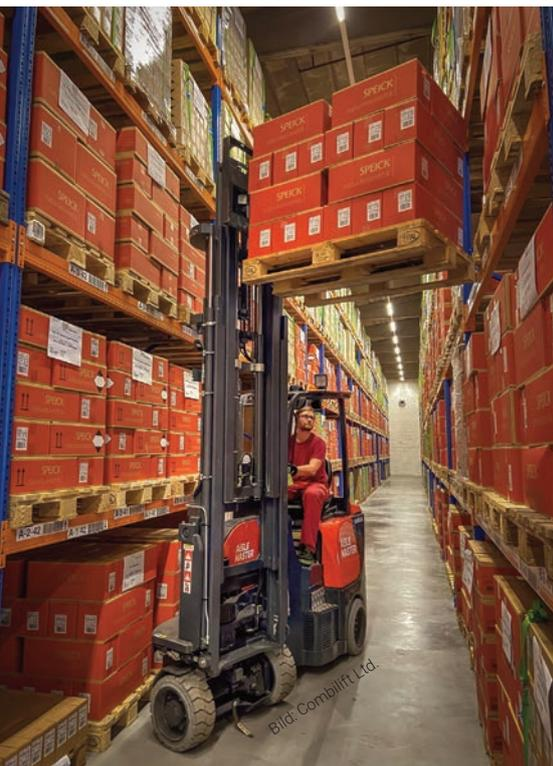
▲ Der Aisle Master vom Typ AM 15SE mit AC-Elektroantrieb hat ein niederes Vorbaugerät, das eine sehr gute Sicht auf die Last gewährleistet und kann als Front- und Schmalgangstapler arbeiten.
