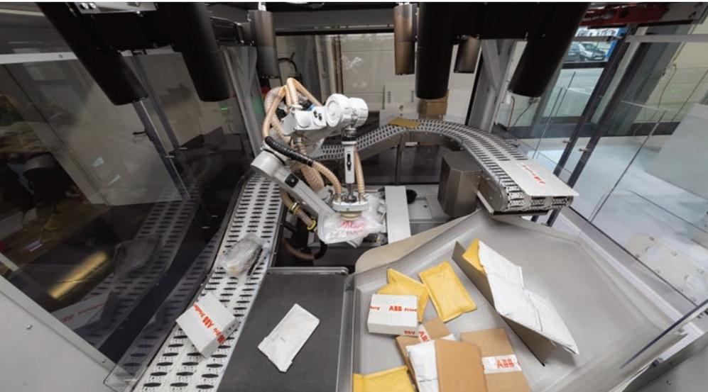
von intralogistischen Prozessen mobile Roboterlösungen. Eine weitere komplexe Anforderung ist das Ent- und Beladen von Containern oder Lkw sowie die Sortierung von Paketen.
