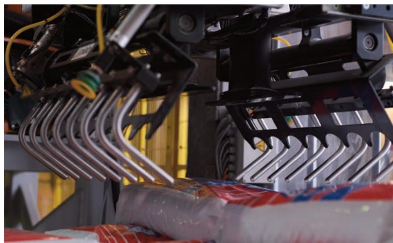
▲ Nach den Greiffingern öffnen sich die Deckplatten. So werden die Paletten fest und formstabil gepackt.
