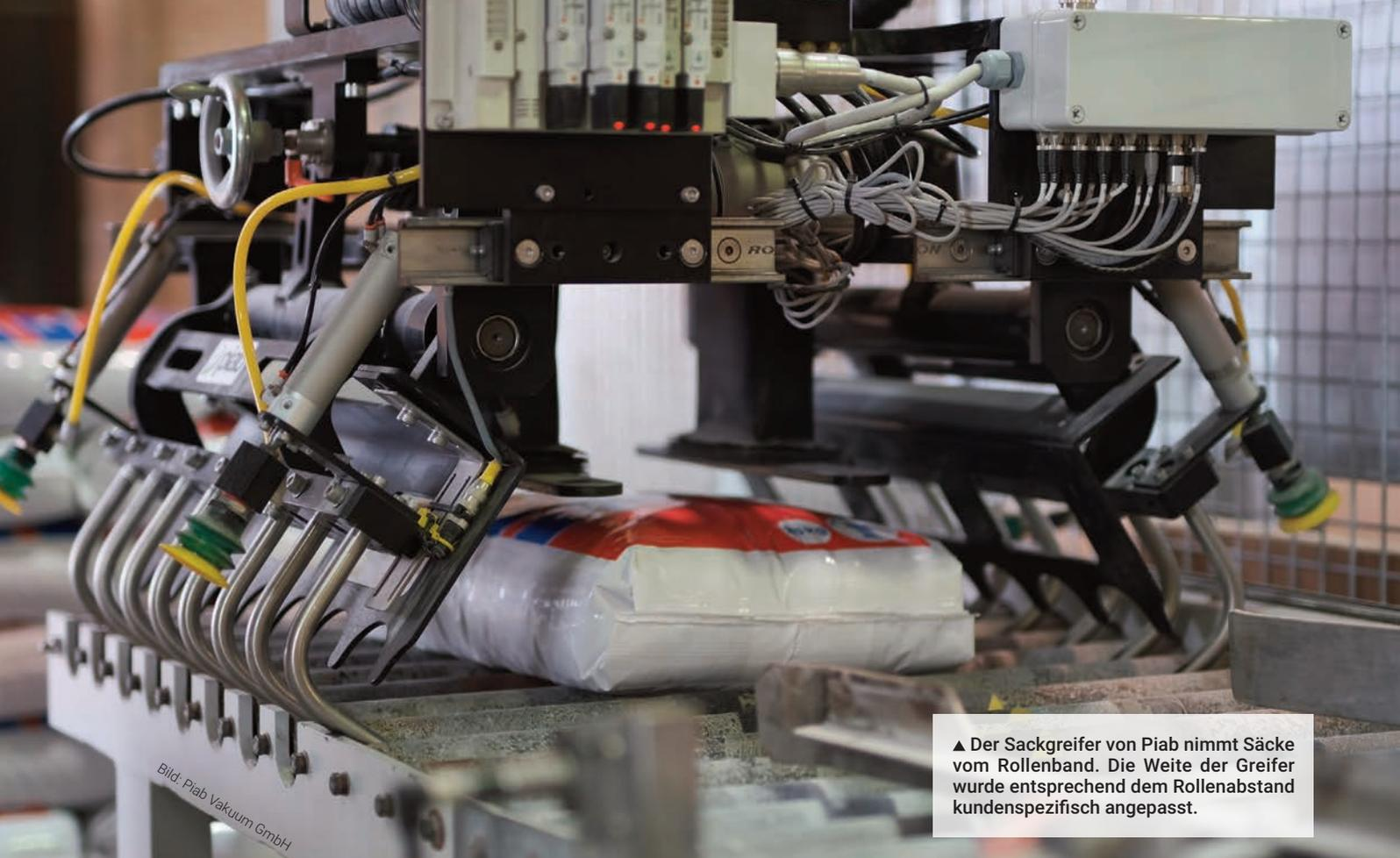
▲ Der Sackgreifer von Piab nimmt Säcke vom Rollenband. Die Weite der Greifer wurde entsprechend dem Rollenabstand kundenspezifisch angepasst.
