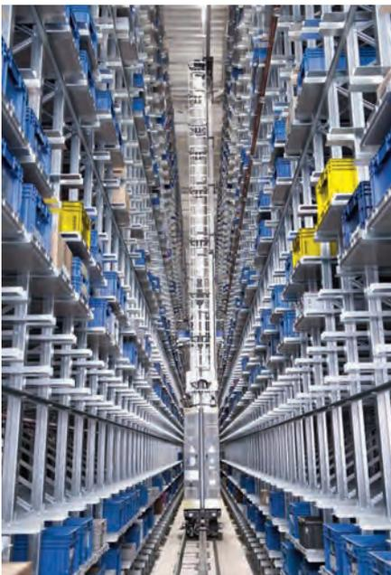
▲ Als innovativstes Gerät am Markt trägt SSI Exyz der Tatsache Rechnung, dass bei der Lagerung von Großladungsträgern der entscheidende Energiebedarf im Hubwerk steckt.
