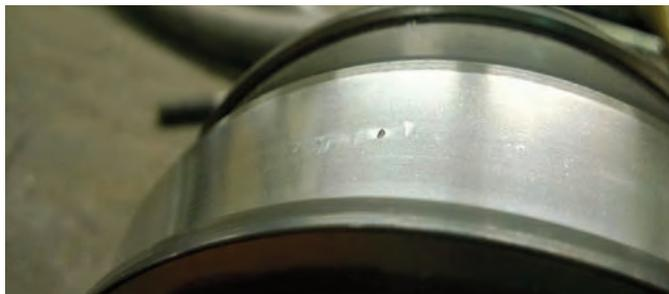
▲ Erkannter Innenringschaden an einem Trommellager
