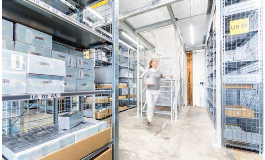
Eine spezielle, als Gitterrost ausgeführte, Bühnenkonstruktion und Verbindungstreppe ermöglichen den Mitarbeitern das schnelle Erreichen der jeweiligen Regalebene und unterstützen bei einer effizienten Regalbedienung und Kommissionierung.
