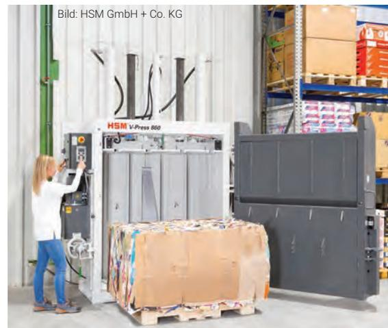
▶ Die HSM V-Press 860 plus B ist auch mit einer Bandstation erhältlich, die den Ballen 4-fach mit Polyesterband umreift und sich für die Verpressung von Kartonagen eignet.
