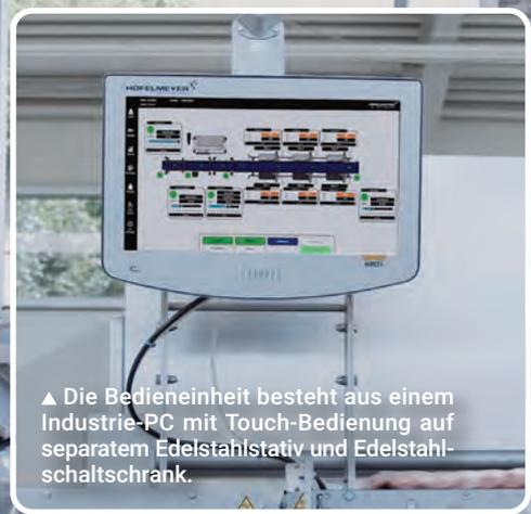
▲ Die Bedieneinheit besteht aus einem Industrie-PC mit Touch-Bedienung auf separatem Edelstahlstativ und Edelstahlschaltschrank.
