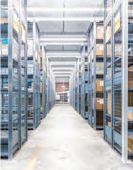
Insgesamt wurden für das Lager 230 Regalrahmen, 1.695 Fachböden Multiplus, 565m<sup>2</sup> Gitterrückwände und Seitenwände, 133m<sup>2</sup> Gitterrostbeläge sowie 142lfm LED-Lichtleisten zum Ausleuchten der Regale montiert.
