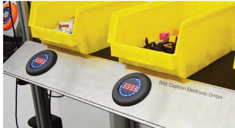
▲ Intelligente und robuste Taster mit Displayfunktion dienen als Schnittstelle zwischen Picker und Backend-IT – wie der smartCAP-Taster, als zentrales Element von oneGRID.
