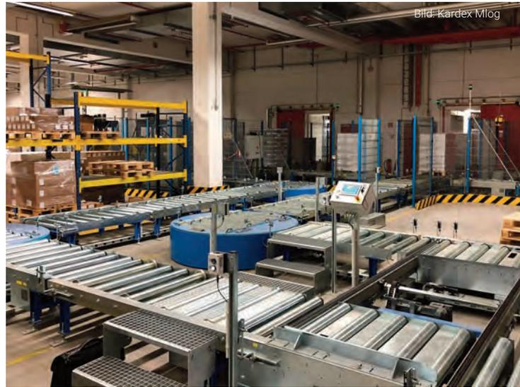
werke und können jeweils bei einer maximalen Hubgeschwindigkeit von 80m/min rund 110 Paletten pro Stunde vom Erdgeschoss in das zweite Obergeschoss transportieren. Der neu installierte Verteilerwagen erreicht bei 100m/min eine Leistung von 120Pal/h. Damit fügen sich die neuen Komponenten optimal in die Bestandsumgebung, deren Durchsatz nicht verändert wurde.
