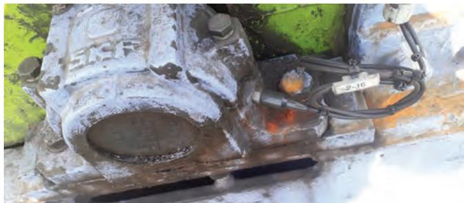
▲ Beschleunigungssensor an einem Trommellager
