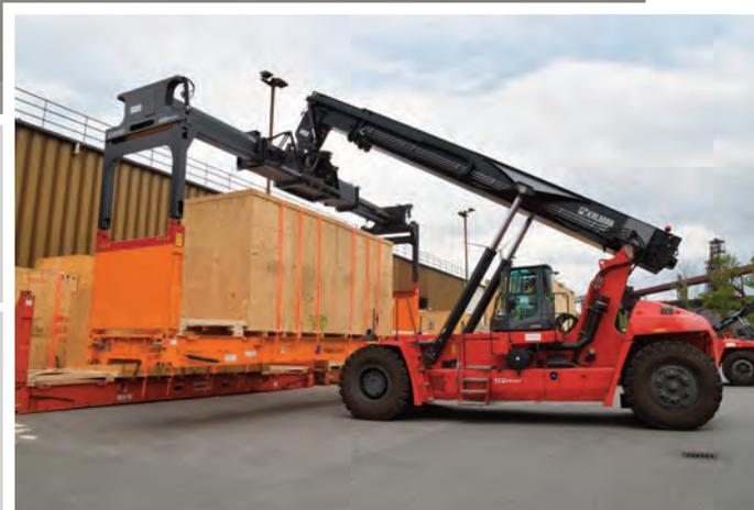
Von der Verpackung einer Maschine bis zur Abwicklung des Versands kompletter Produktionsanlagen – dafür ist Epolog Exportverpackung und Logistik der richtige Ansprechpartner. 2021 wurde die Staplerflotte am Standort Hamburg erneuert. Highlight ist der Kalmar Reachstacker mit Eco-Maschine, die circa 20 Prozent Kraftstoff einspart.
