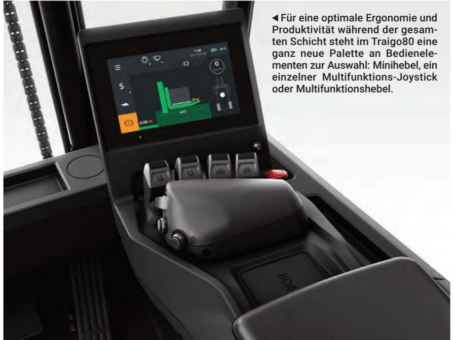
◀ Für eine optimale Ergonomie und Produktivität während der gesamten Schicht steht im Traigo80 eine ganz neue Palette an Bedienelementen zur Auswahl: Minihebel, ein einzelner Multifunktions-Joystick oder Multifunktionshebel.
