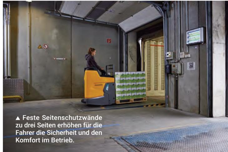
▲ Feste Seitenschutzwände zu drei Seiten erhöhen für die Fahrer die Sicherheit und den Komfort im Betrieb.
