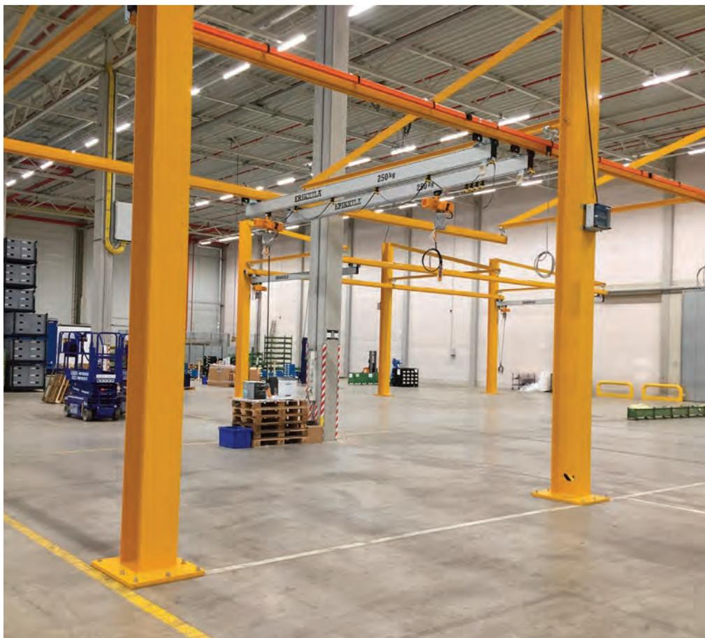
Die Zu- und Abfahrtrichtung der Produkte wird permanent der Auslastung und der Größe der zu handhabenden Produkte angepasst. Die Tragfähigkeit des Halbportalkrans beträgt 250kg je Kranbrücke.
