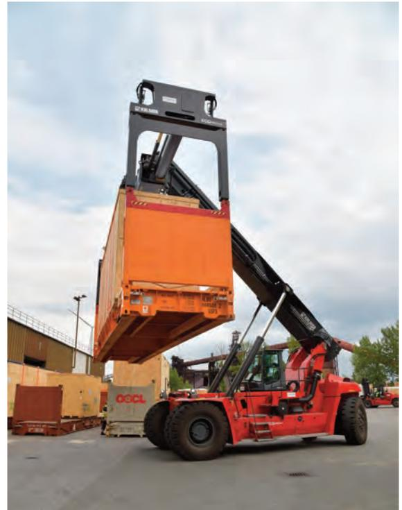
nis noch hinzu. Der neue Eco-Reachstacker verbraucht rund 14,5 l/Stunde bei 2.000 Stunden/Jahr und einer Nutzungsdauer von rund fünf Jahren kommt da eine erhebliche Summe zusammen. Auch die Fahrer schätzen die Maschinen wegen der reduzierten Anfahrtdrehzahl, dem sehr feinfühligem Arbeiten und der proportionalen Hydraulik, die bei allen Bewegungen sehr feinfühlig arbeitet“, so beschreibt der Geschäftsführer seine Eindrücke der neuen Geräte.
