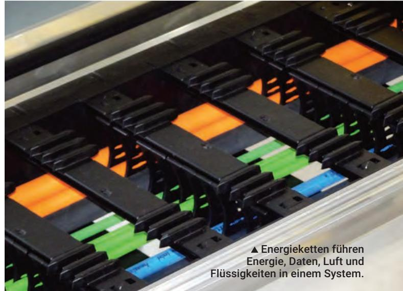
▲ Energieketten führen Energie, Daten, Luft und Flüssigkeiten in einem System.
