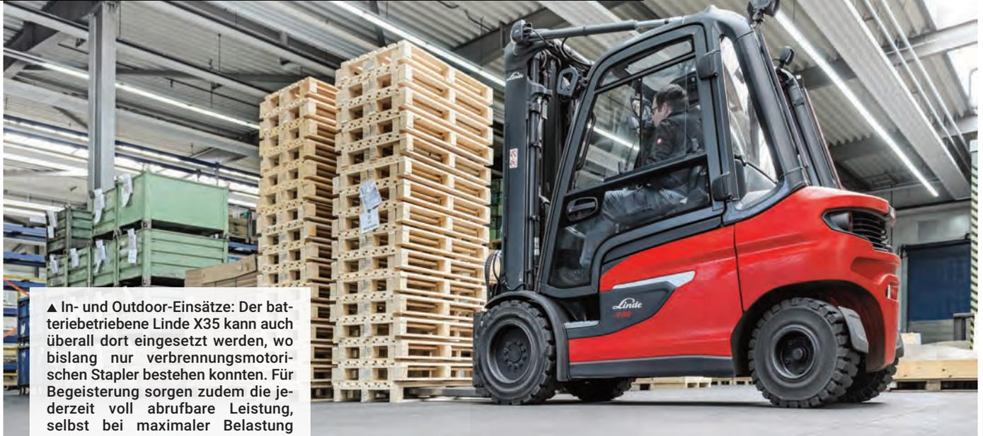
▲ In- und Outdoor-Einsätze: Der batteriebetriebene Linde X35 kann auch überall dort eingesetzt werden, wo bislang nur verbrennungsmotorischen Stapler bestehen konnten. Für Begeisterung sorgen zudem die jederzeit voll abrufbare Leistung, selbst bei maximaler Belastung sowie das Entfallen des sonst üblichen Treibgasflaschenwechsels.
