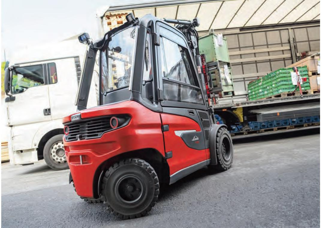
▲ Mehr Sicht, mehr Souveränität, weniger Unfälle: Dank der optimierten Konstruktion von Chassis, Kabine und Mast haben Fahrer des neuen Linde X35 einen noch besseren Blick in alle Richtungen. Für EOT ist dies ein entscheidender Sicherheitsfaktor. Auf der 2.000m<sup>2</sup> großen Logistikfläche wird teils in sehr engen Gängen gearbeitet.
