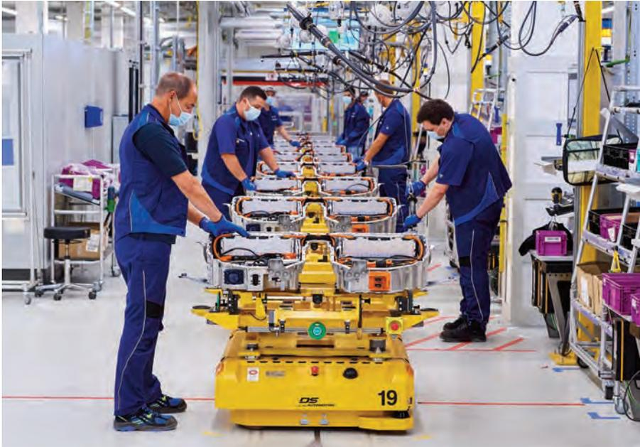
Der Bedarf an Batterien als Schlüsselkomponente der Elektromobilität steigt rasant. Ein deutscher Automobilhersteller baut dafür seine Produktionskapazität in mehreren Schritten auf 500.000 Einheiten pro Jahr aus. Hohe Flexibilität in der Fertigung gewährleisten die Fahrerlosen Transportfahrzeuge (FTS) von DS Automotion.
