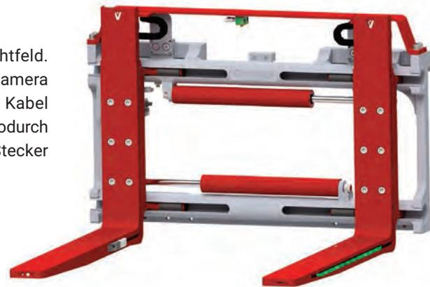
▲ Das Zinkenverstellgerät Typ RZV-G besitzt eine stabile Rundführung, in der die Aufnahme mit den geschraubten Gabelzinken verschoben wird. Der Seitenschub mit Ventilsteuerung ermöglicht den Seitenschub abhängig vom Öffnungsbereich der Zinken. Vorbereitet auch für die Verwendung von Standardgabelzinken nach ISO 2328.
