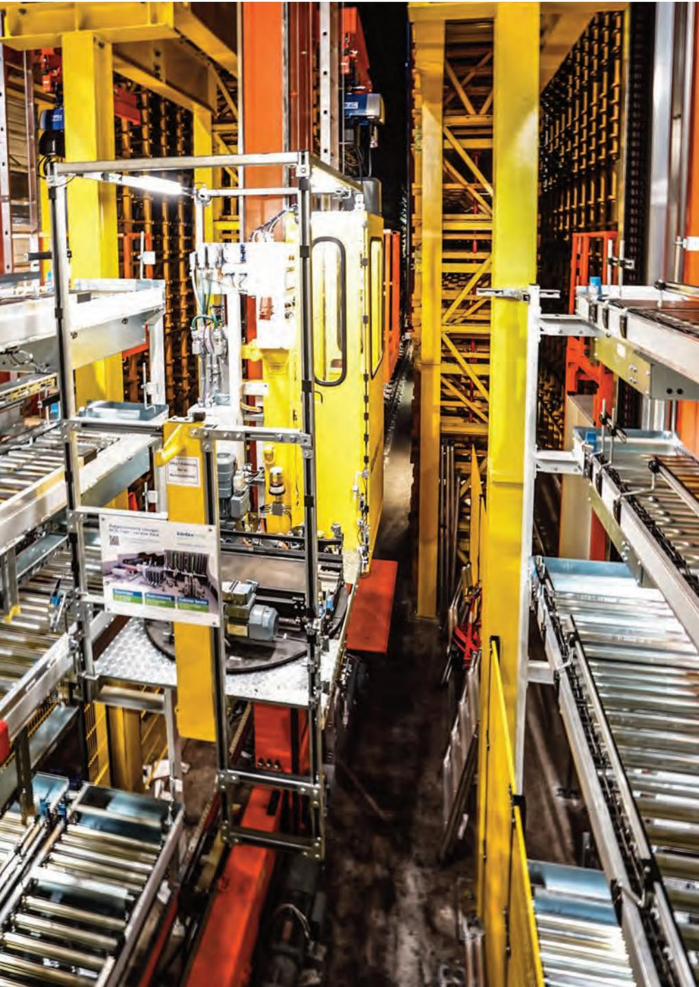
◀ Durch eine anspruchsvolle Erweiterung der Bestandsanlage mit nun sechs RBGs in drei Gassen ist das AKL eines Münchner Lkw- und Busherstellers für weiteres Wachstum gut gerüstet.
