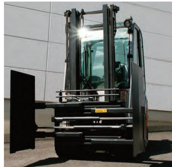
▲ Geräteklammern von Stabau dienen zum palettenlosen Transport von druckempfindlichen Elektrogeräten der Haushalts- und Unterhaltungselektroindustrie in Herstellerwerken und Lagerhäusern.
