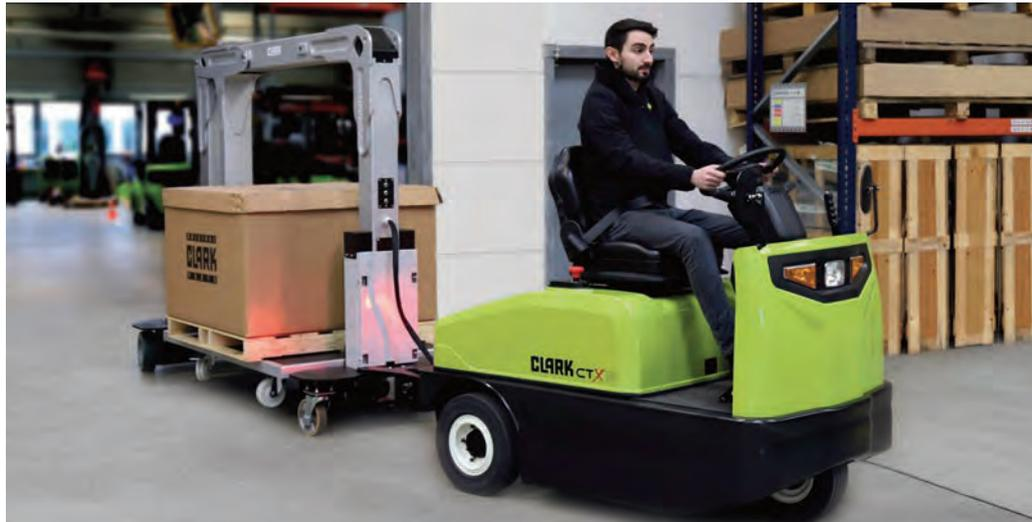
▲ Der Clark Routenzug ist eine All-in-One-Lösung – bestehend aus dem Clark Schlepper CTX40-70 sowie aus den Anhängern CTR01 und CTR02.
