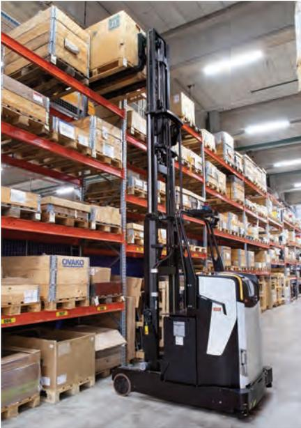
▲ Rocla Automated Reach Truck (ART), der neue fahrerlose Schubmaststapler mit innovativer Software- und Sensor-Technologie.
