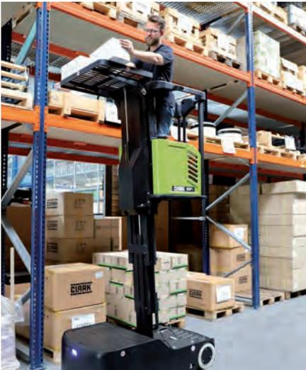
▲ Der COP1 ist ein echtes Multitalent: Das Fahrzeug ist nicht nur äußerst effizient bei der Kommissionierung von Waren, sondern bewährt sich auch dank der hochfahrbaren Arbeitsplattform als Rollleiter oder Arbeitsbühne.
