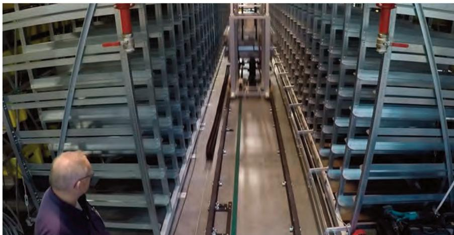
▲ Bei Anwendung in Regalbediengeräten sorgen Autoglide 5-Energieketten zuverlässig für die Übertragung von Energie und Daten.
