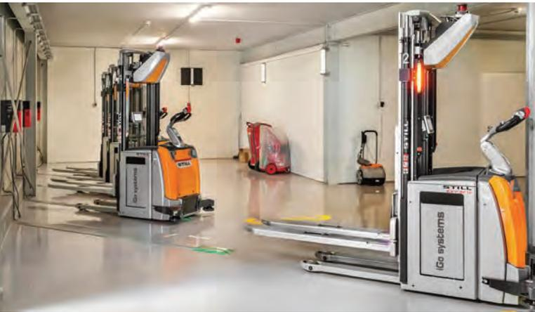
▲ Wird ein Transportauftrag ausgelöst, dann fahren die EXV iGo Systems, ohne ein Ladekabel trennen zu müssen, aus der Ladestation mit Bodenkontakt.
