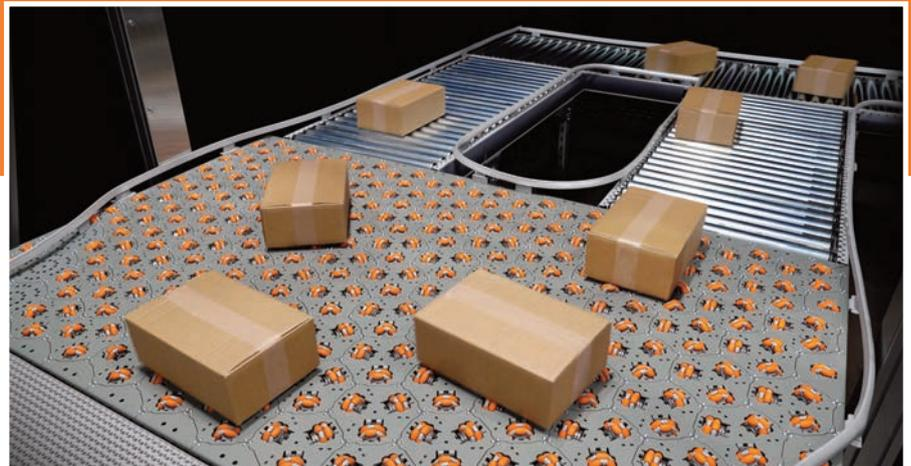
einem hohen Durchsatz bei minimalem Platzbedarf. Die vereinzelt Objekte können zur anschließenden Weiterverarbeitung entsprechend der Kundenlogik auf bis zu drei Ausgänge verteilt werden.
