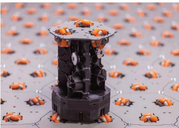
▲ Der Aufwand für einen Austausch ist minimal: In weniger als fünf Minuten wird die defekte Zelle entnommen und eine neue angeschlossen.
