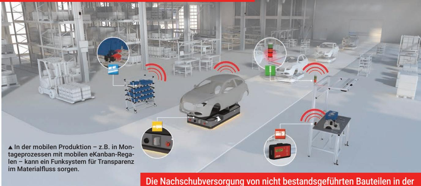
▲ In der mobilen Produktion – z.B. in Montageprozessen mit mobilen eKanban-Regalen – kann ein Funksystem für Transparenz im Materialfluss sorgen.
