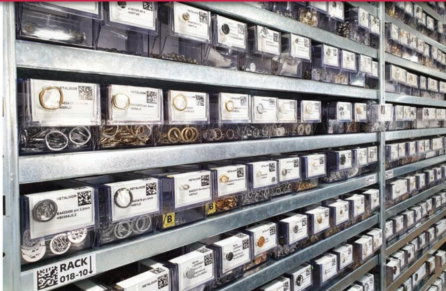
▲ Regale und Lagerbehälter sind mit DataMatrix Codes gekennzeichnet.
