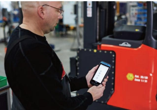
▲ Die EX-Monitoring-App von Linde Material Handling unterstützt Staplerfahrer und Flottenmanager dabei, ex-geschützte Fahrzeuge sicher und ausfallfrei zu betreiben, indem sie sicherheitsrelevante Werte und Fehler anzeigt und konkrete Handlungsempfehlungen gibt.
