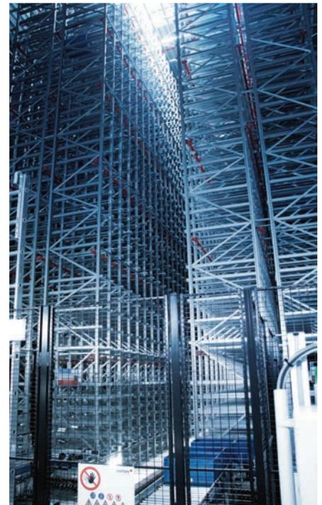
▲ Lager und Produktion sind über Fördertechnik verbunden, die zwei Kommissionierplätze, zwei KEP-Packplätze und zwei Nachschubplätze mit Material versorgt. Zudem sind Versorgungsbahnen für die interne Montage angeschlossen, ebenso Ein- und Auslagerstiche in der Fertigung positioniert.
