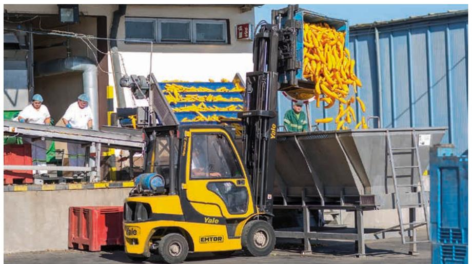
▲ Elektro stapler mit einer Tragfähigkeit von 1,6 t und Treibgasstapler mit einer höheren Tragfähigkeit (1,8 bis 2,5 t) und einem Drehgerät ergänzen den Fuhrpark und werden für Aufgaben außerhalb des Lagers eingesetzt
