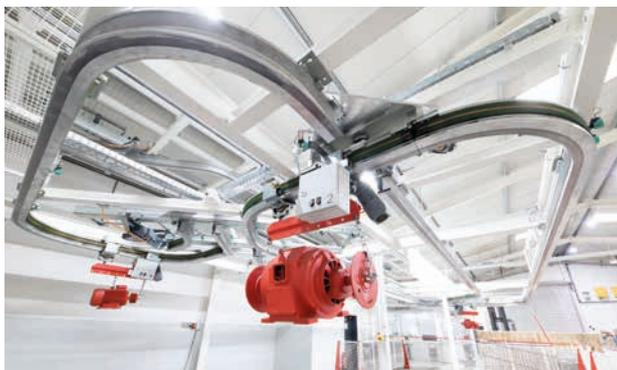
▲ Aufgrund einer speziellen Konstruktion sind die Aluminiumschienen von SKYRAIL leicht und dabei trotzdem hochstabil (Foto: SEH Engineering)
