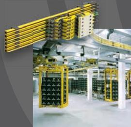
Schleifleitungssysteme für Elektrohängebahnen
