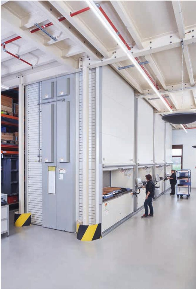
▲ An jeder der insgesamt 12 Entnahmestellen steht SAP mittels SOAP-Protokoll direkt an der Hänel-Steuerung MP 12 N-HostWeb zur Verfügung (Fotos: Hänel)
