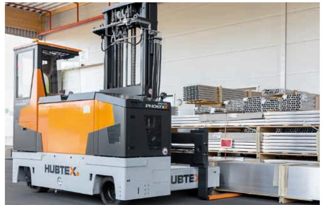
und die Regalfachpositionierung noch besser miteinander verknüpfen zu können. Darüber hinaus entwickelt Hubtex derzeit den PhoeniX AGV, einen vollautomatisierten Elektro-Mehrwege-Seitenstapler. Das Fahrzeug ist vor allem geeignet für den Langguttransport in der Holz-, Metall- und Kunststoffindustrie und ermöglicht die perfekte Integration in bestehende Lagerkonzepte. (Foto: Hubtex) ► [www.hubtex.com](http://www.hubtex.com)
