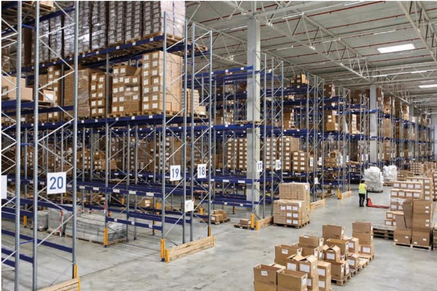
◀ 16 954 Palettenstellplätze für einen Großkunden der Textilbranche: Logistikdienstleister Vetten nutzt für sein neues Lager das AR-PAL-System von AR Racking. Das Besondere daran: Der Regalbau entspricht der Erdbebennorm für die „Zone 2 – sehr gefährlich, stärkste Beben möglich“ (Foto: AR Racking)
