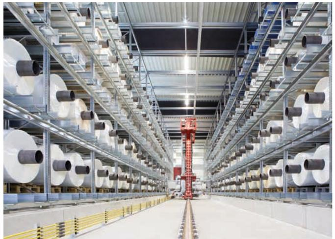
Falls Regalbediengeräte alleine nicht die gewünschte Leistung erbringen oder redundante Systeme im Zwischenlager vorzusehen sind, werden in der Regel sowohl die Horizontal- als auch Vertikalachse des Lagersystems durch Quertransportwagen und Senkrechtförderer abgebildet. Dieses geht zu Lasten der Lagerkapazität, bedeutet aber mehr Sicherheit, wenn es um die Verfügbarkeit des Gesamtsystems geht. (Foto: Westfalia)
