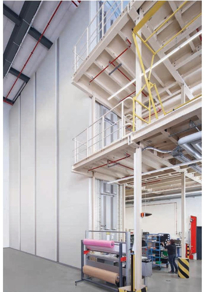
▲ Die 13 m hohen Hänel Lean-Lifte verbinden den Wareneingang direkt mit der Produktion
