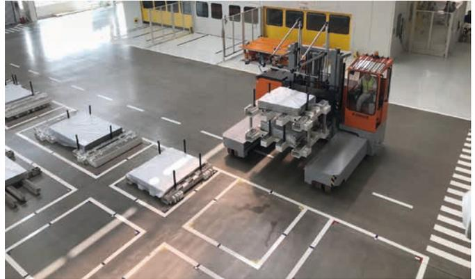
▲ Der Stapler mit kurzem Gabelträger ist erste Wahl, wenn es darum geht, kompakte Waren millimetergenau durch das Lager zu manövrieren (Foto: DIMOS)
